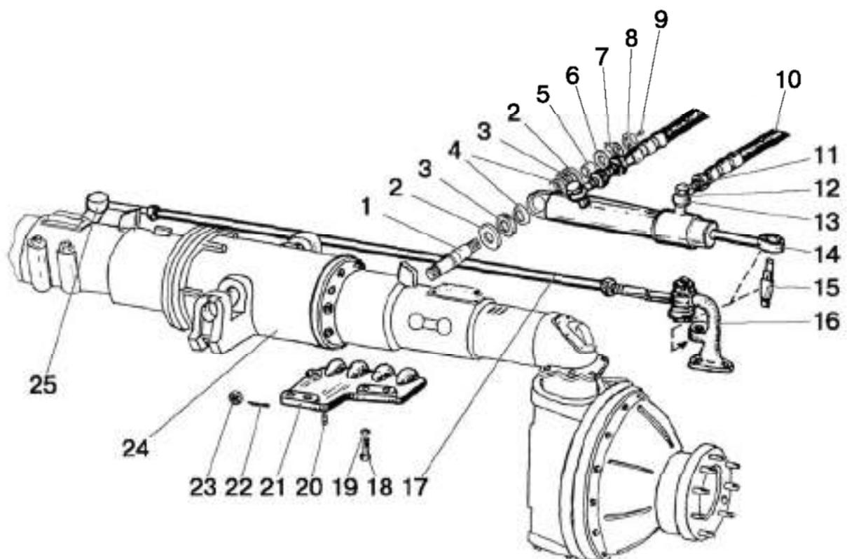
Рис. 34.5. Гидроцилиндр и арматура ГОРУ (ПВМ 72-2300020-А-04)
