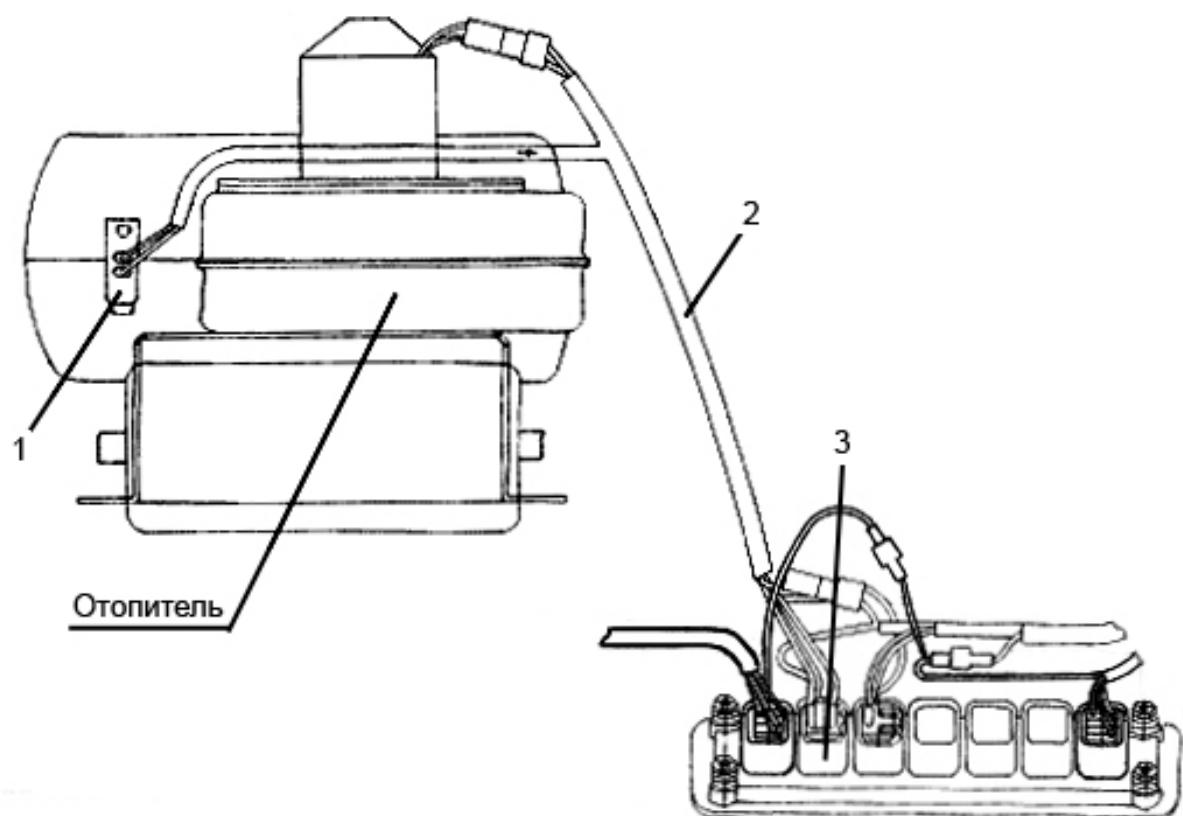
Рис. 37.19. Электрооборудование отопителя
