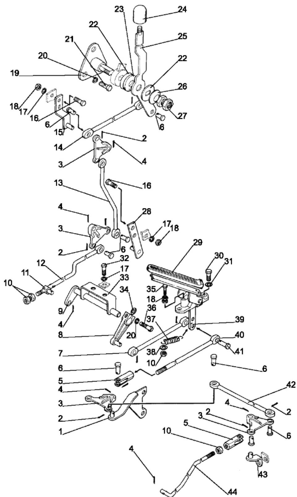
Рис. 11.10. Управление подачей топлива
