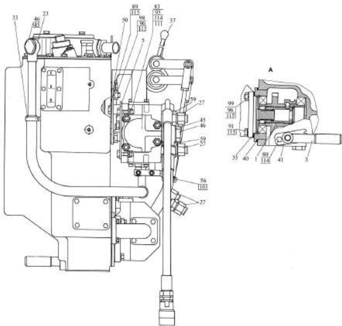
Рис. 46.7. Корпус гидросистемы
