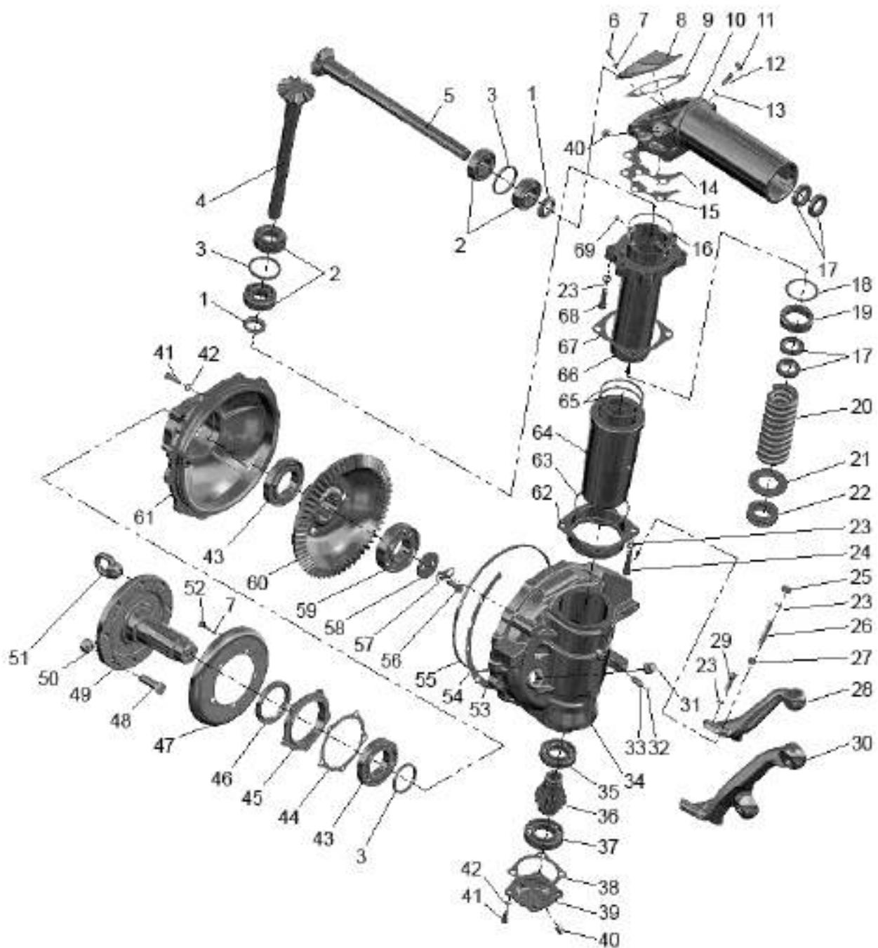
Рис. 23.5. Редуктор конечной передачи ПВМ
