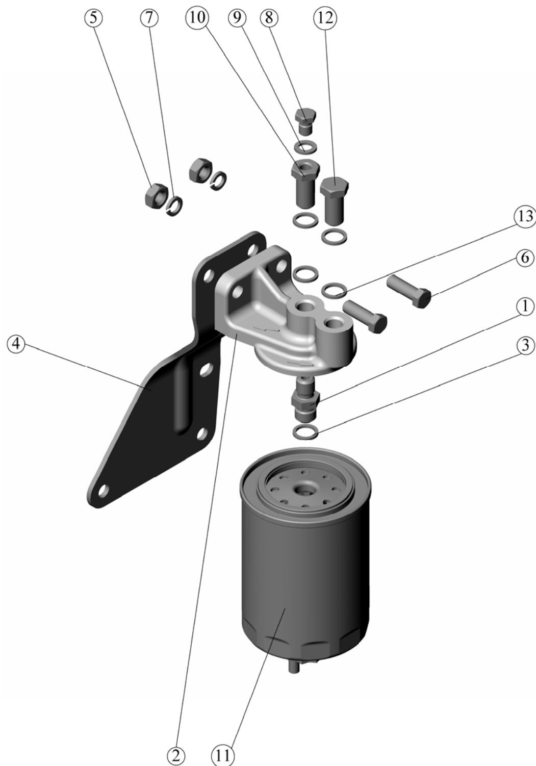
Рис. 11.9. Фильтр топливный тонкой очистки
