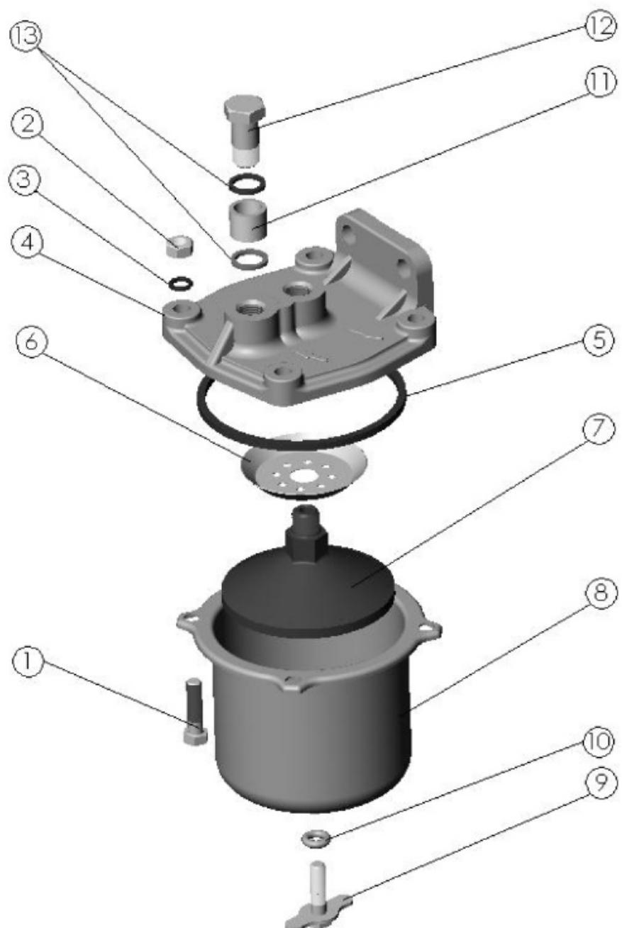
Рис. 11.8. Фильтр топливный грубой очистки
