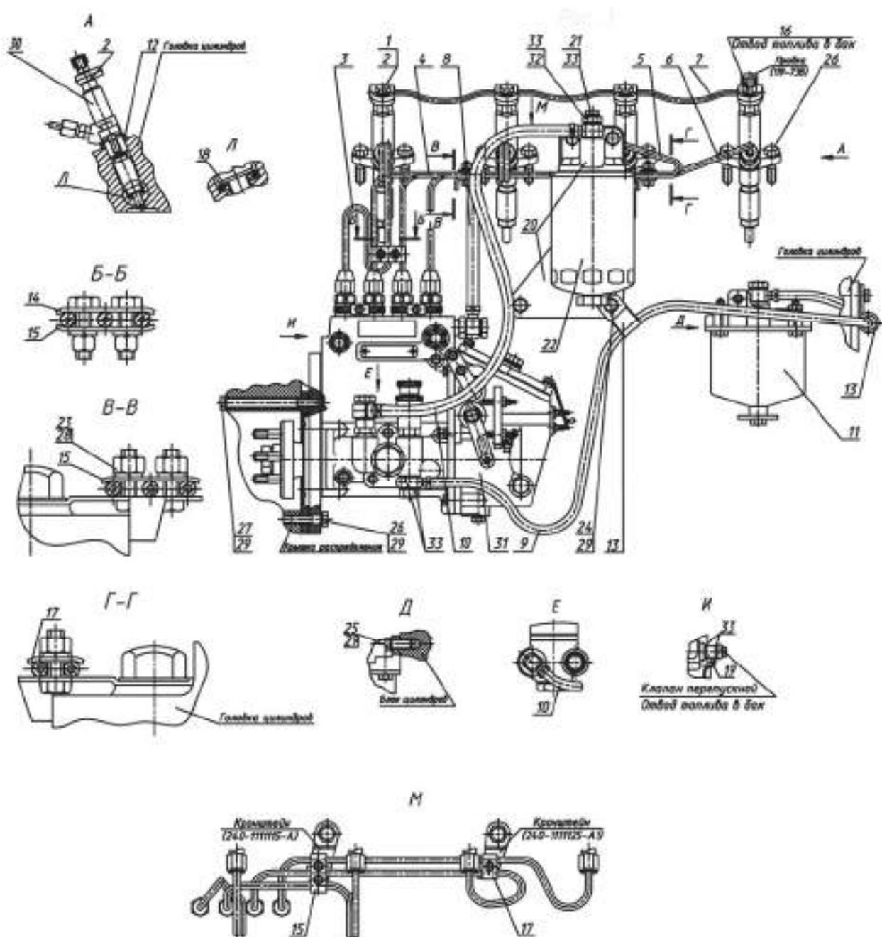
Рис. 11.4. Установка топливной аппаратуры (для двигателя Д-243)
