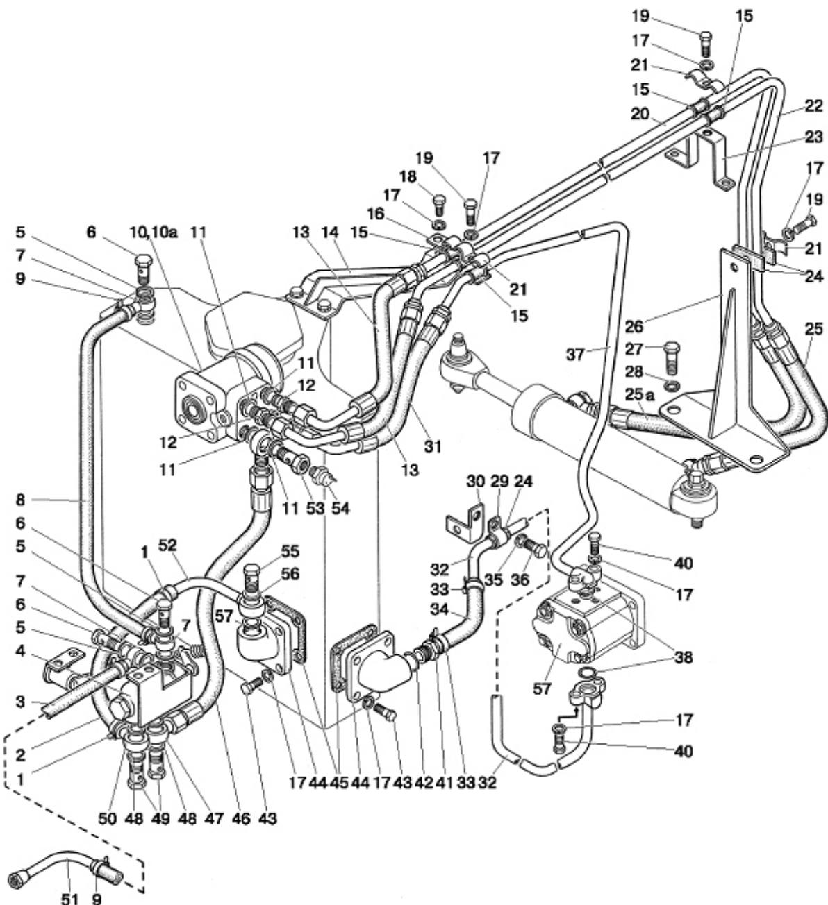
Рис. 34.2. Арматура рулевого управления
