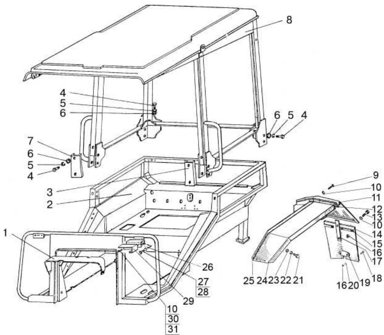
Рис. 67.2. Тент-каркас. Основание
