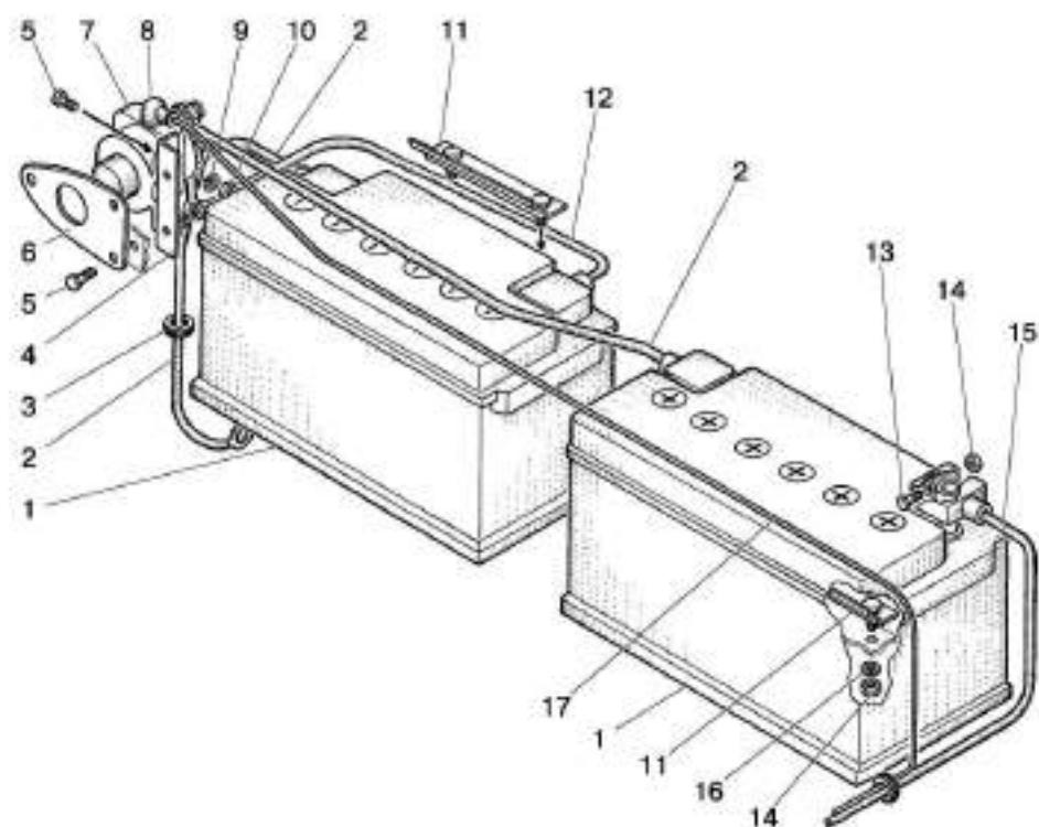
Рис. 37.5. Батареи аккумуляторные. Установка батарей аккумуляторных с системой запуска 24В. (Кроме трактора «БЕЛАРУС-82П»)
