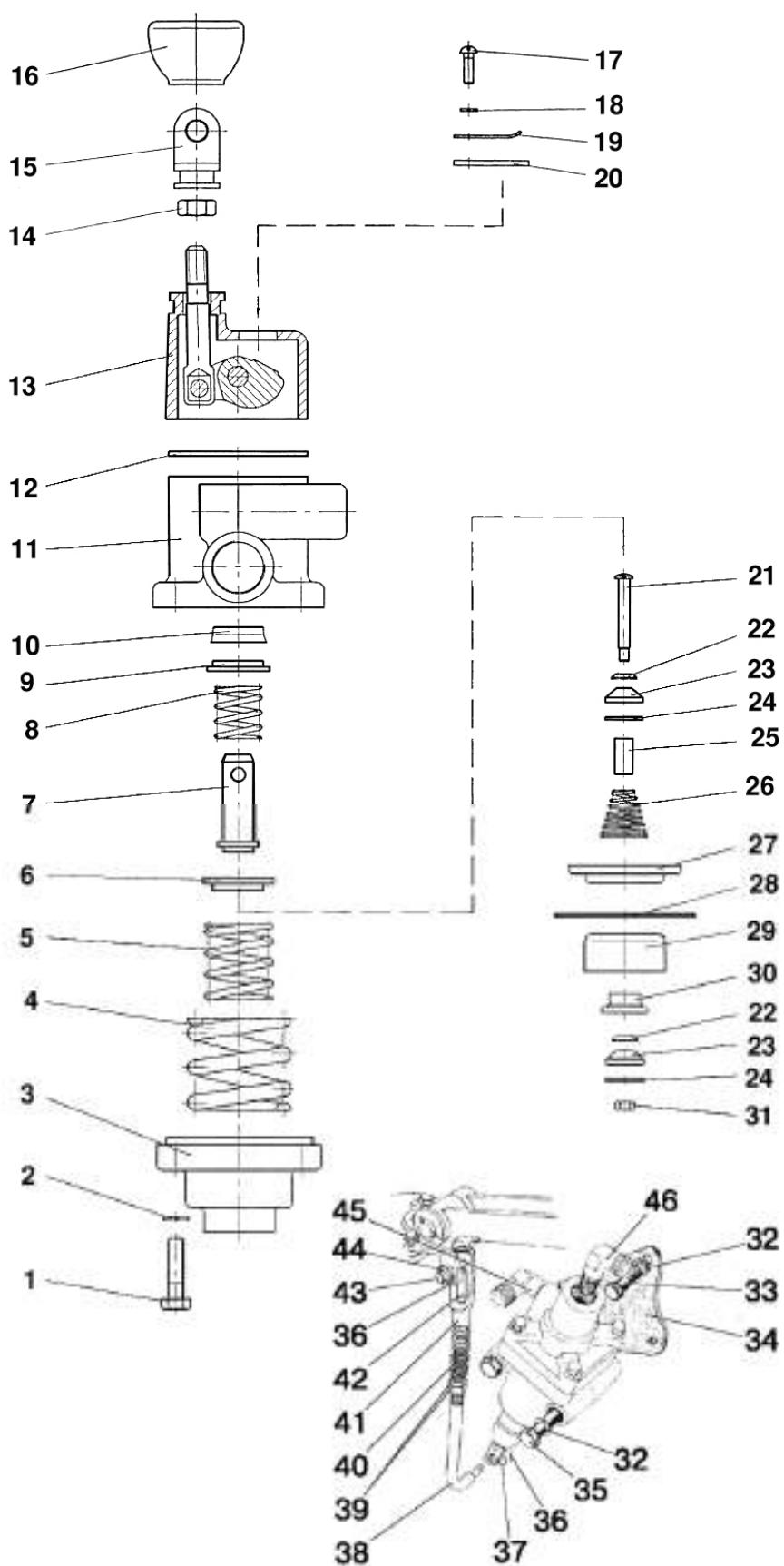
Рис. 35.8. Кран тормозной (для двухпроводного пневмопривода)
