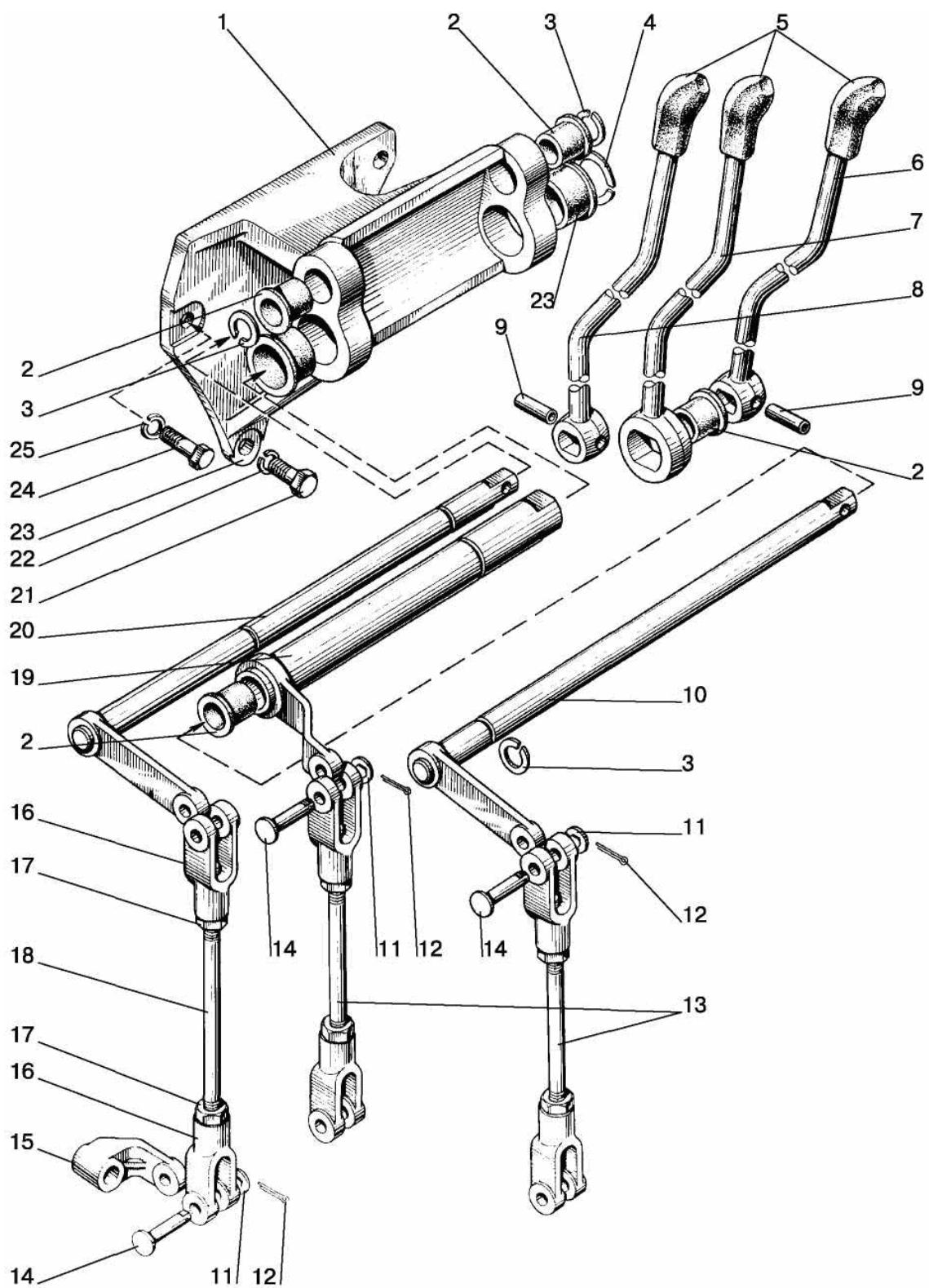
Рис. 46.21. Управление гидрораспределителем Р80
