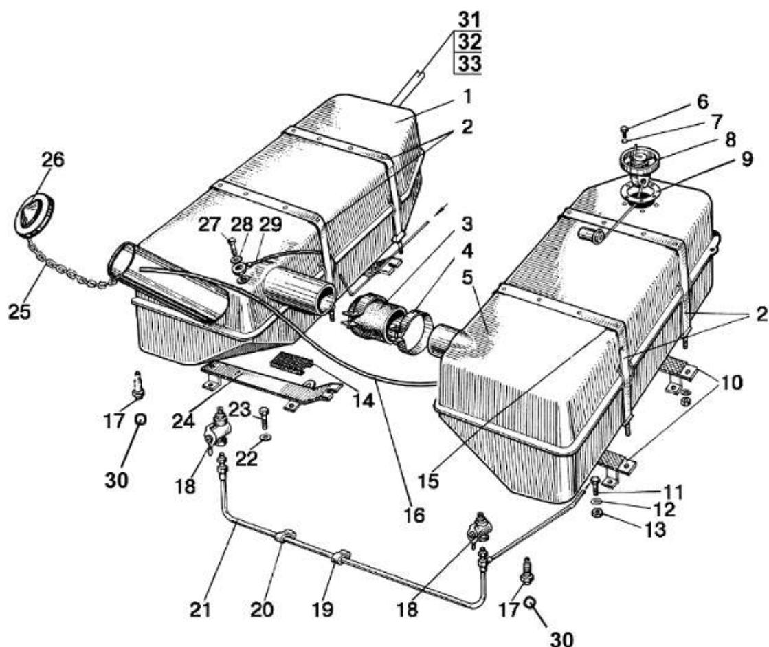
Рис. 11.1. Баки топливные (металлические)
