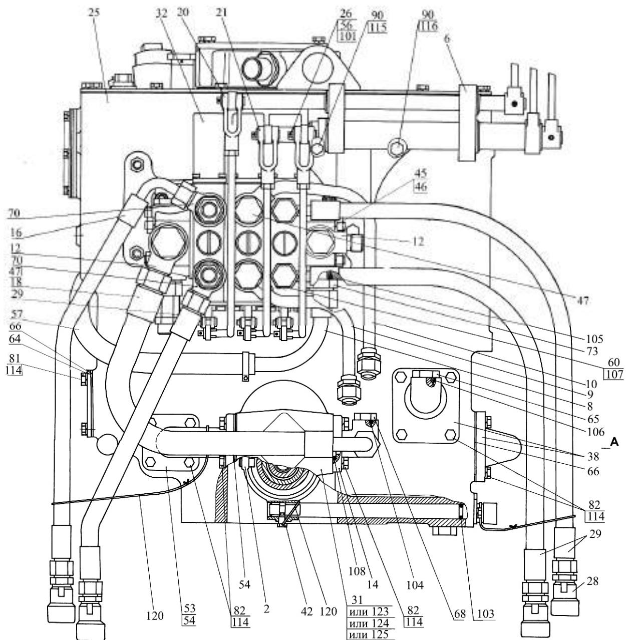
Рис. 46.6. Корпус гидросистемы
