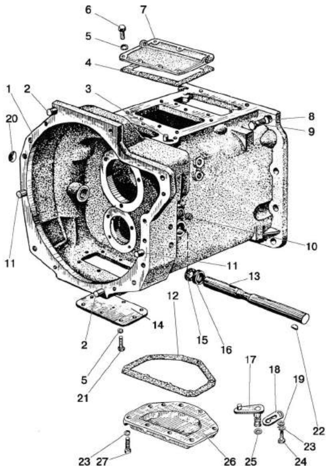
Рис. 16.2. Корпус сцепления
