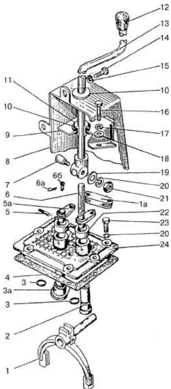
Рис. 17.9. Управление реверс-редуктором
