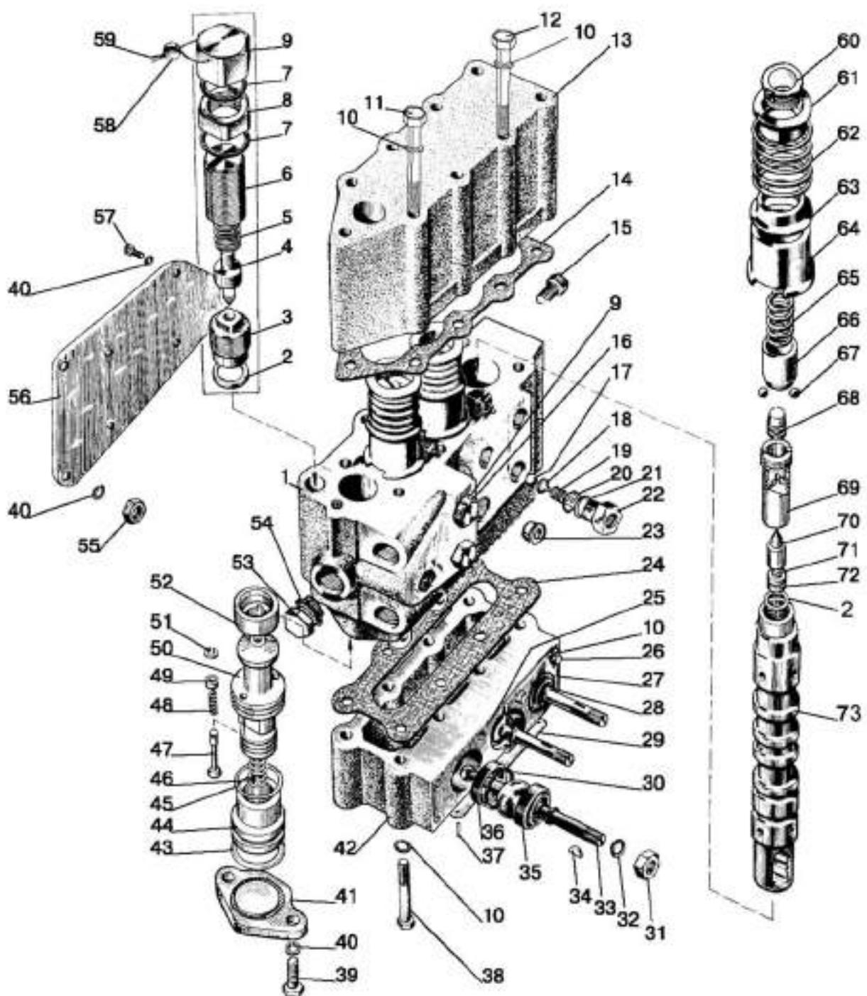
Рис. 46.19. Гидрораспределитель Р80
