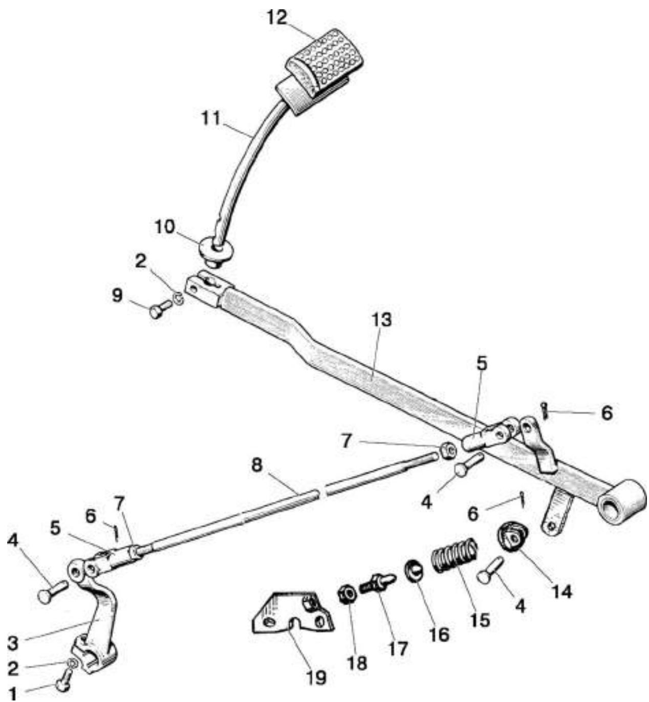
Рис. 16.7. Управление сцеплением
