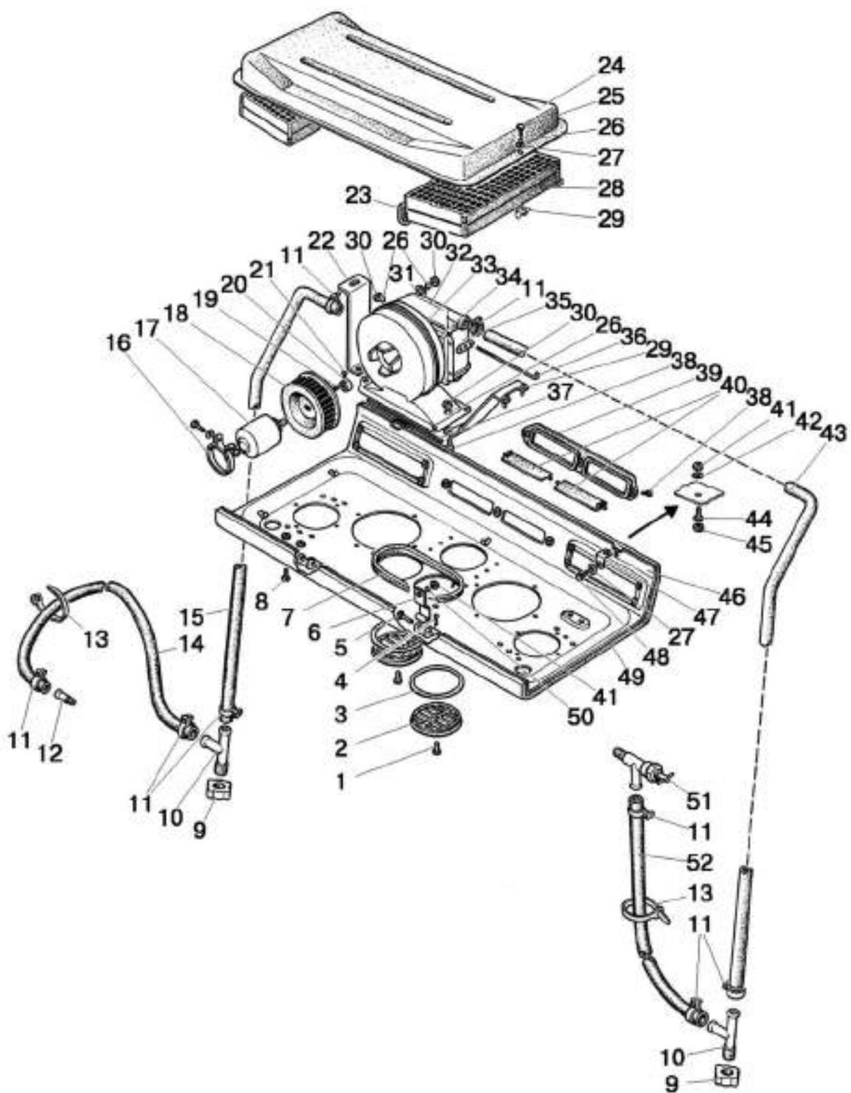
Рис. 81.1. Отопитель. Арматура отопителя
