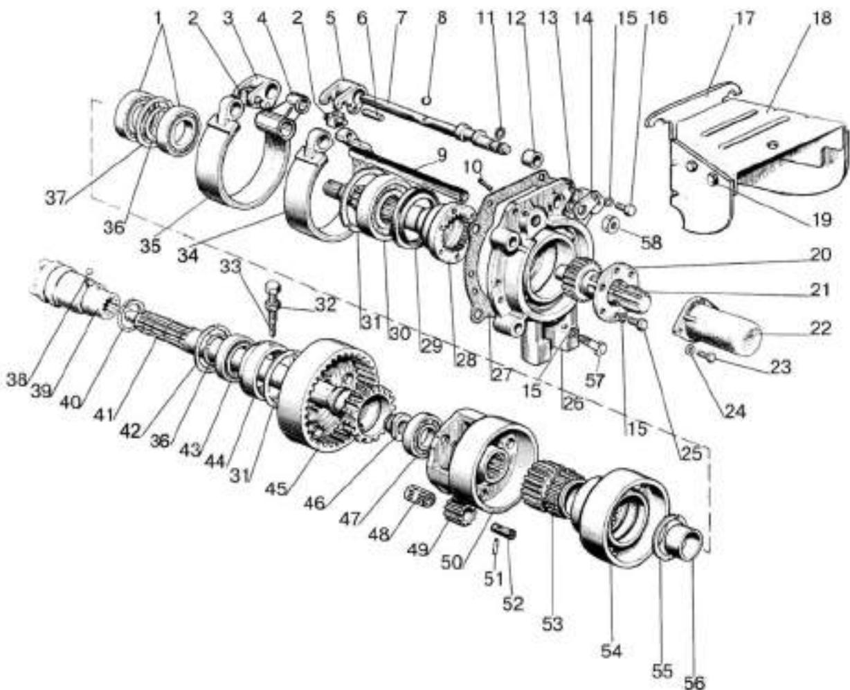
Рис. 42.1. Вал отбора мощности задний
