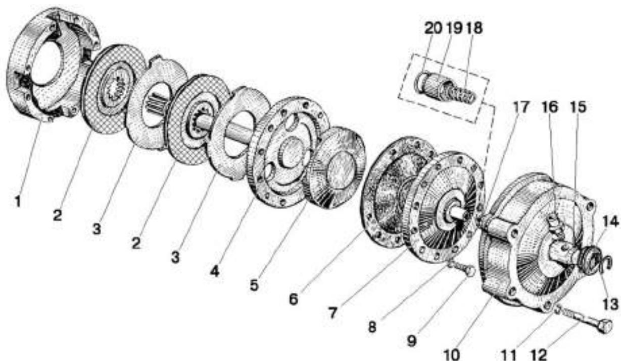
Рис. 24.3. Механизм блокировки дифференциала
