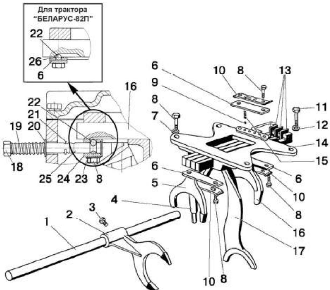
Рис. 17.6. Механизм переключения передач. Корпус вилок
