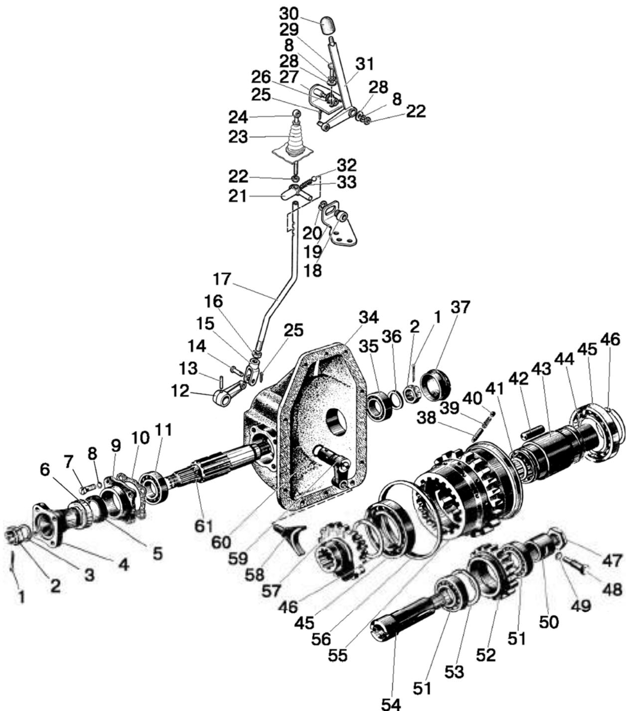
Рис. 18.1. Раздаточная коробка привода ПВМ
