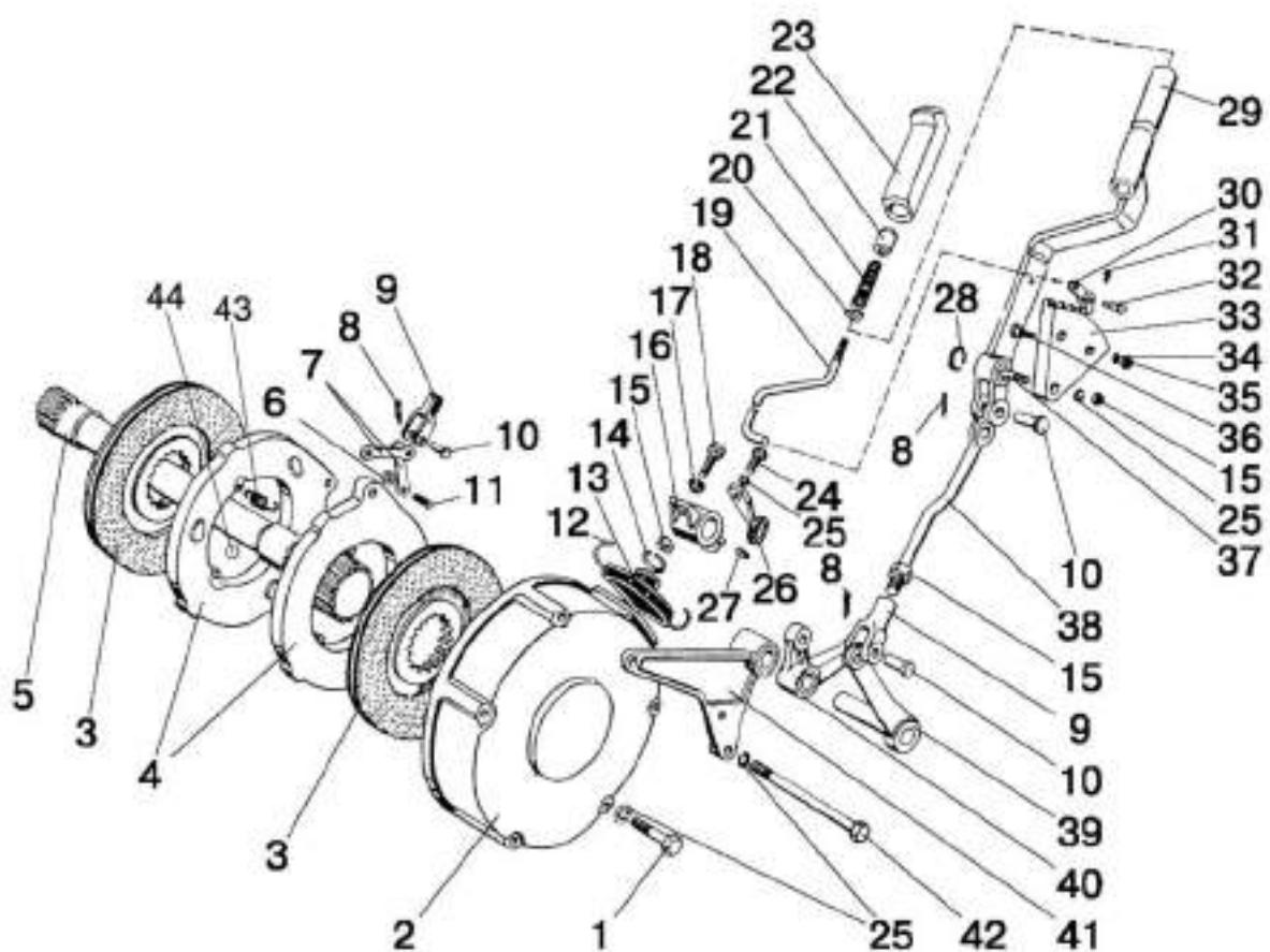
Рис. 35.2. Тормоз стояночный. Управление стояночным тормозом
