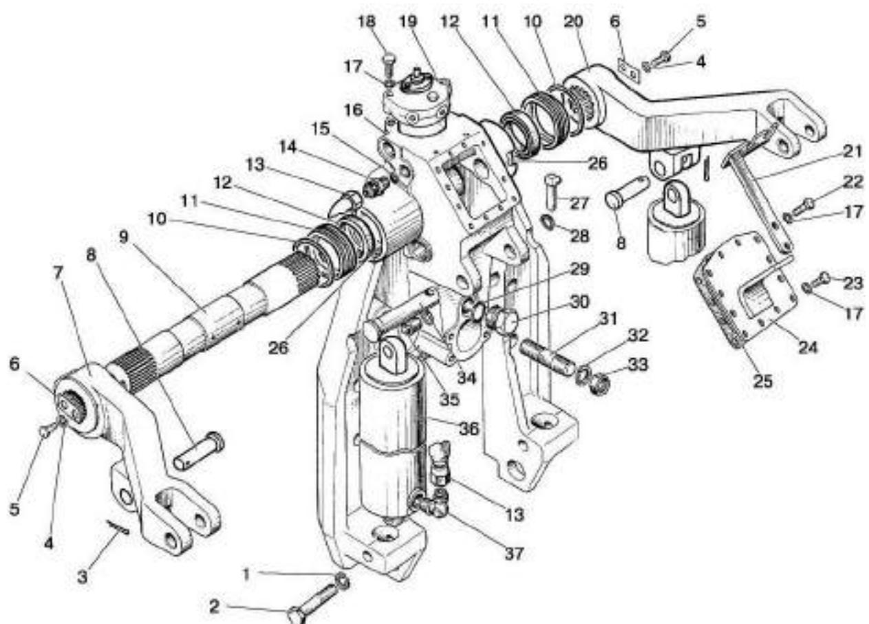
Рис. 46.29. Гидроподъемник
