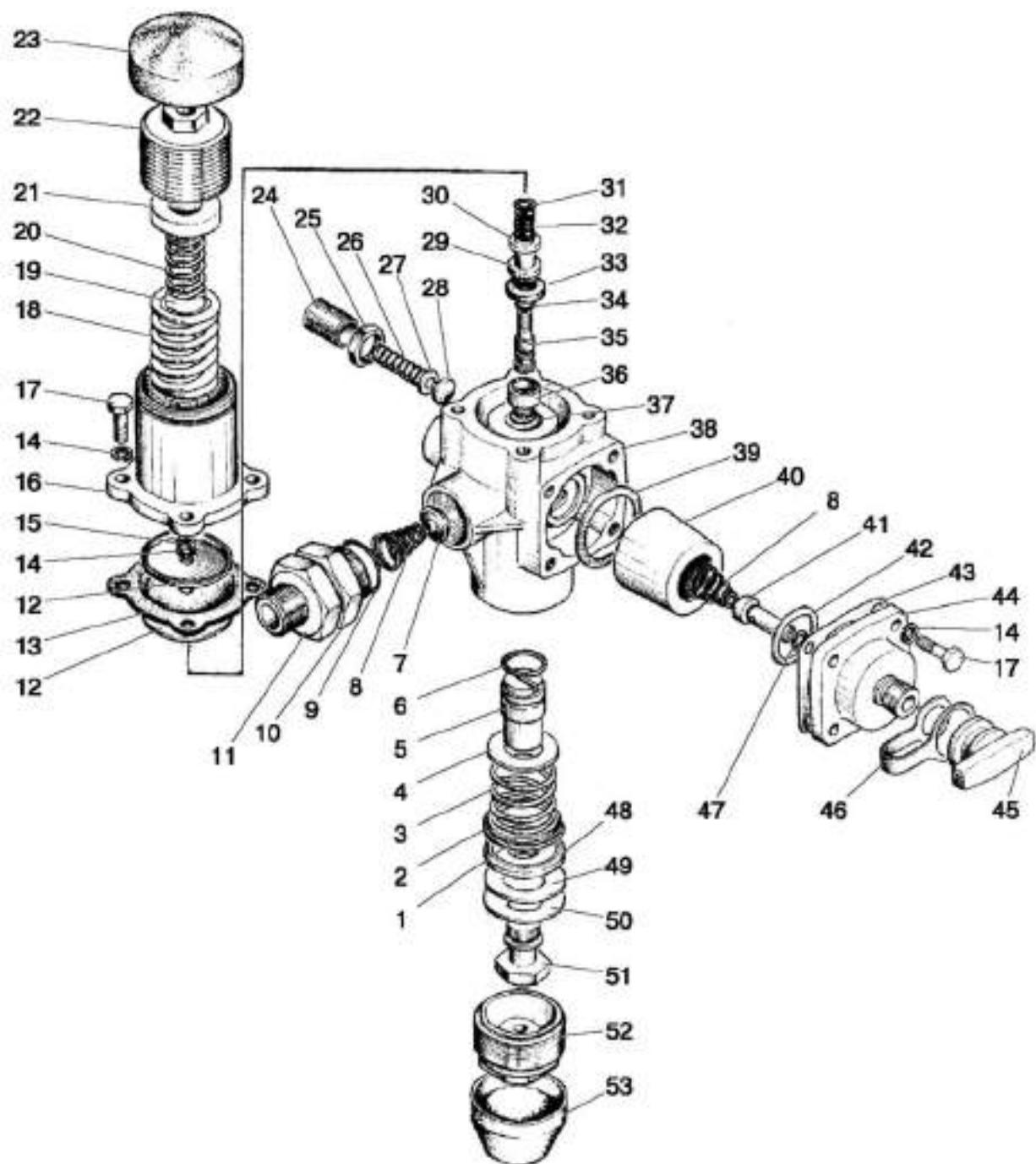
Рис. 35.5. Регулятор давления
