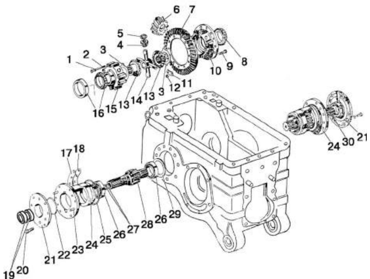
Рис. 24.2. Дифференциал. Стакан подшипников
