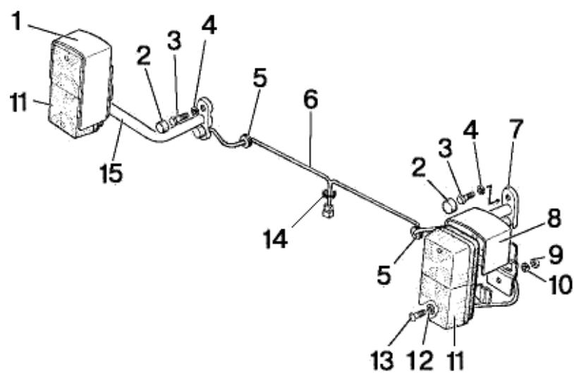
Рис. 37.12. Установка фонарей передних (кроме трактора «БЕЛАРУС-82П»)
