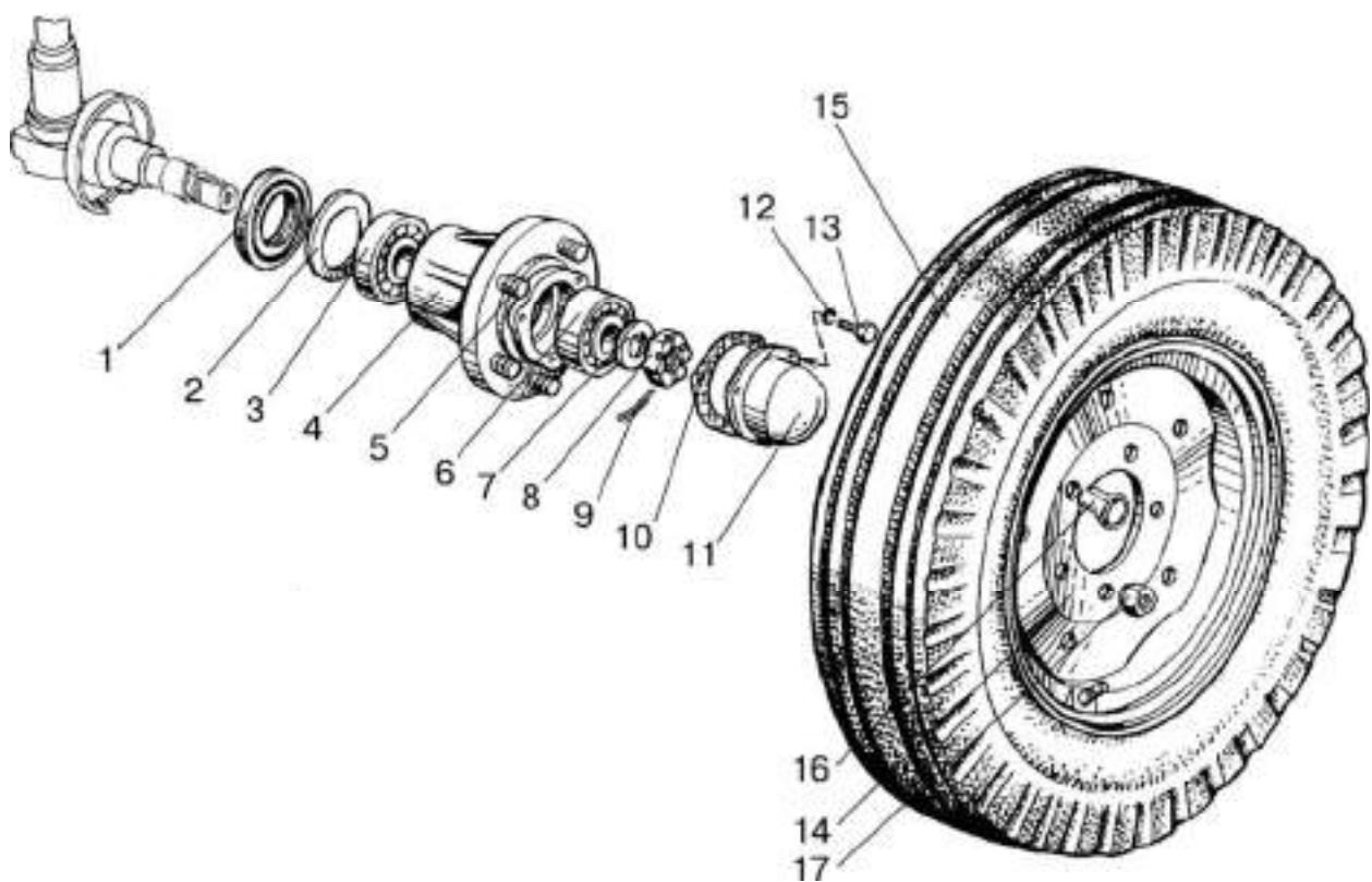
Рис. 31.1. Колеса передние направляющие. Ступицы передних колес.
