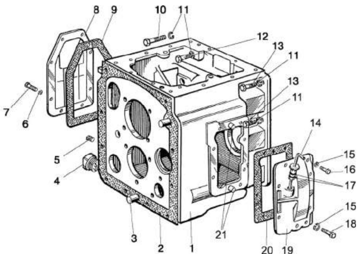
Рис. 17.1. Коробка передач. Корпус коробки передач
