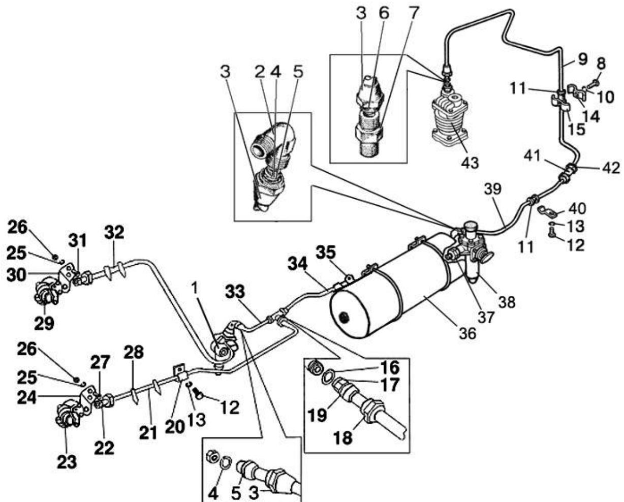
Рис. 35.4. Трубопроводы и арматура двухпроводного пневмопривода тормозов прицепа
