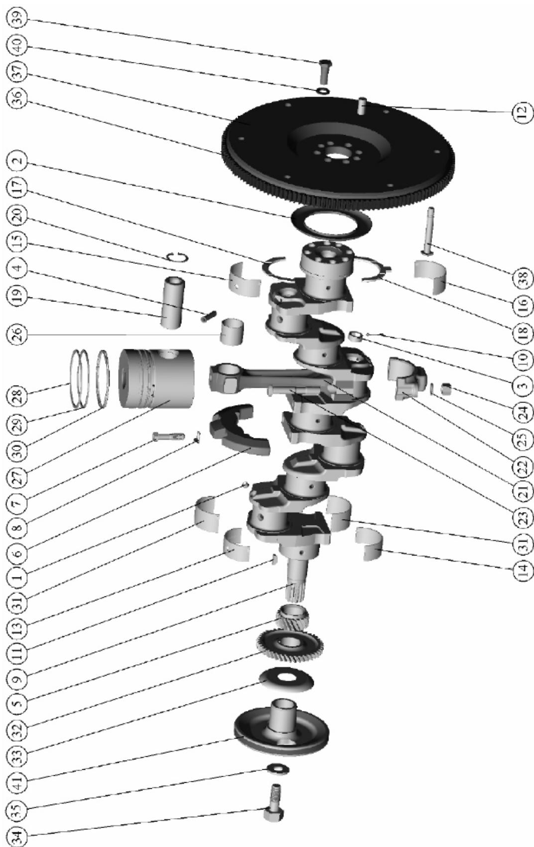
Рис. 10.3. Поршни и шатуны. Вал коленчатый и маховик
