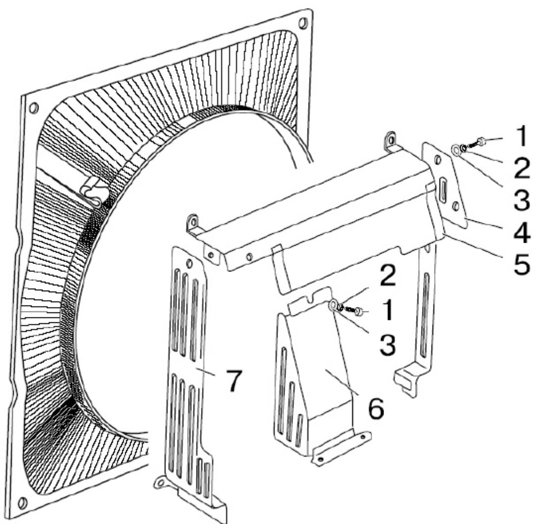
Рис. 13.4. Ограждение вентилятора (по заказу)
