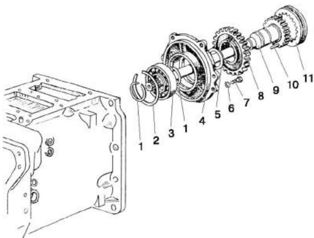
Рис. 16.5. Корпус сцепления (понижающий редуктор)
