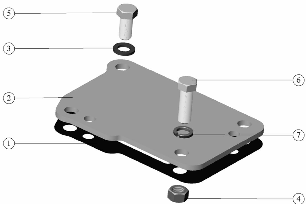
Рис. 35.12. Установка заглушки (для тракторов без пневмокомпрессора)
