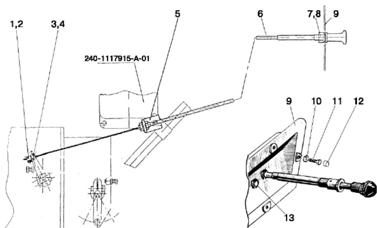
Рис. 11.11. Останов дизеля. Аварийный останов дизеля
