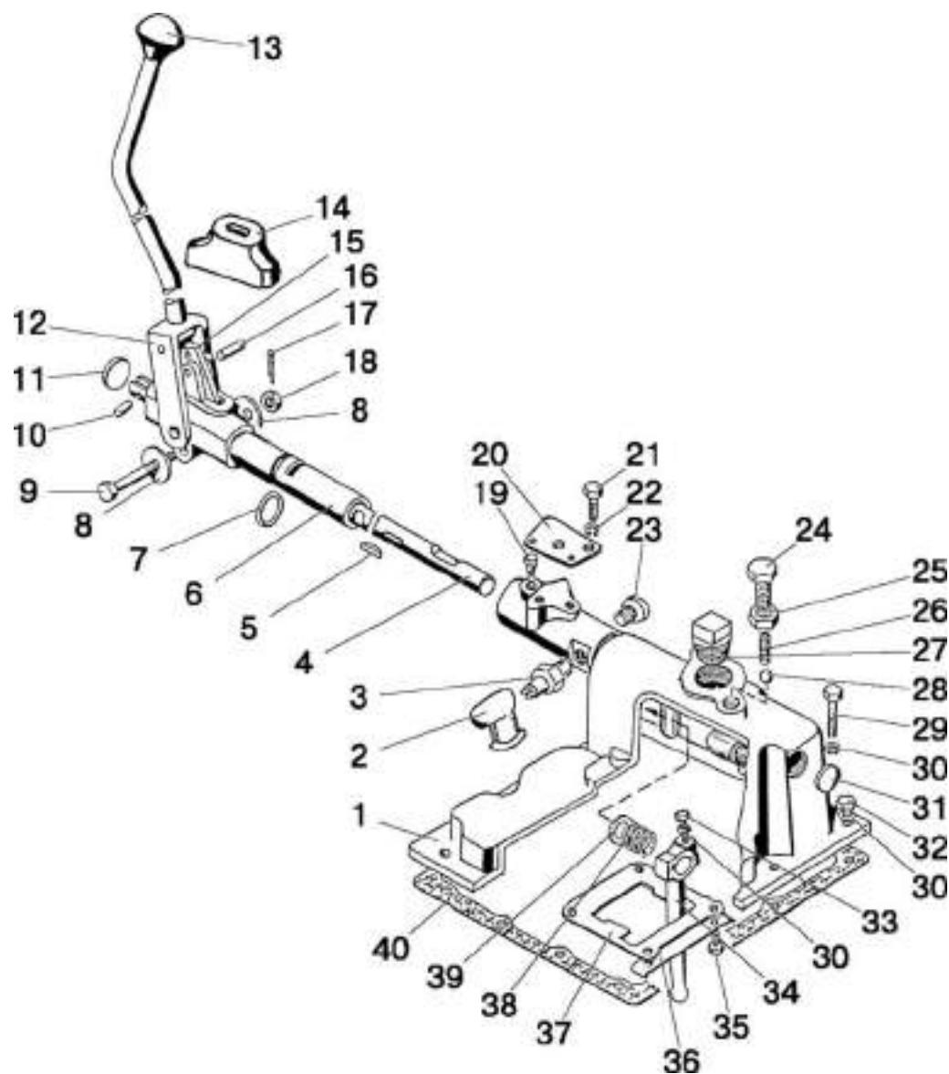
Рис. 17.7. Механизм переключения передач. Крышка
