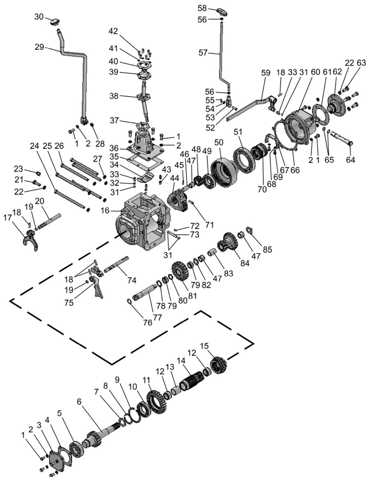
Рис. 17.10. Ходоуменьшитель механический
