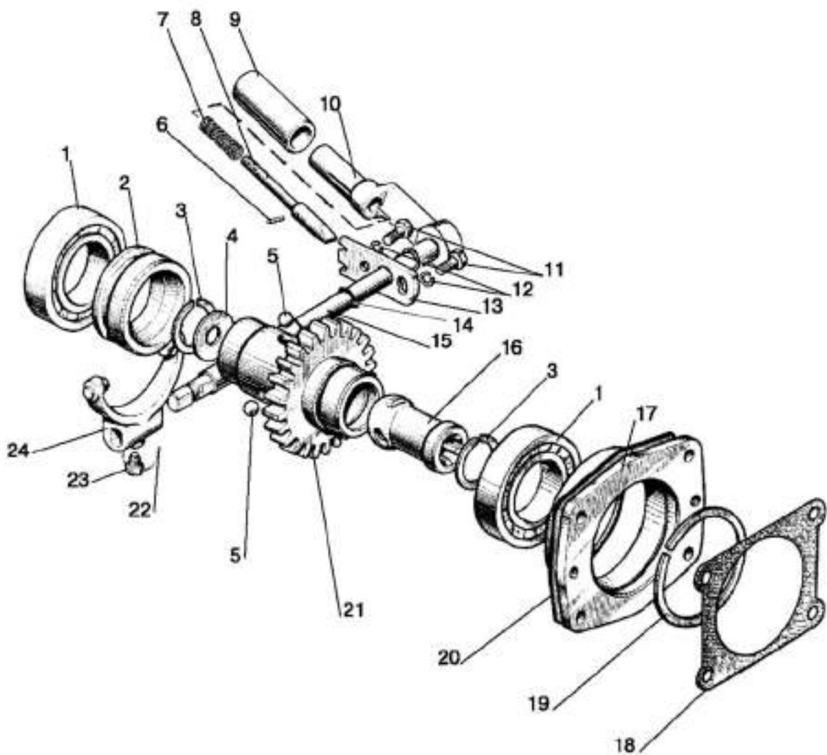
Рис. 46.14. Привод насоса
