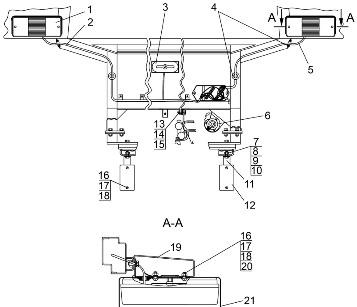
Рис. 37.17. Установка фонарей задних (кроме трактора «БЕЛАРУС-82П»)
