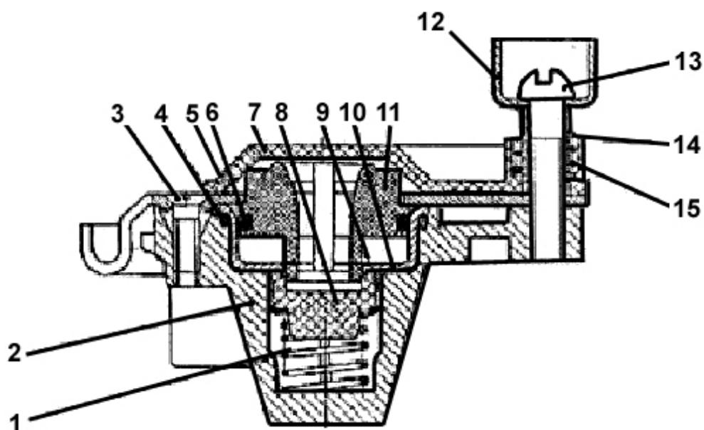
Рис. 35.10. Головка соединительная (для двухпроводного пневмопривода)
