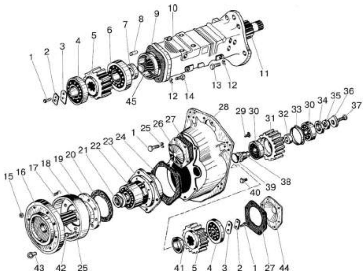
Рис. 24.4. Бортовой редуктор (для трактора «БЕЛАРУС-82Р»)
