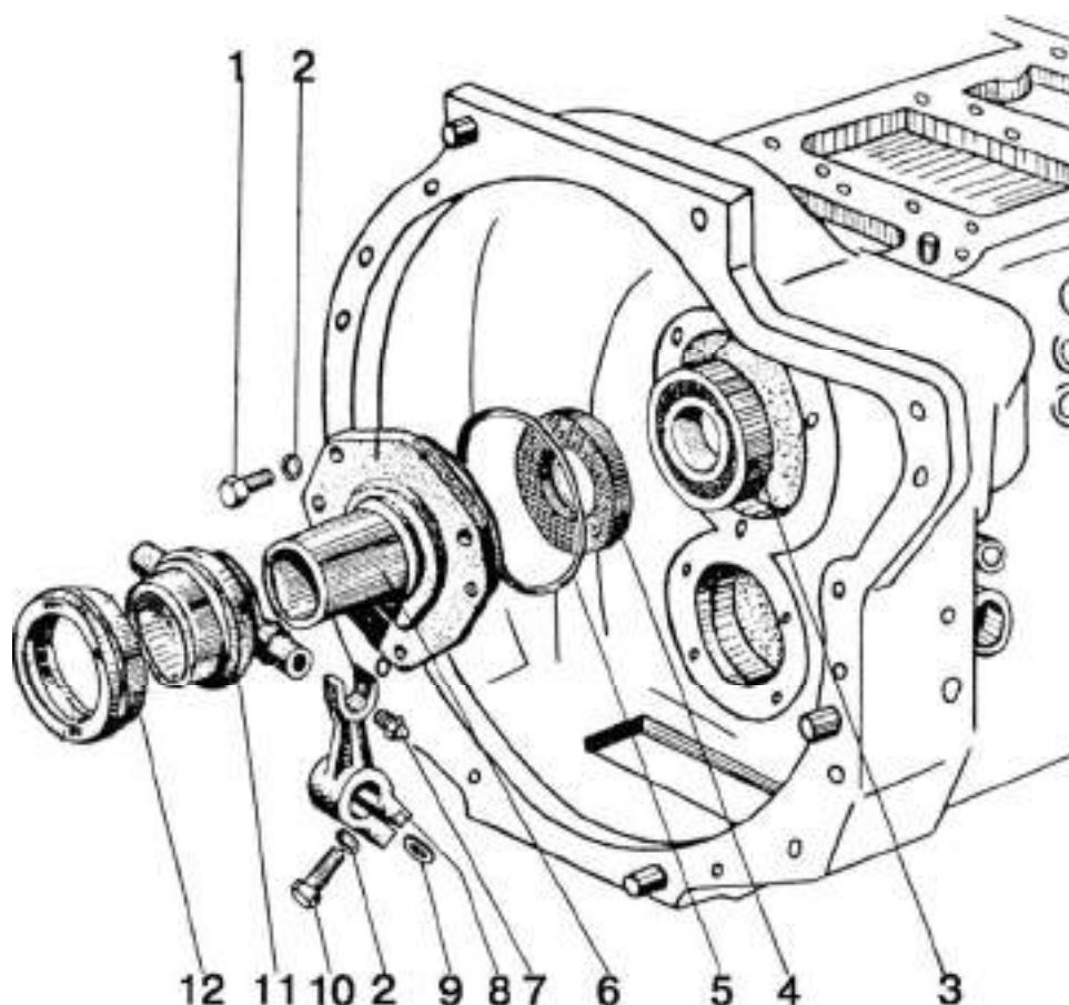
Рис. 16.3. Корпус сцепления (отводка)
