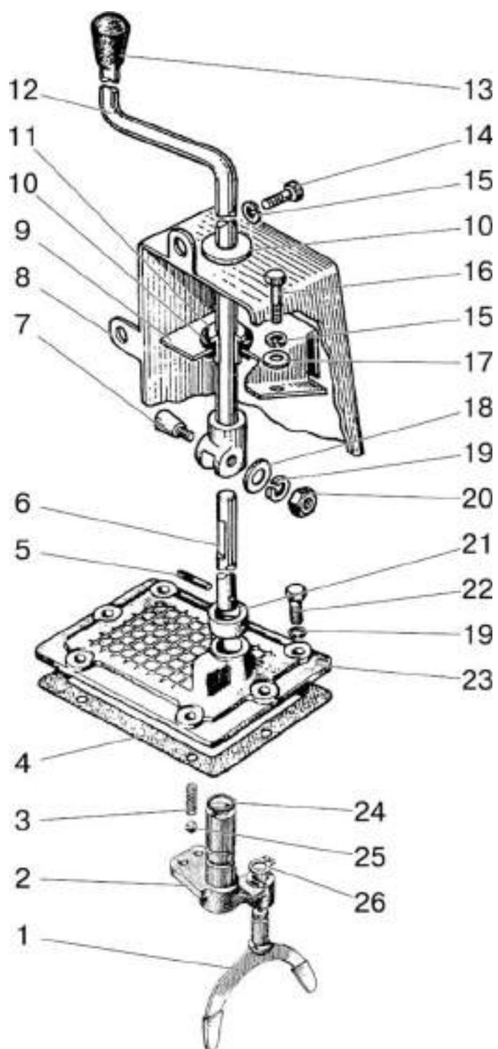
Рис. 17.8. Управление понижающим редуктором
