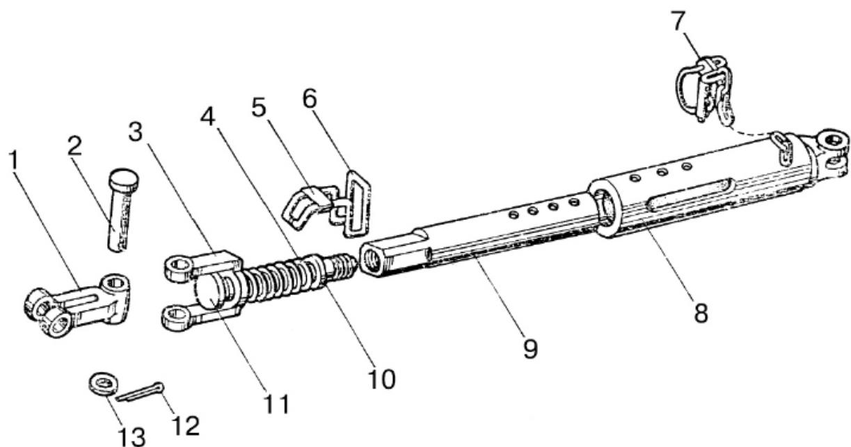
Рис. 46.16. Стяжка телескопическая
