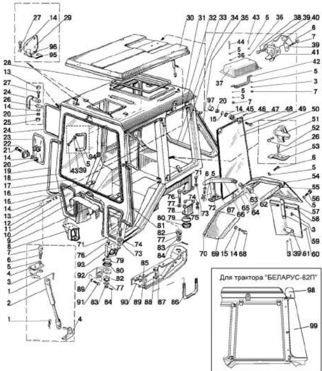
Рис. 67.1. Кабина трактора. Крылья задние
