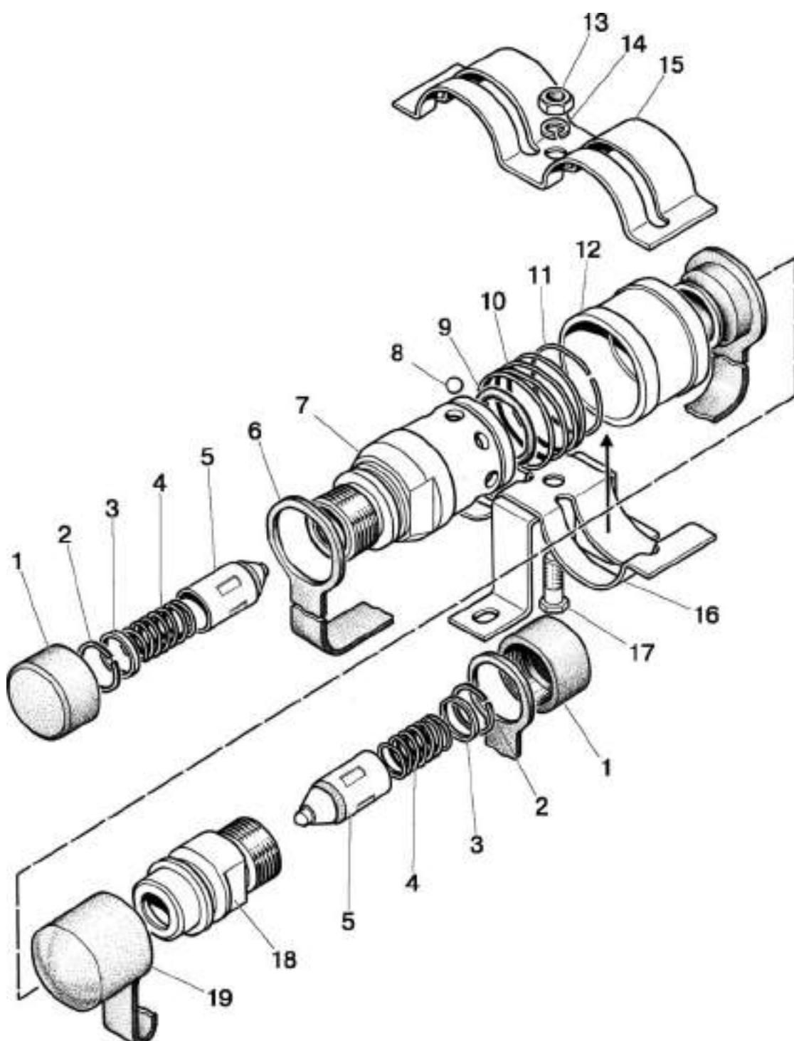
Рис. 46.24. Муфта разрывная
