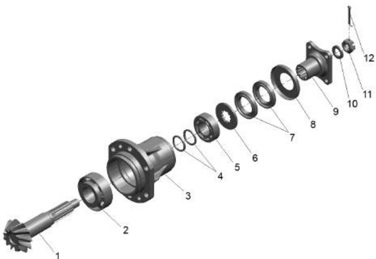
Рис. 23.3. Главная передача ПВМ
