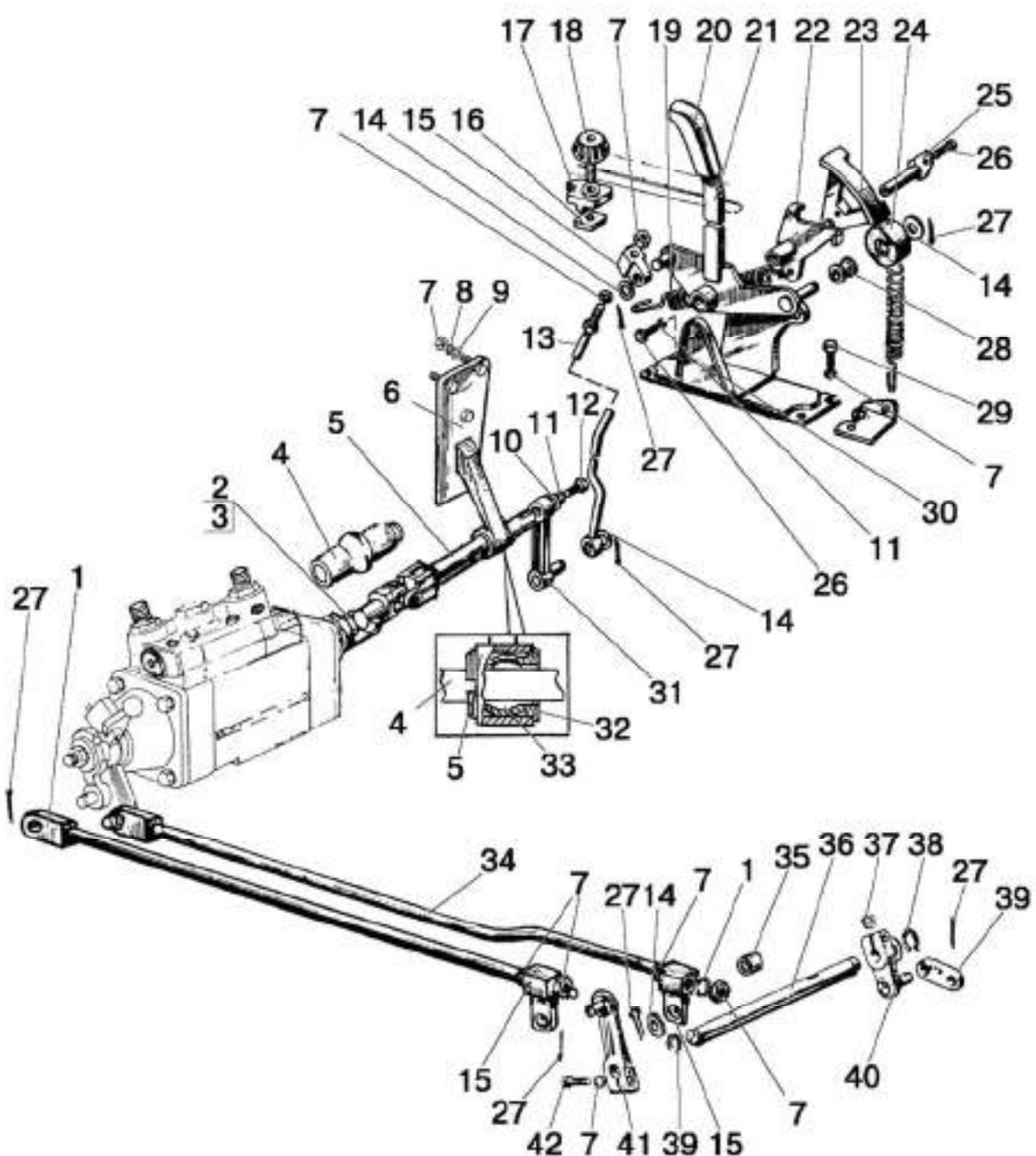
Рис. 46.23. Управление регулятором
