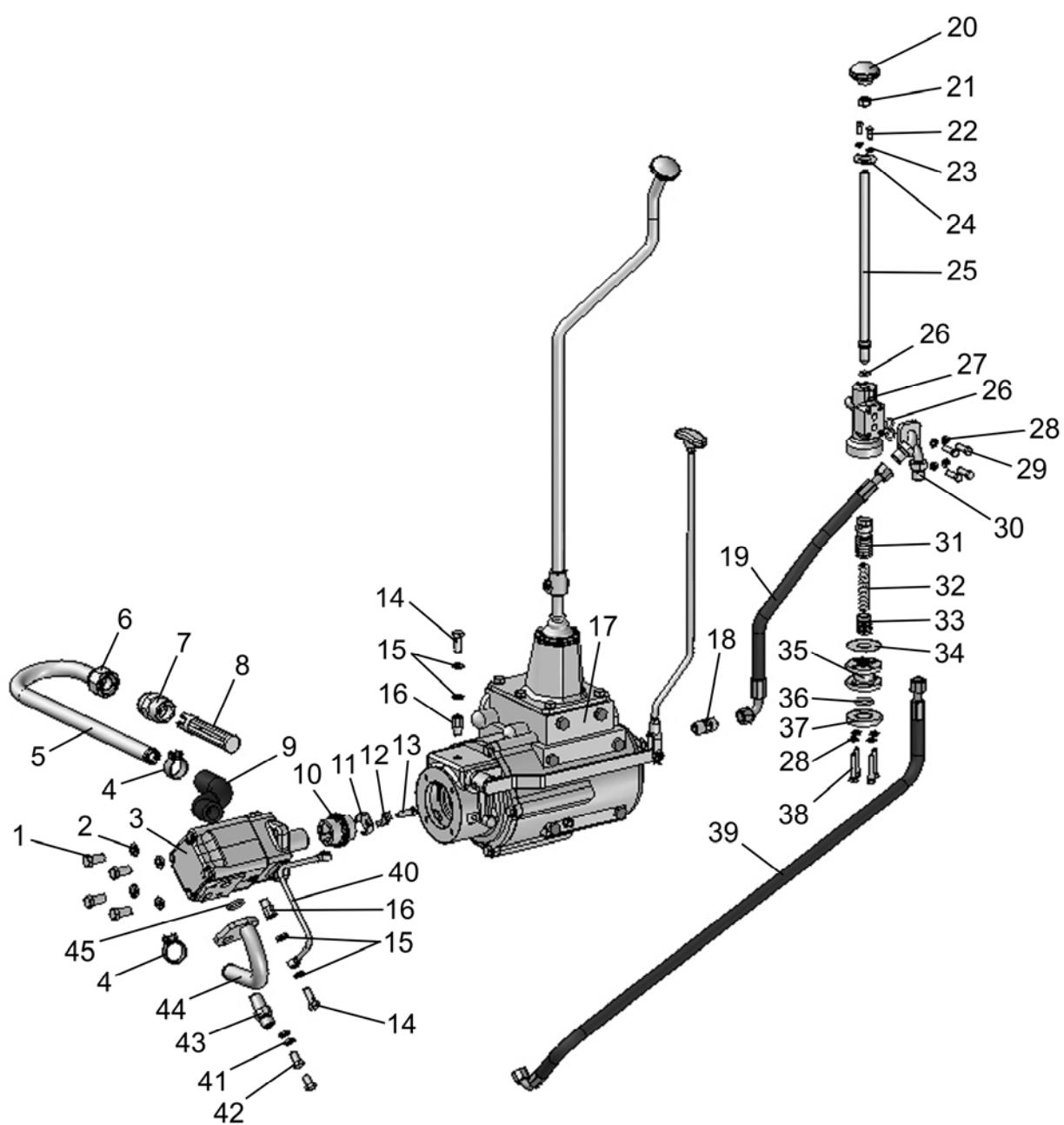
Рис. 17.11. Гидроходоуменьшитель
