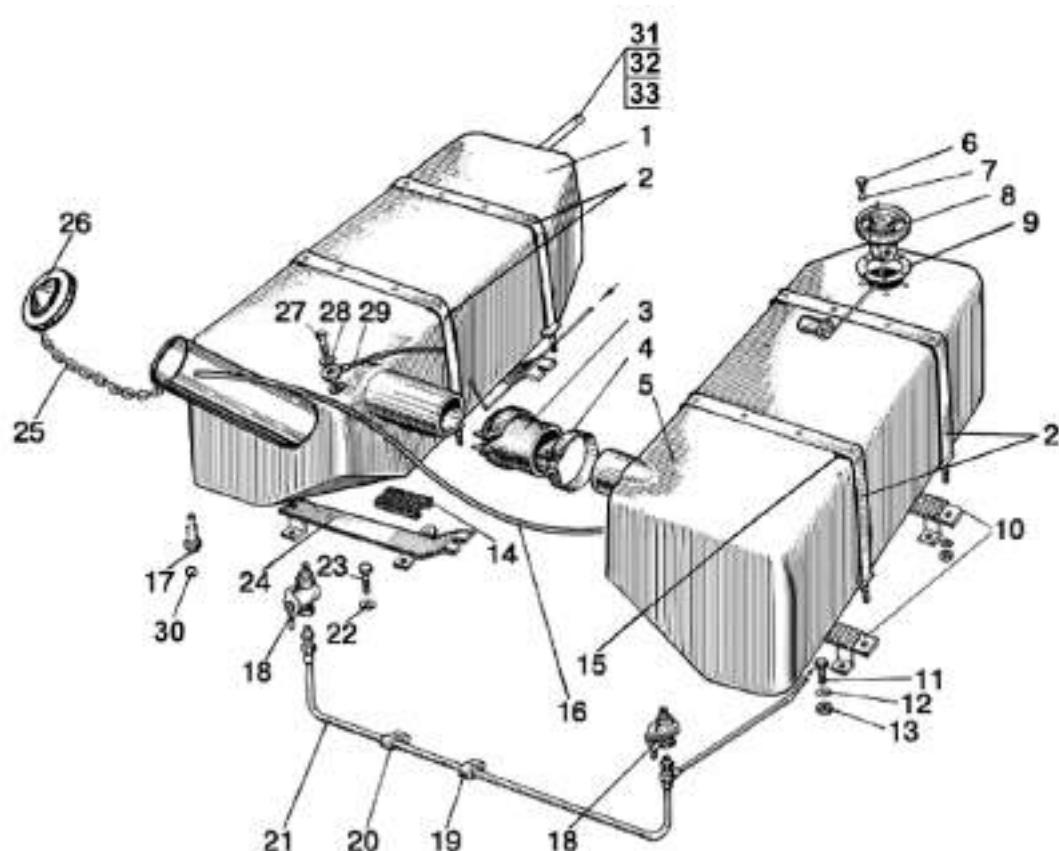
Рис. 11.2. Баки топливные (пластмассовые)
