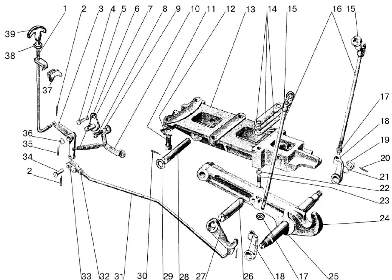
Рис. 28.2. Крюк прицепной гидрофицированный (по заказу, кроме трактора «БЕЛАРУС-82П»)
