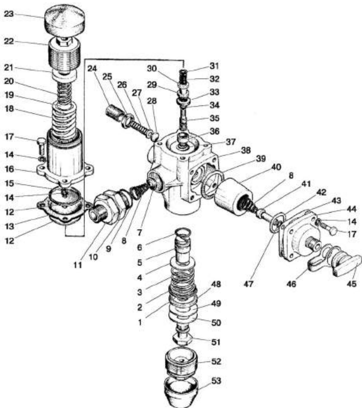
Рис. 35.5. Регулятор давления
