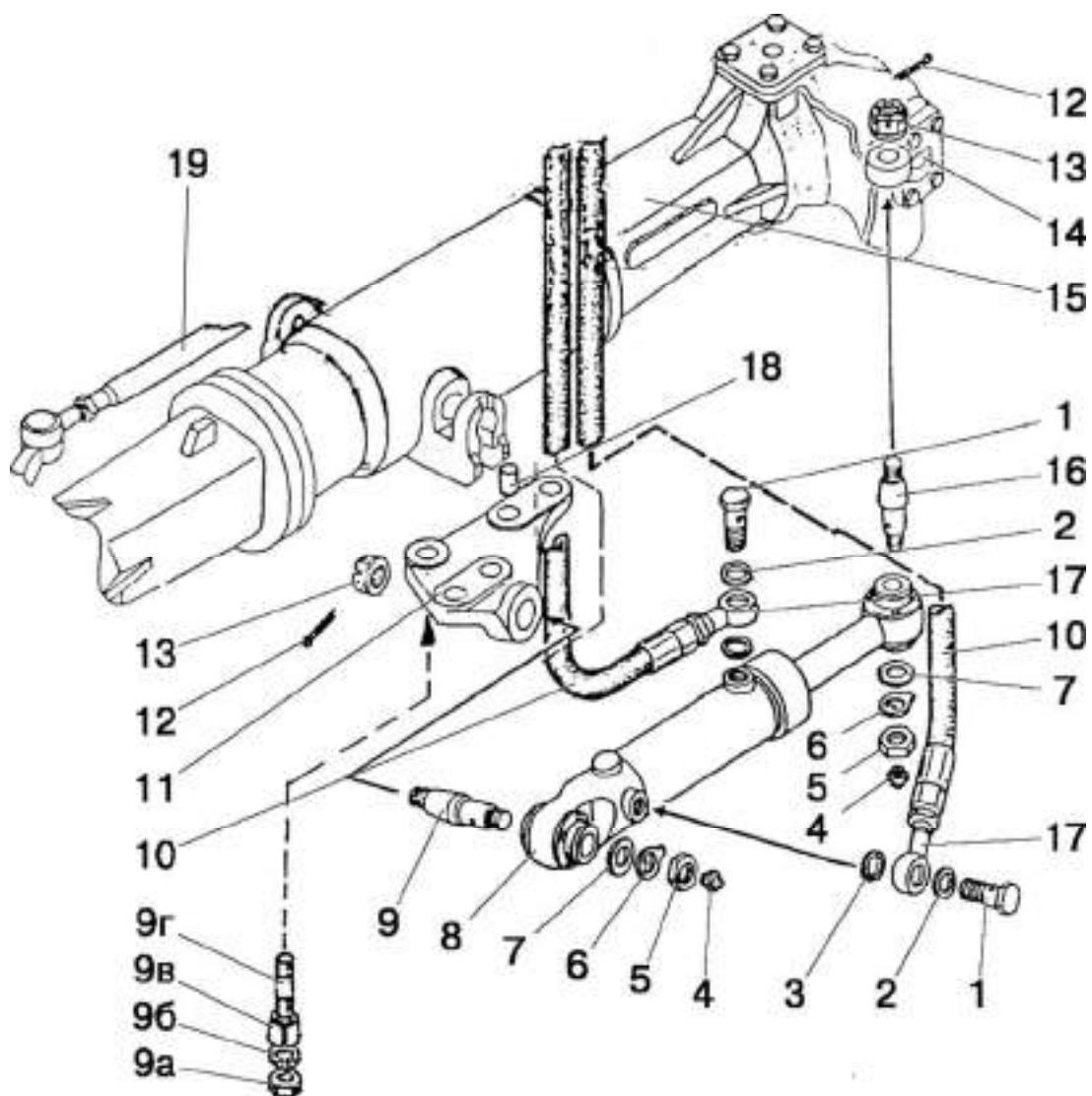
Рис. 34.7. Гидроцилиндр Ц63 и арматура ГОРУ (ПВМ 822-2300020-04 или ПВМ 822-2300020-02)
