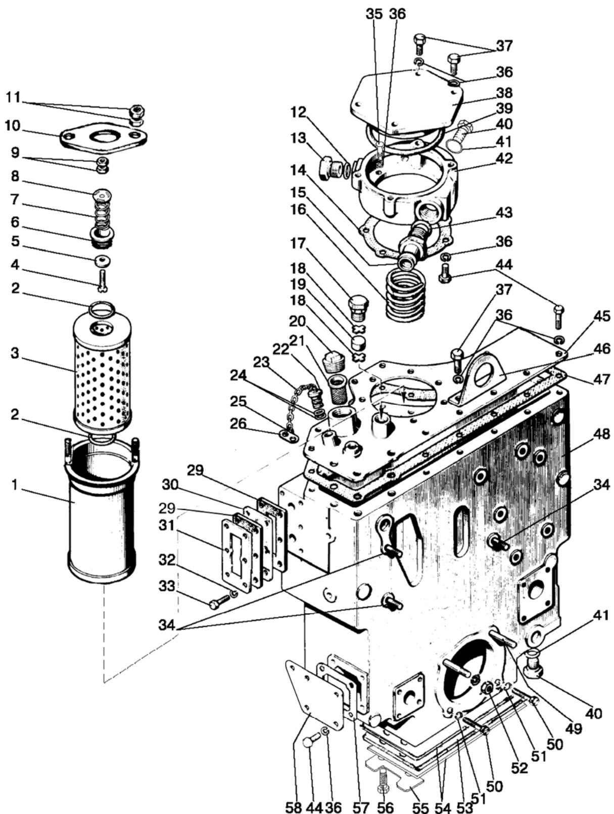
Рис. 46.12. Корпус гидроагрегатов и фильтр
