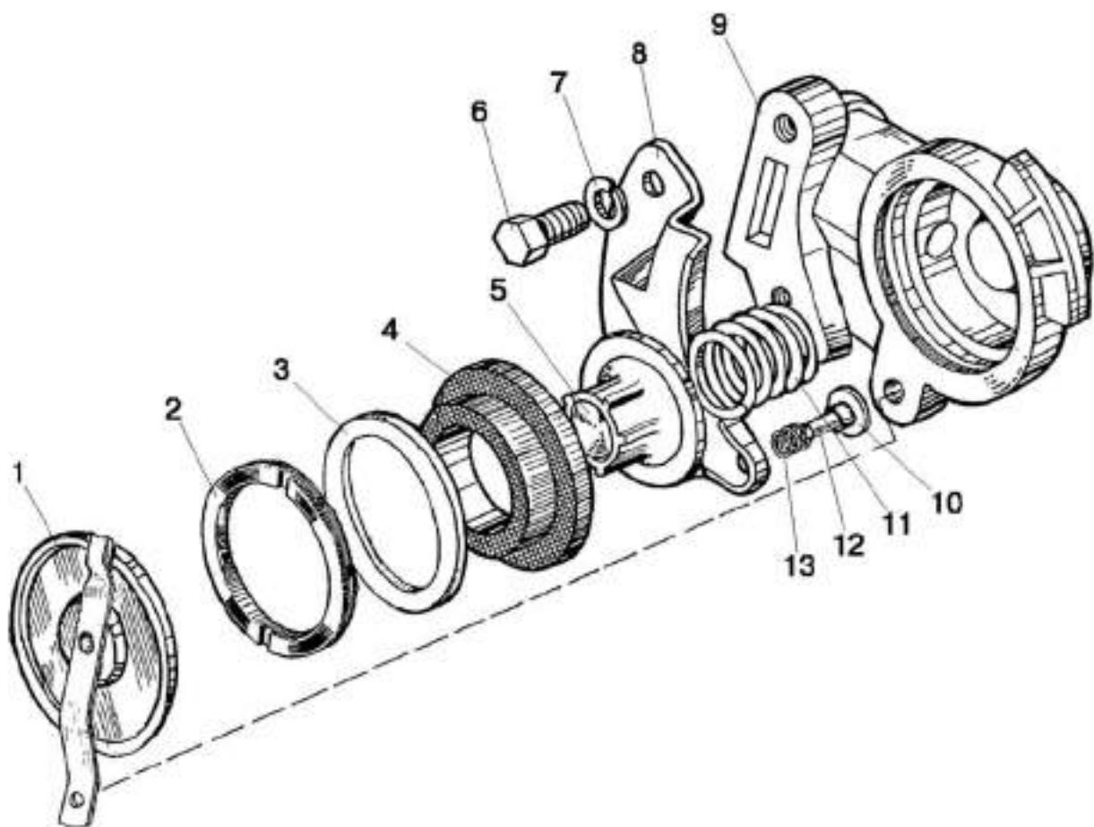
Рис. 35.9. Головка соединительная (для однопроводного пневмопривода)
