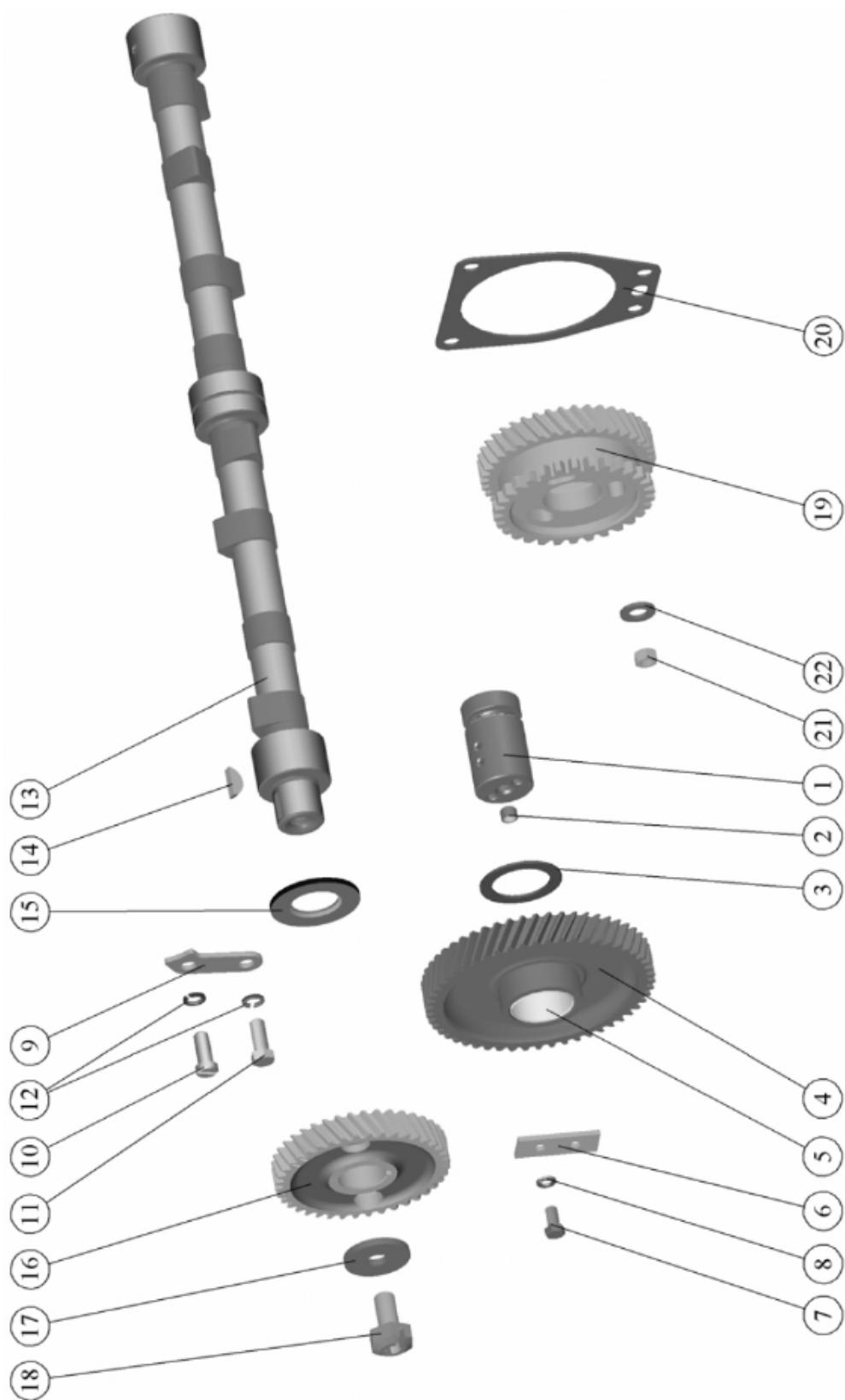
Рис. 10.4. Механизм распределительный
