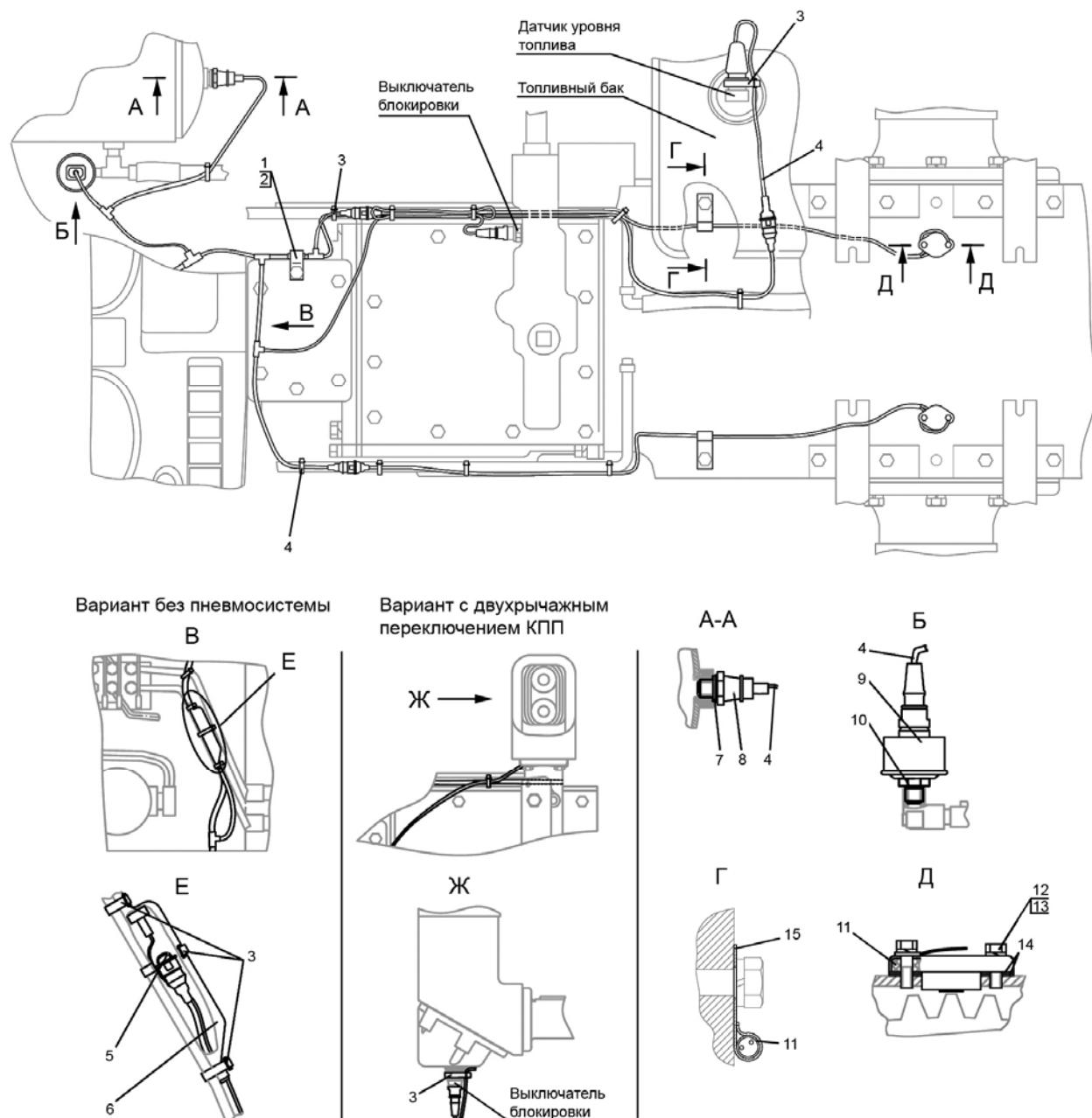
Рис. 37.2. Электрооборудование трансмиссии
