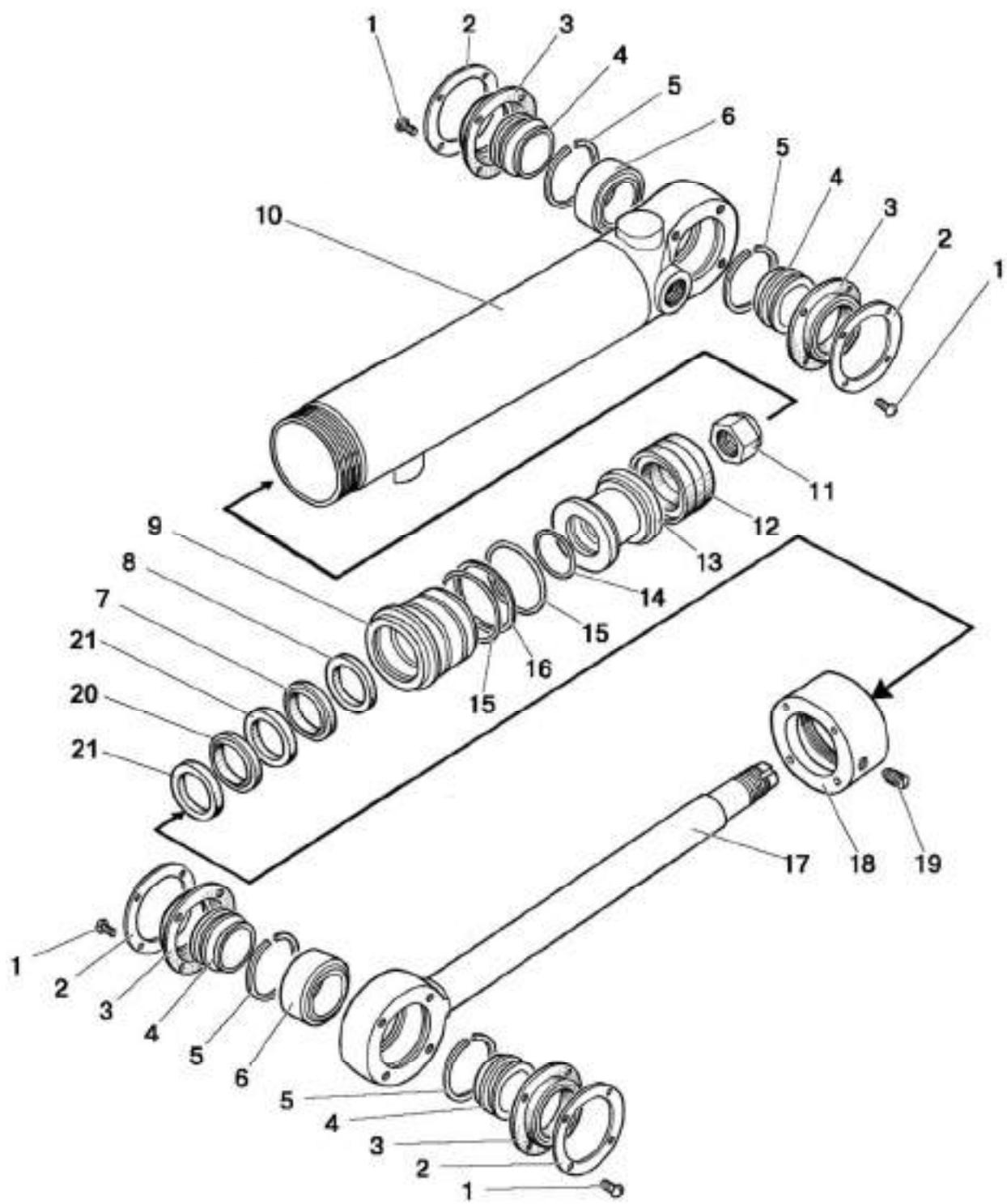
Рис. 34.6. Гидроцилиндр Ц63 (63x30-200)
