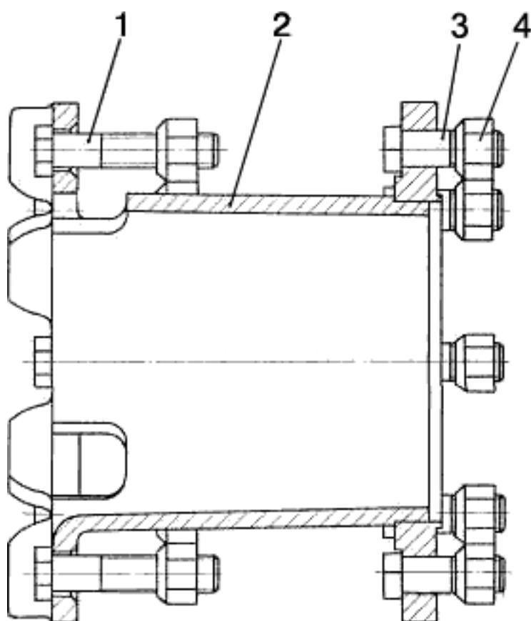
Рис. 31.5. Проставка для сдваивания задних колес
