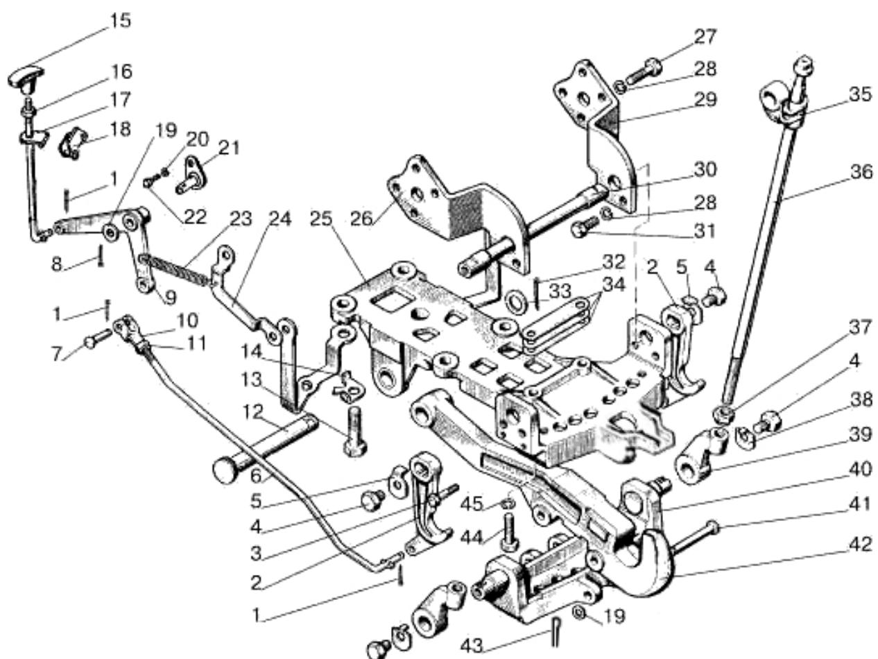
Рис. 27.1. Устройство прицепное. Вариант «крюк» (по заказу). (Для тракторов с силовым регулятором и без силового регулятора)
