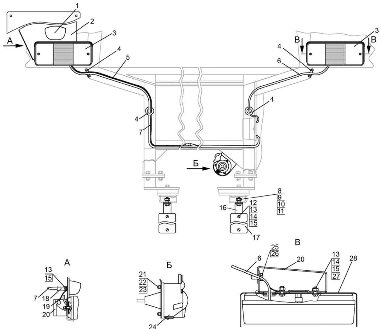
Рис. 37.18. Установка фонарей задних (для трактора «БЕЛАРУС-82П»)
