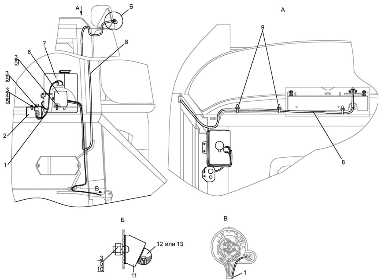
Рис. 52.4. Установка стеклоомывателя заднего (для трактора «БЕЛАРУС-82П»)
