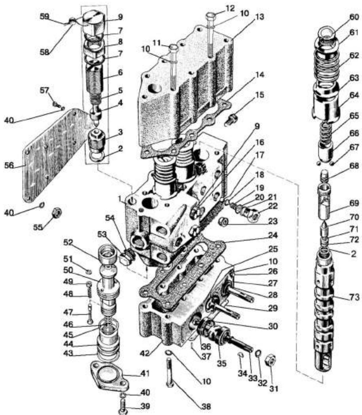
Рис. 46.19. Гидрораспределитель Р80
