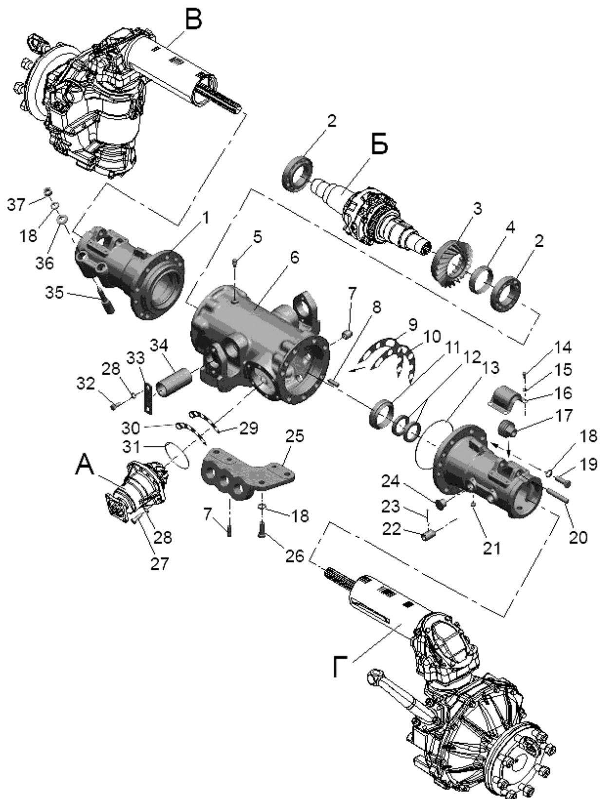
Рис. 23.1. Передний ведущий мост в сборе
