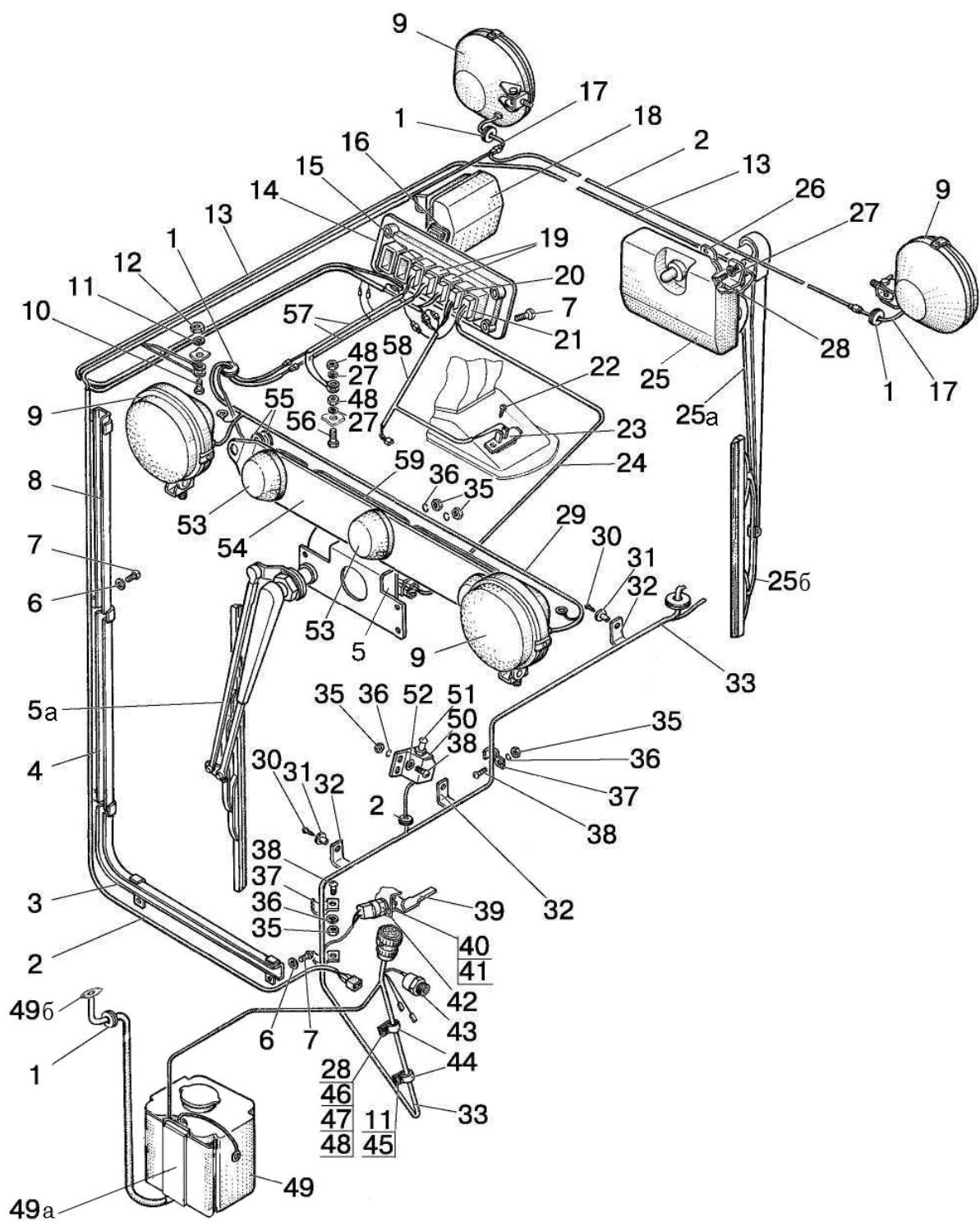
Рис. 37.3. Электрооборудование кабины
