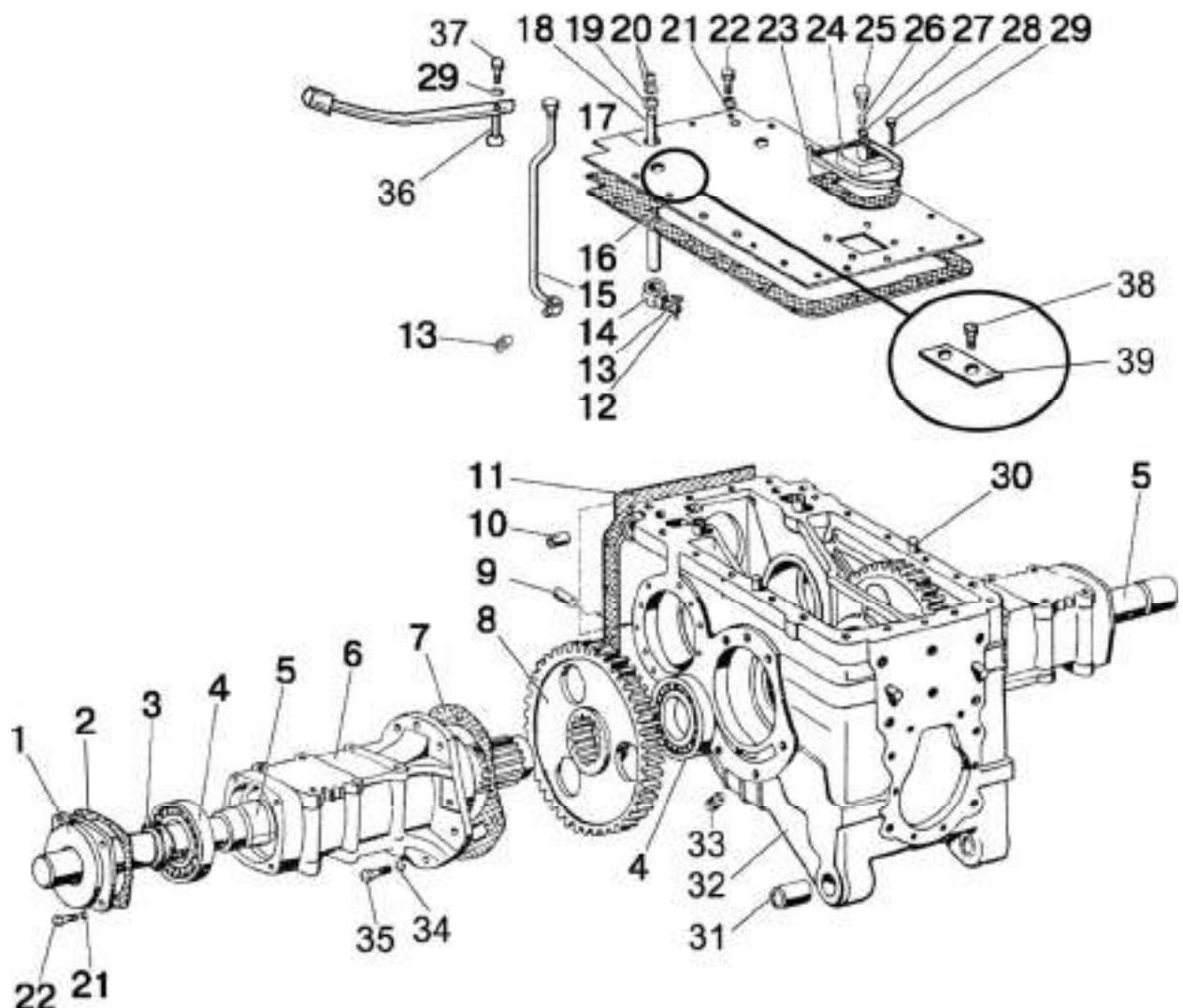
Рис. 24.1. Корпус заднего моста. Конечная передача
