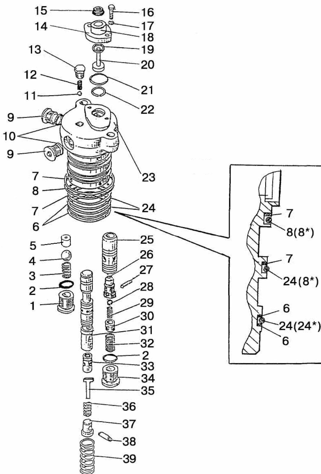
Рис. 46.27. Распределитель гидроподъемника (для трактора «БЕЛАРУС-82П» с гидроподъемником)
