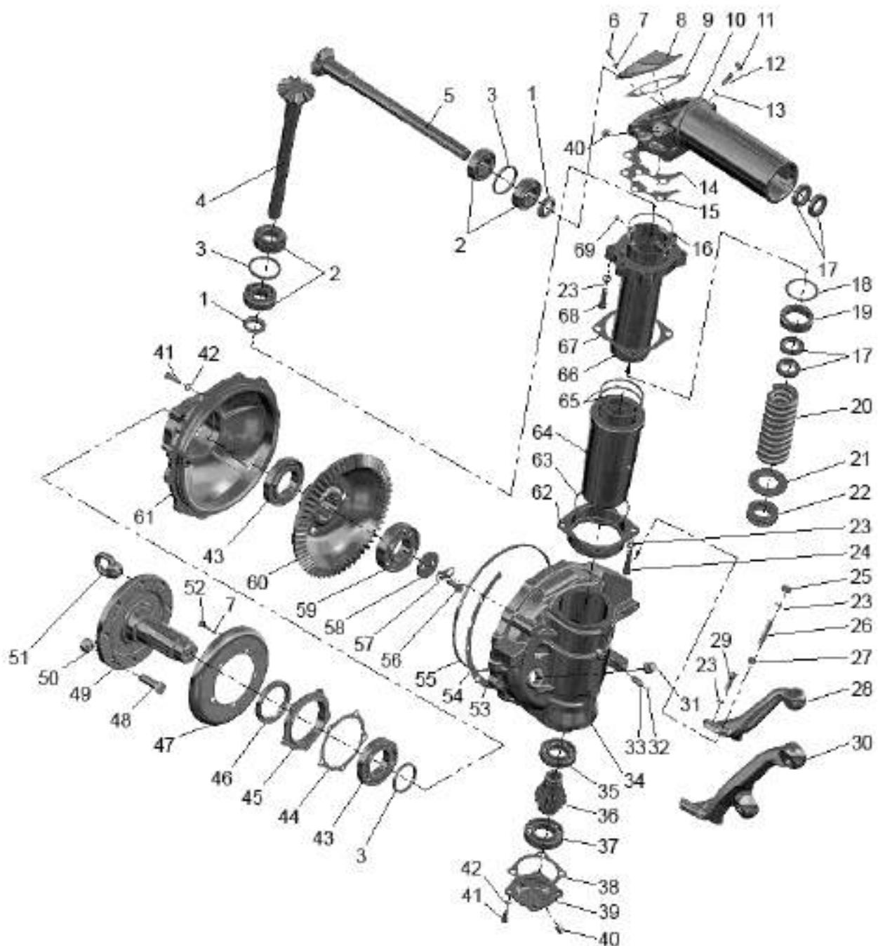
Рис. 23.5. Редуктор конечной передачи ПВМ
