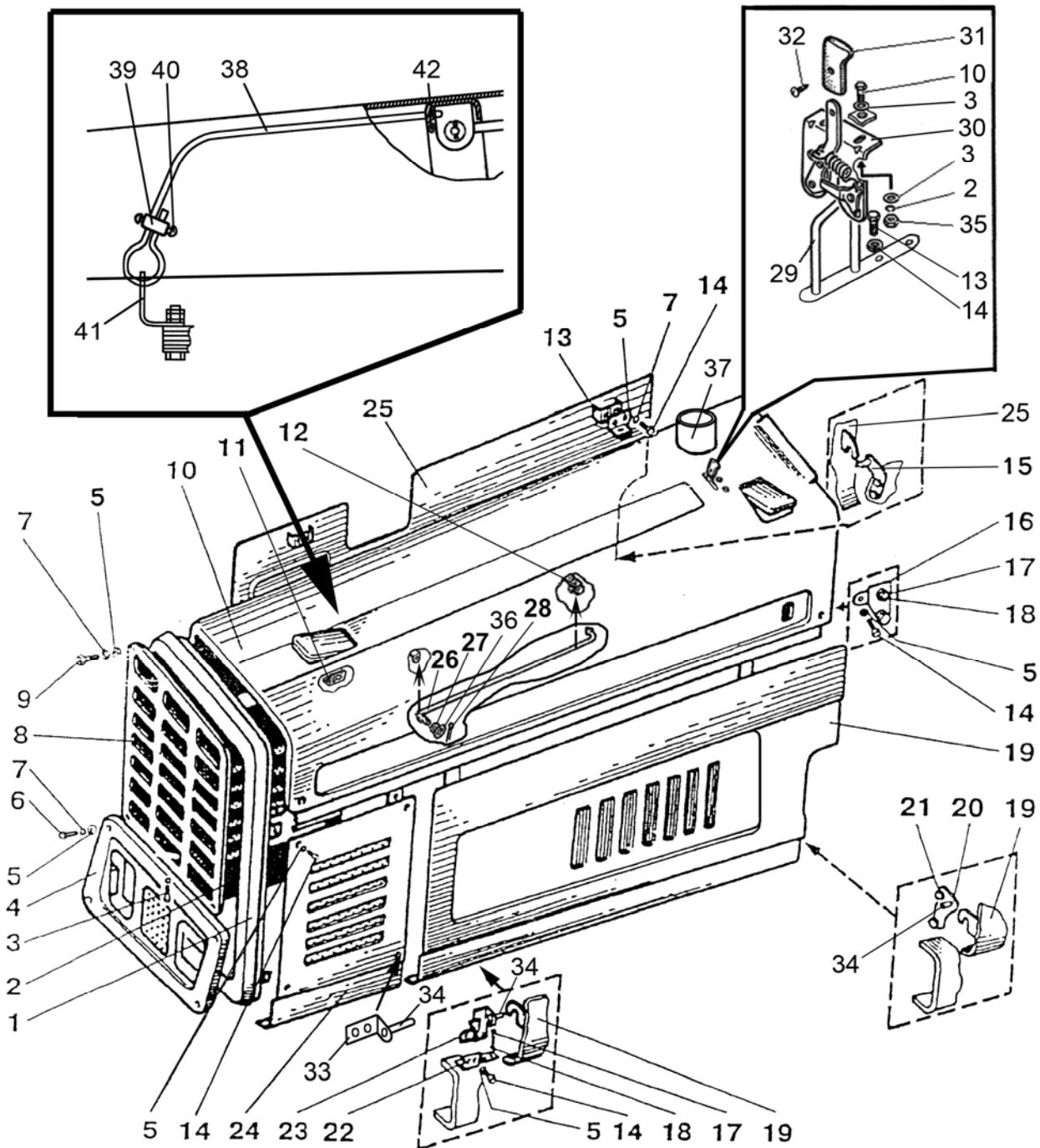
Рис. 84.2. Облицовка радиатора. Капот (для трактора «БЕЛАРУС-82Р»)
