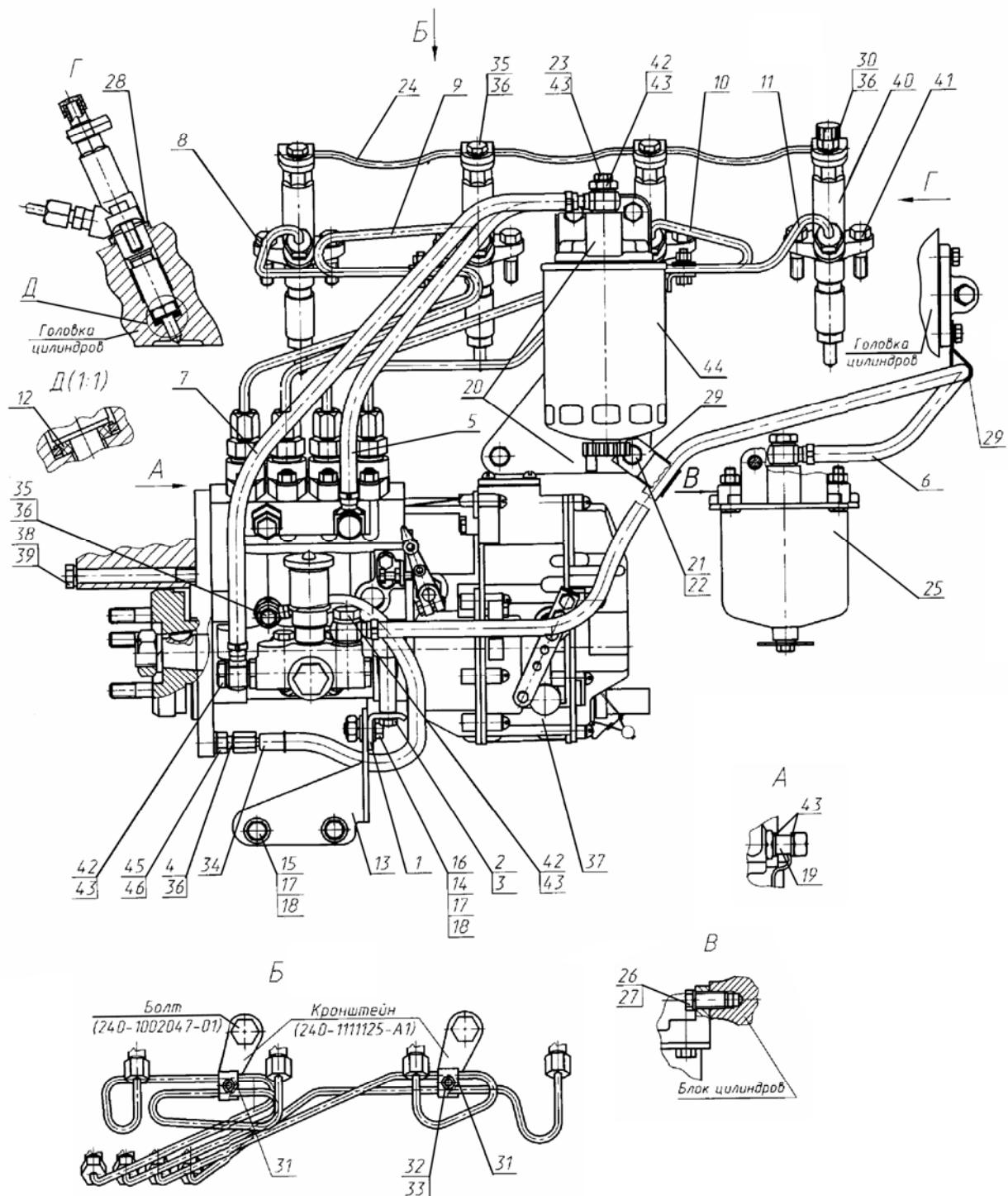
Рис. 11.5. Установка топливной аппаратуры (для двигателя Д-243С с топливным насосом пр-ва ОАО «ЯЗДА»)
