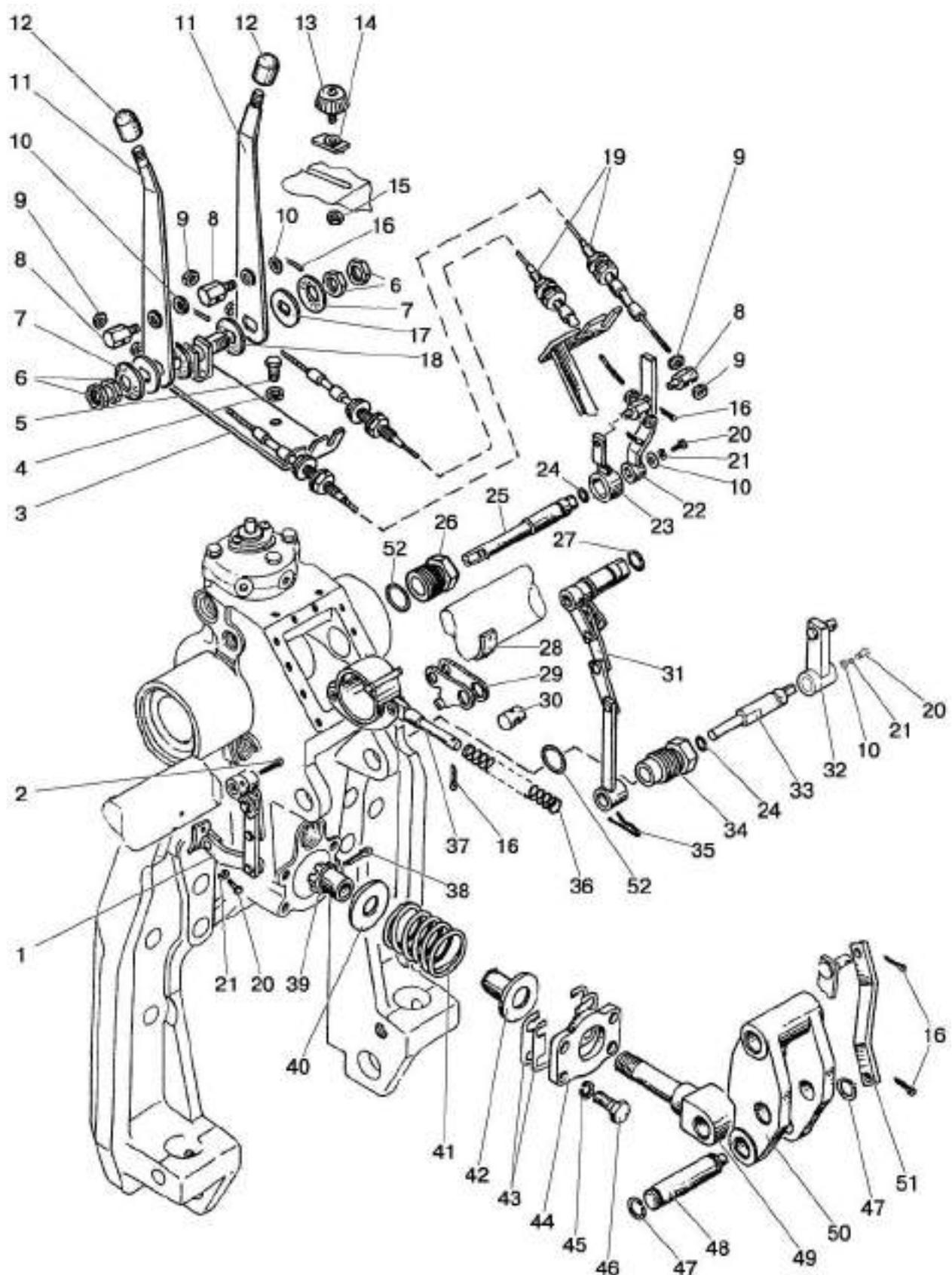
Рис. 46.28. Гидроподъемник. Управление гидроподъемником
