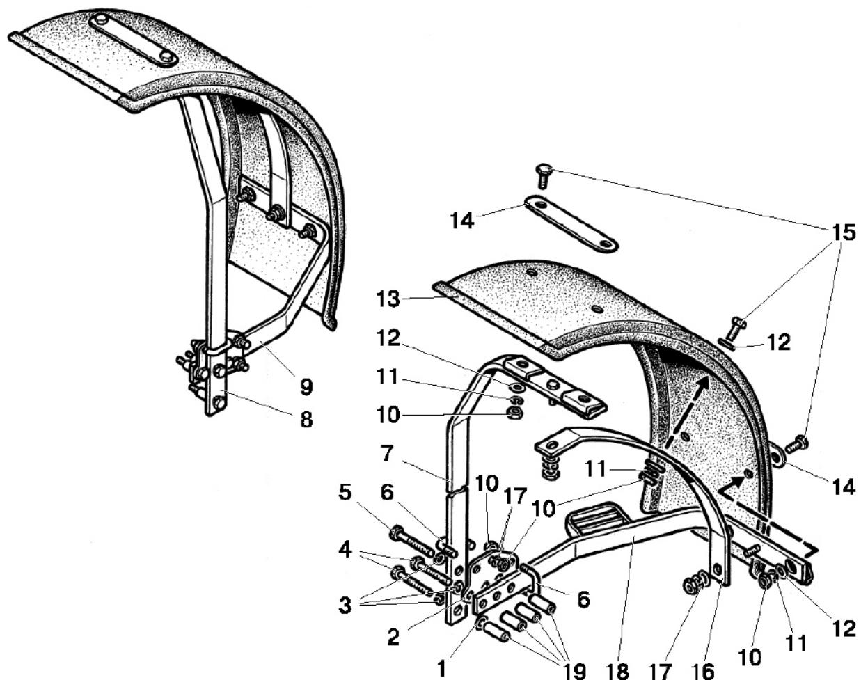
Рис. 84.5. Крылья передние (для трактора «БЕЛАРУС-82Р»)
