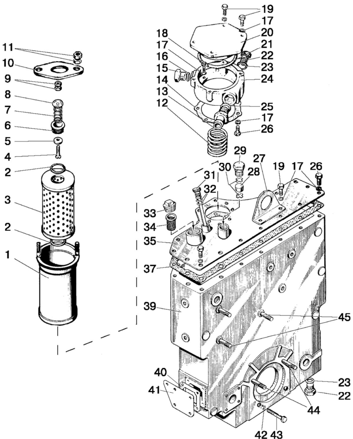
Рис. 46.13. Корпус гидроагрегатов и фильтр. Вариант
