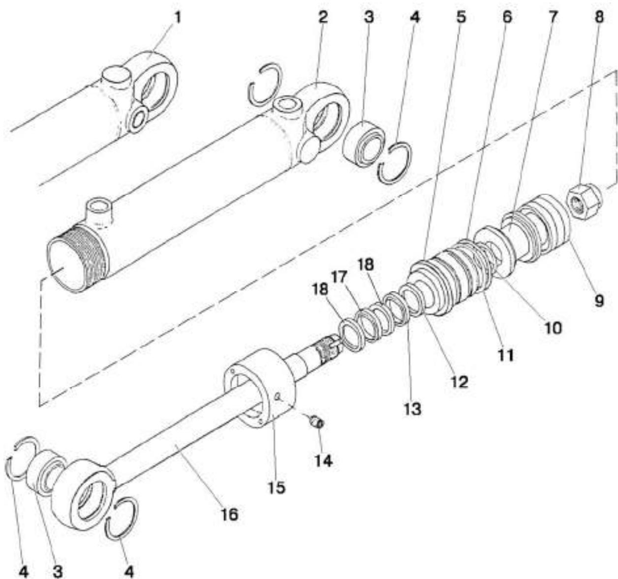
Рис. 34.4. Гидроцилиндр 50х25-200
