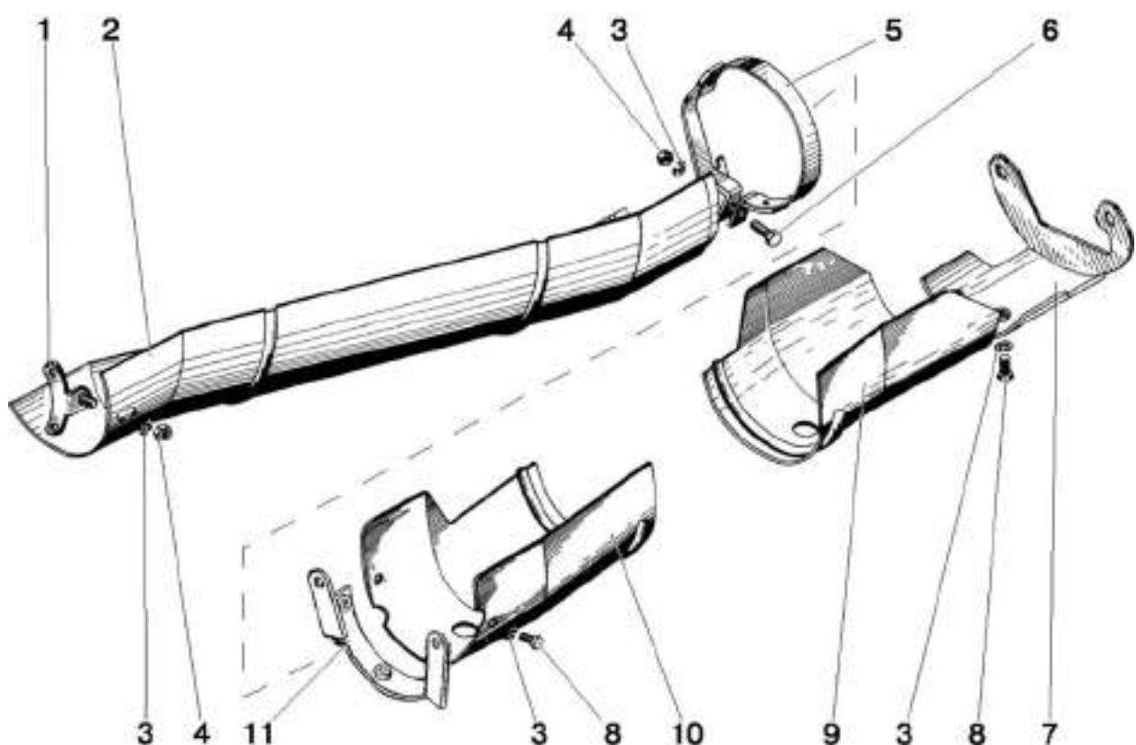
Рис. 22.2. Ограждение карданного вала
