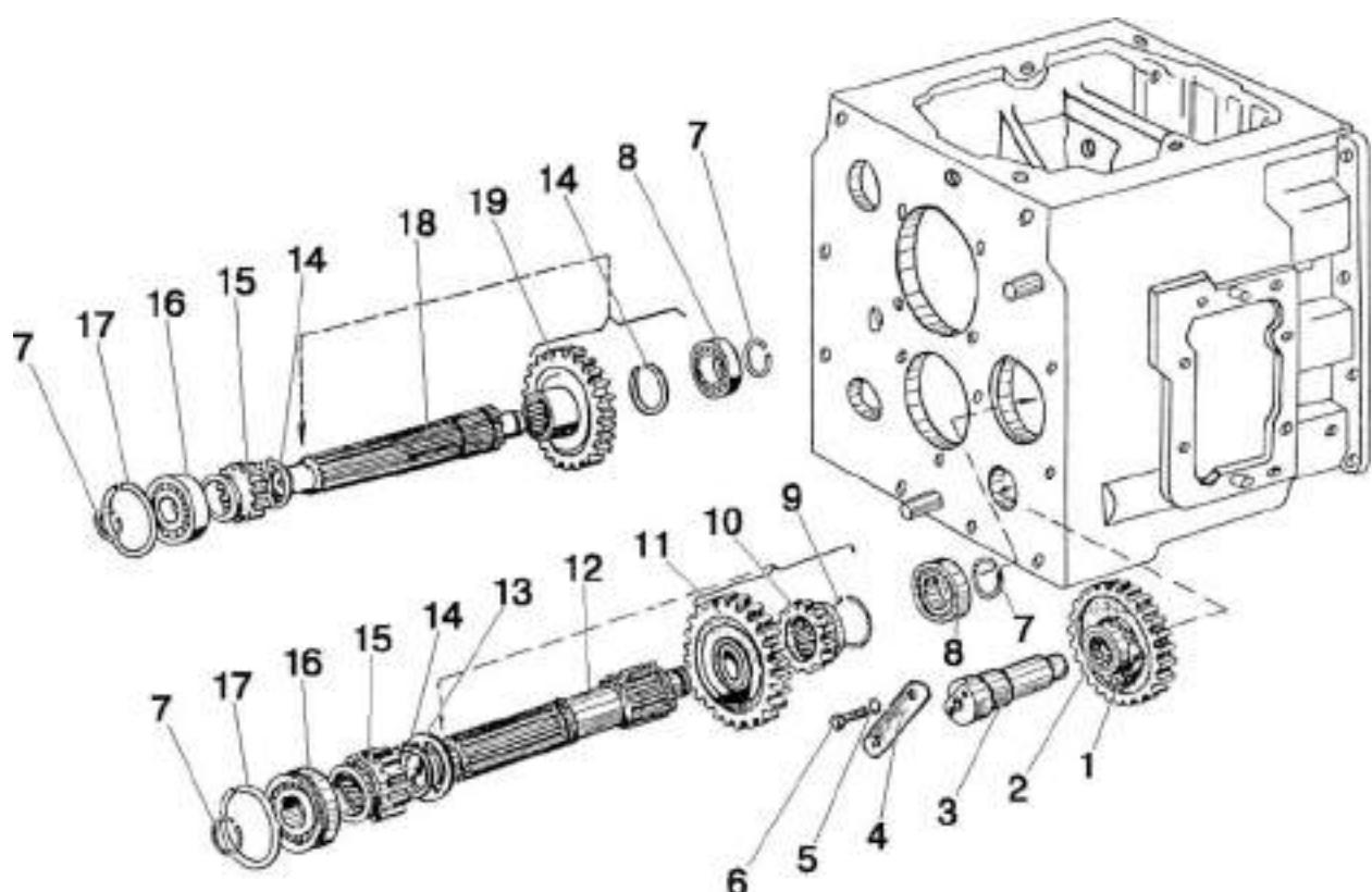
Рис. 17.4. Вал первой передачи и заднего хода
