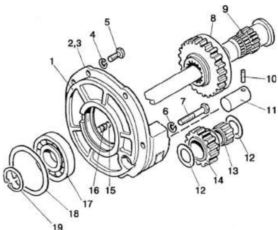
Рис. 16.6. Корпус сцепления (реверс-редуктор)
