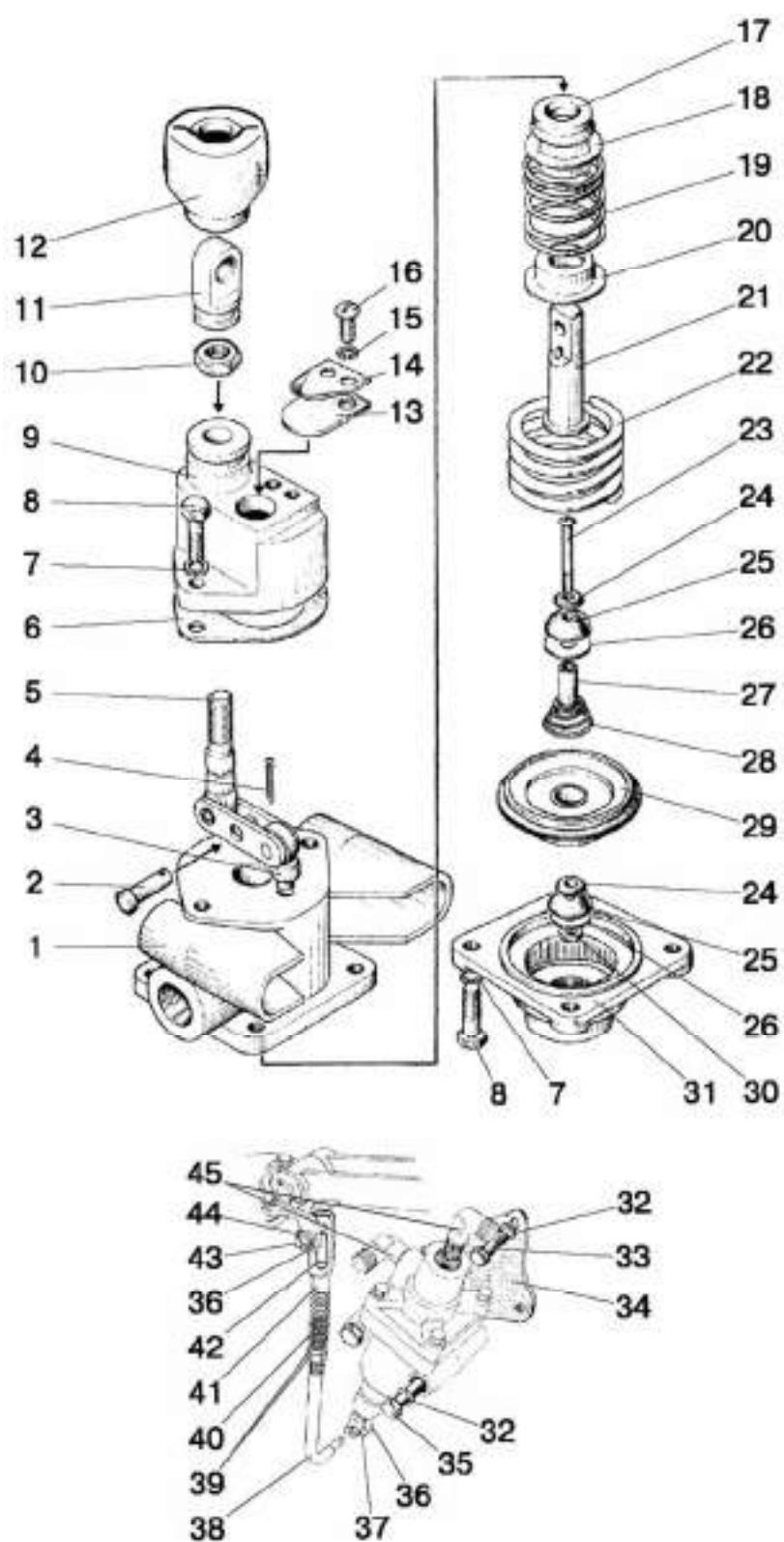
Рис. 35.7. Кран тормозной (для однопроводного пневмопривода)
