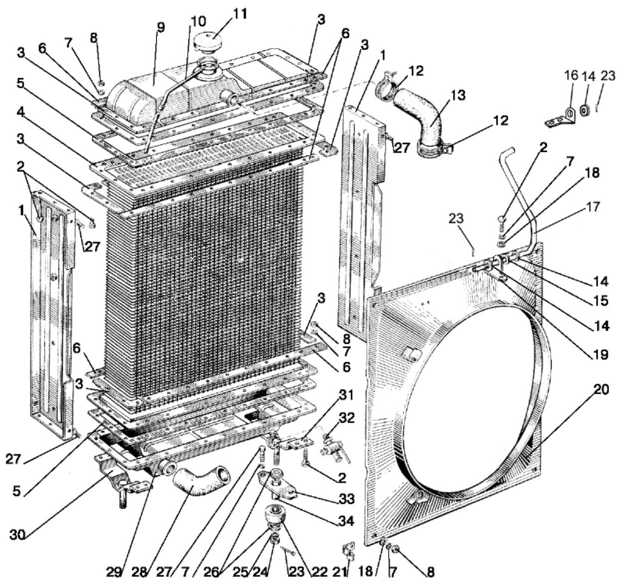
Рис. 13.1. Радиатор водяной. Подвеска радиатора водяного
