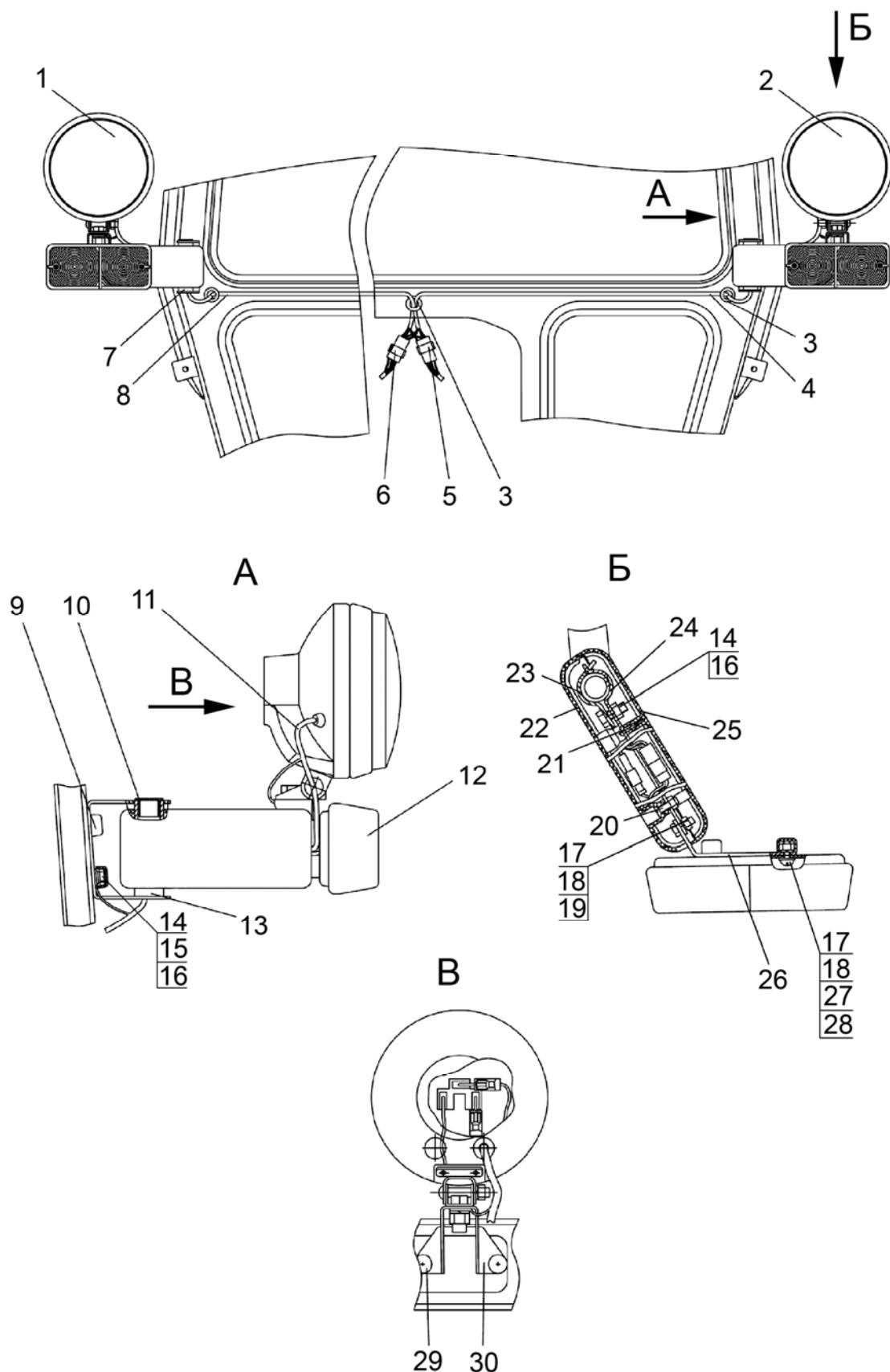
Рис. 37.16. Установка фонарей передних с дорожными фарами
