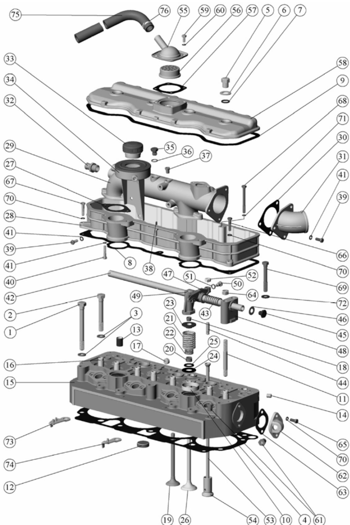
Рис. 10.2. Головка цилиндров. Клапаны и толкатели клапанов
