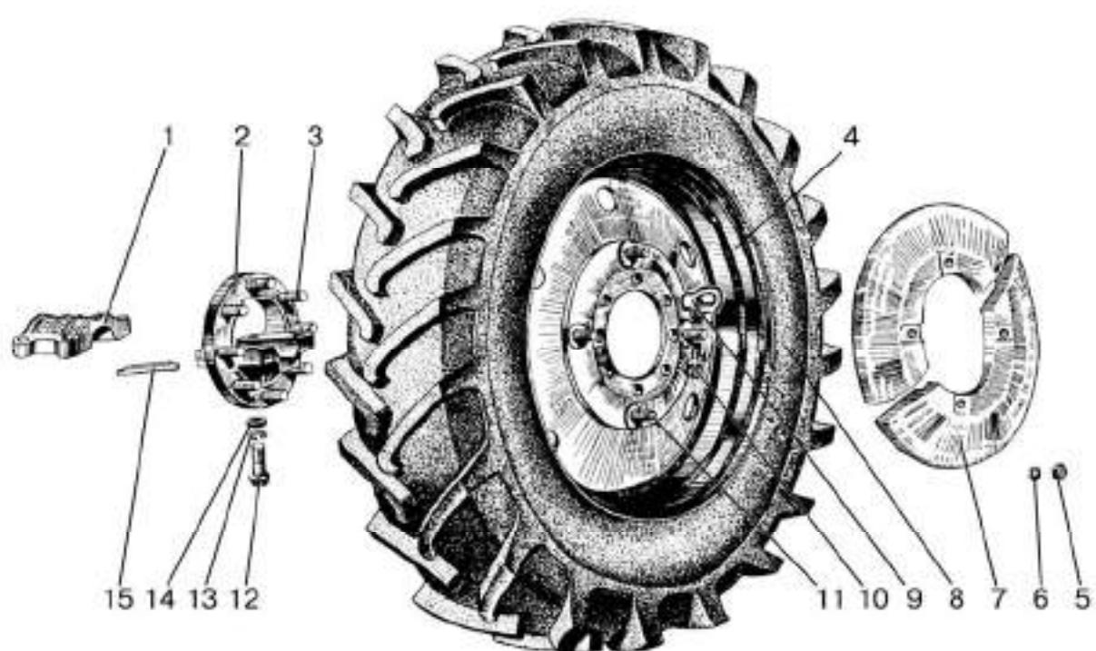
Рис. 31.4. Колеса задние. Ступицы задних колес
