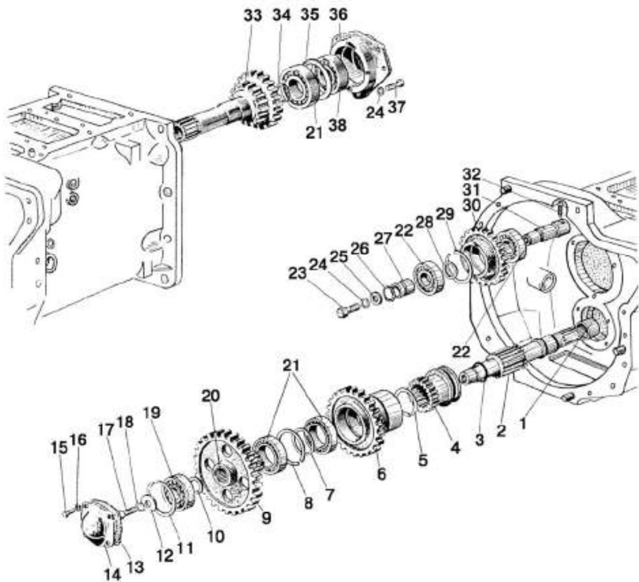
Рис. 16.4. Корпус сцепления (привод ВОМ, привод насоса гидросистемы навески)
