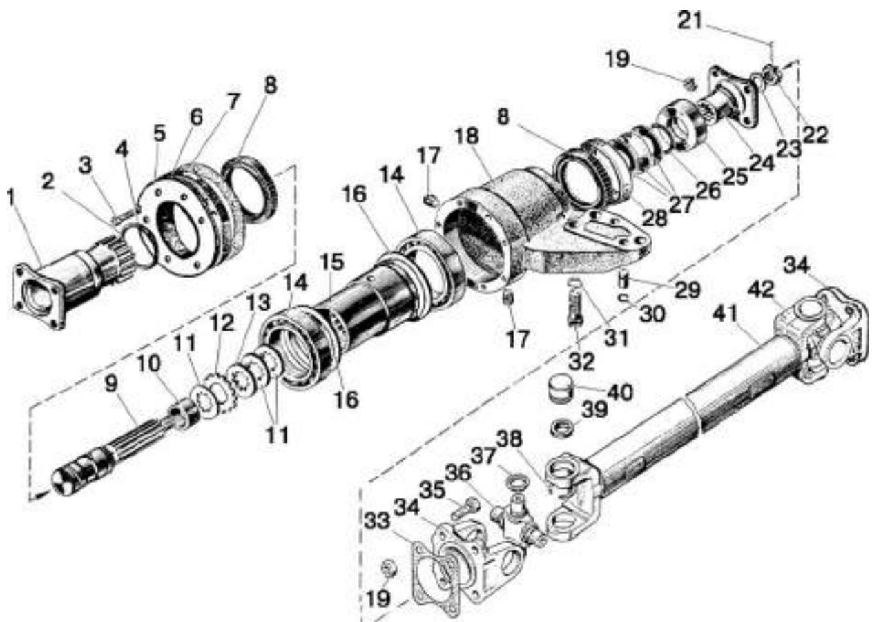
Рис. 22.1. Карданный вал. Промежуточная опора карданного вала
