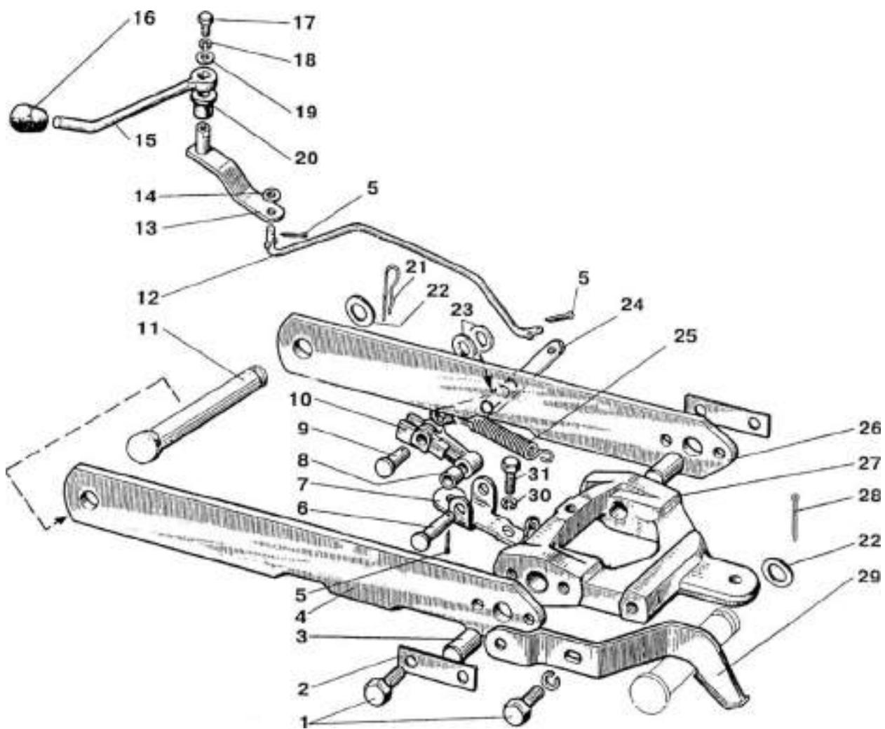
Рис. 46.26. Механизм фиксации
