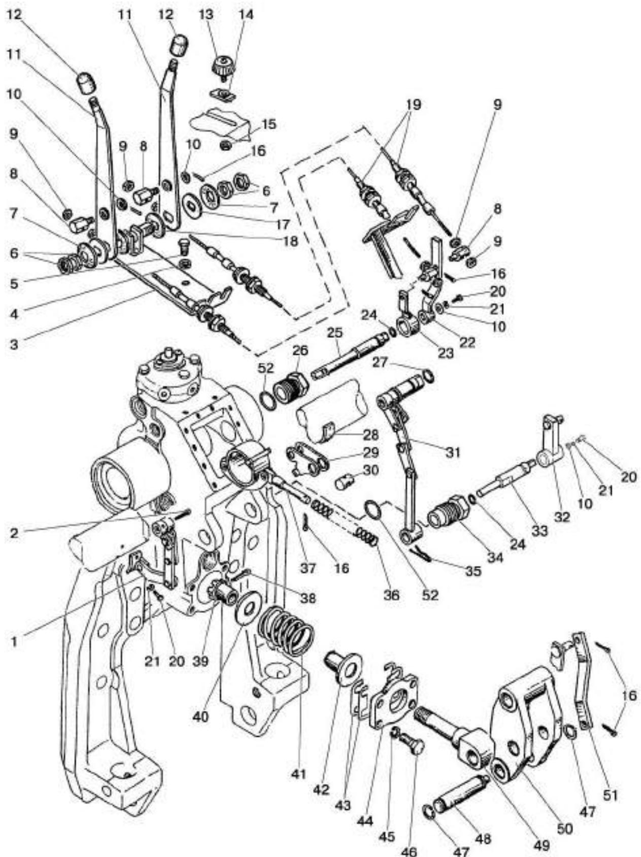
Рис. 46.28. Гидроподъемник. Управление гидроподъемником
