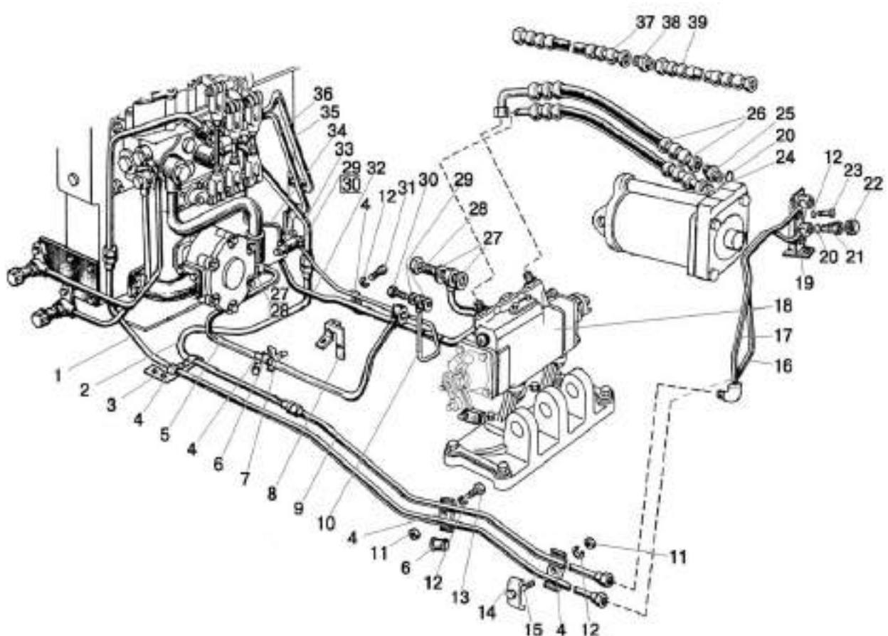
Рис. 46.9. Гидроагрегаты и арматура. Вариант с силовым регулятором
