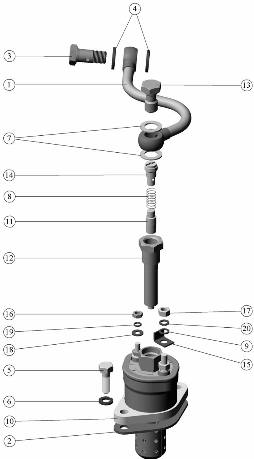
Рис. 37.10. Подогреватель электрофакельный
