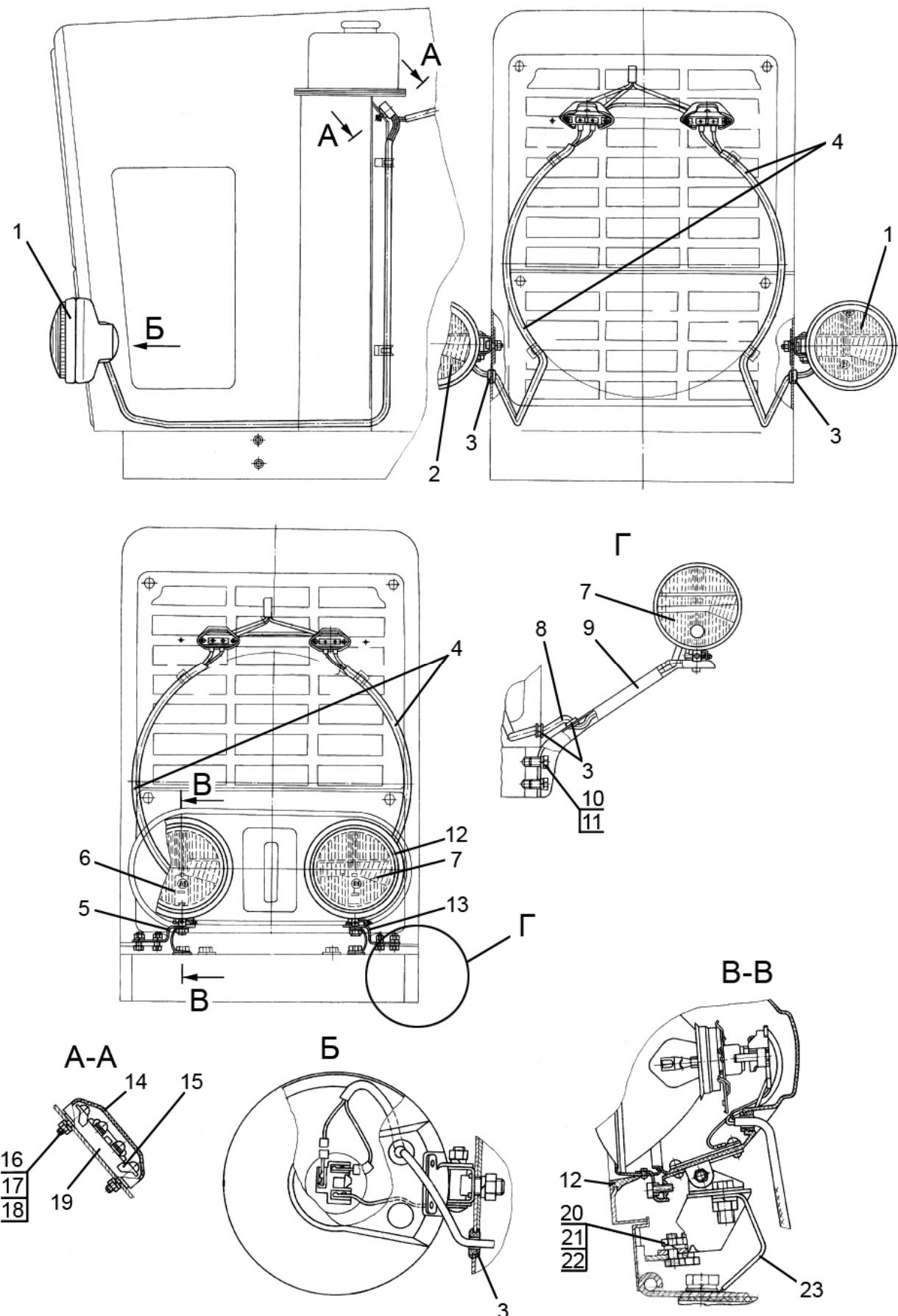
Рис. 37.15. Установка фар дорожных
