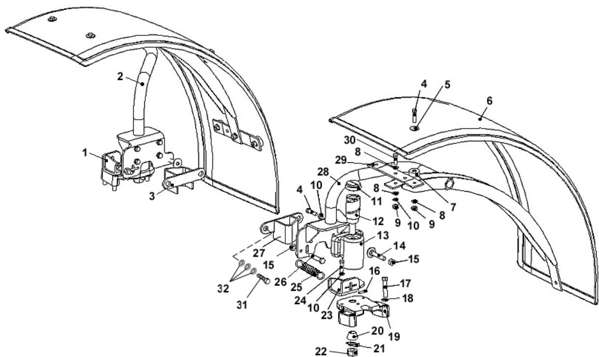
Рис. 84.7. Крылья передние (для тракторов «БЕЛАРУС-82.1/820/82.3»)
