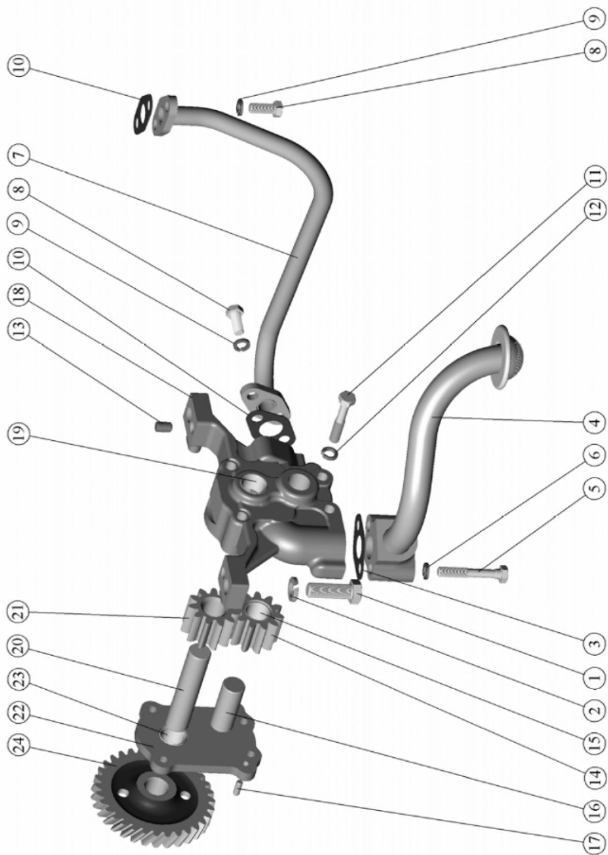
Рис. 14.2. Насос масляный и приемник масляного насоса
