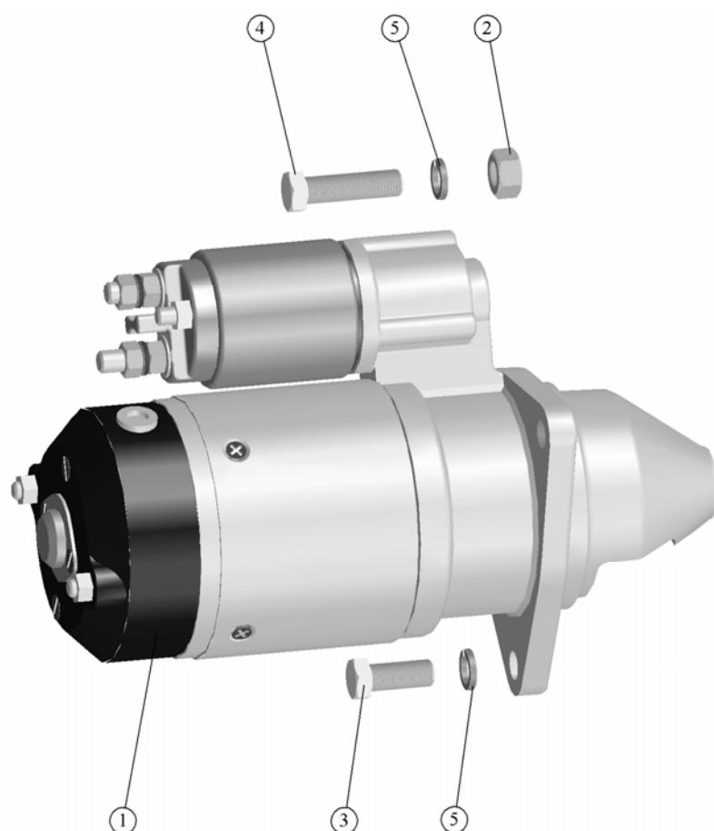
Рис. 37.9. Стартер. Установка стартера
