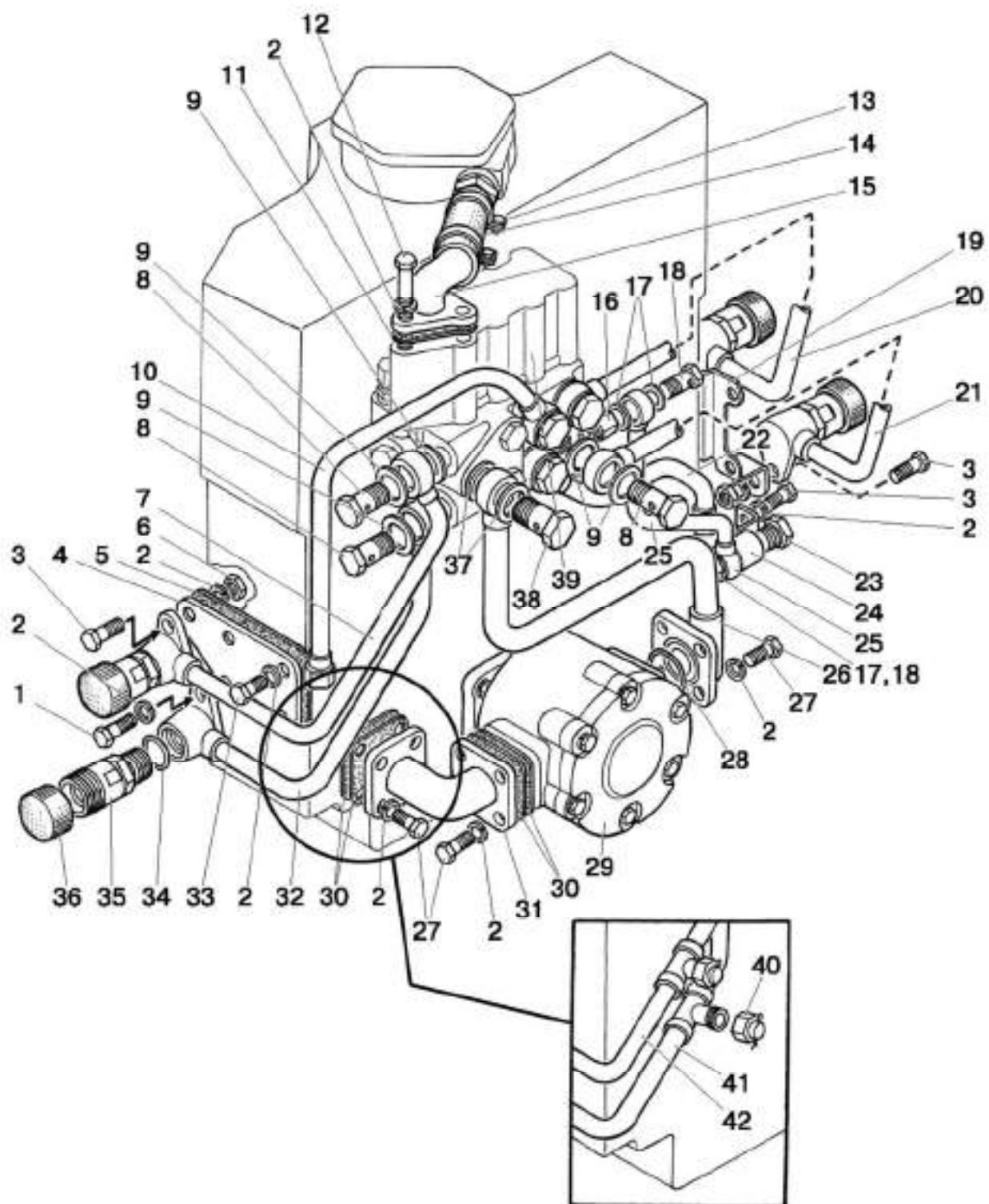
Рис. 46.8. Арматура корпуса гидроагрегатов
