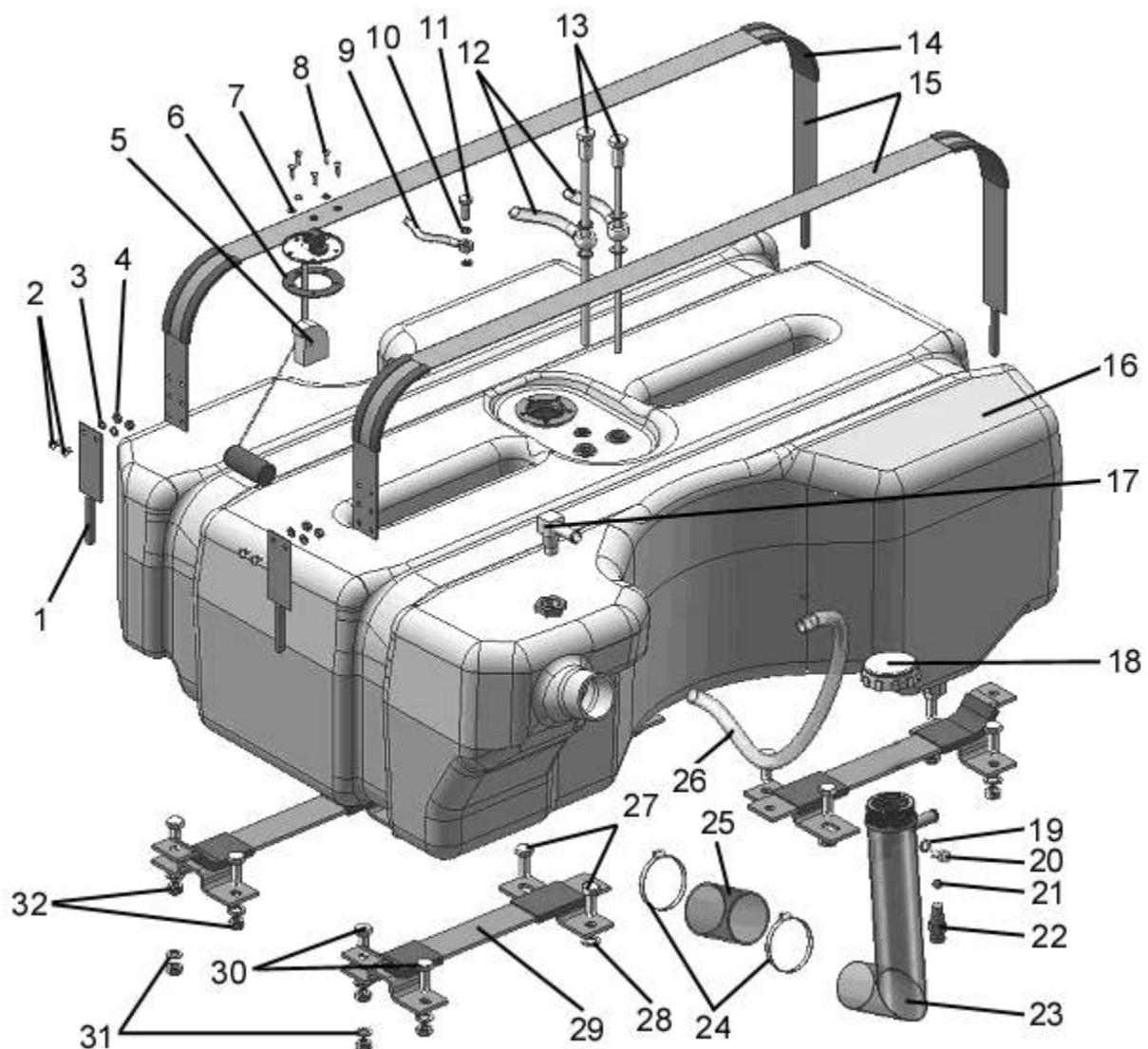
Рис. 11.3. Бак топливный (для трактора «БЕЛАРУС-82П»)
