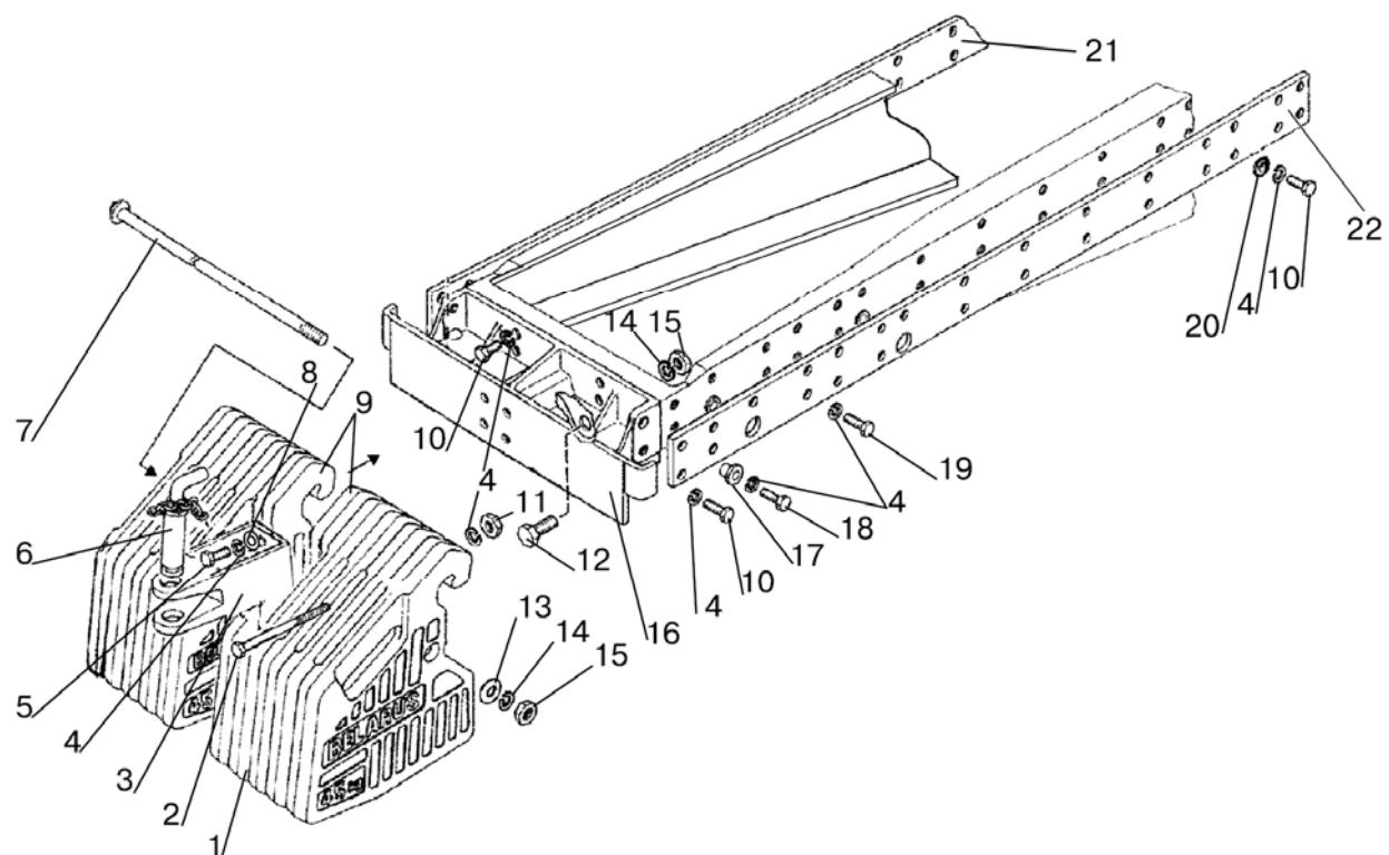
Рис. 42.6. Балласт передний (для трактора «БЕЛАРУС-820»)
