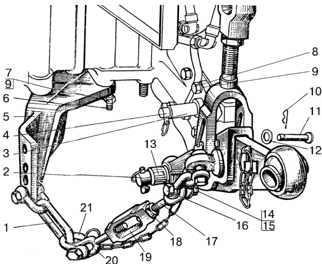
Рис. 46.3. Наружная блокировка нижних тяг (для тракторов с силовым регулятором и без силового регулятора)
