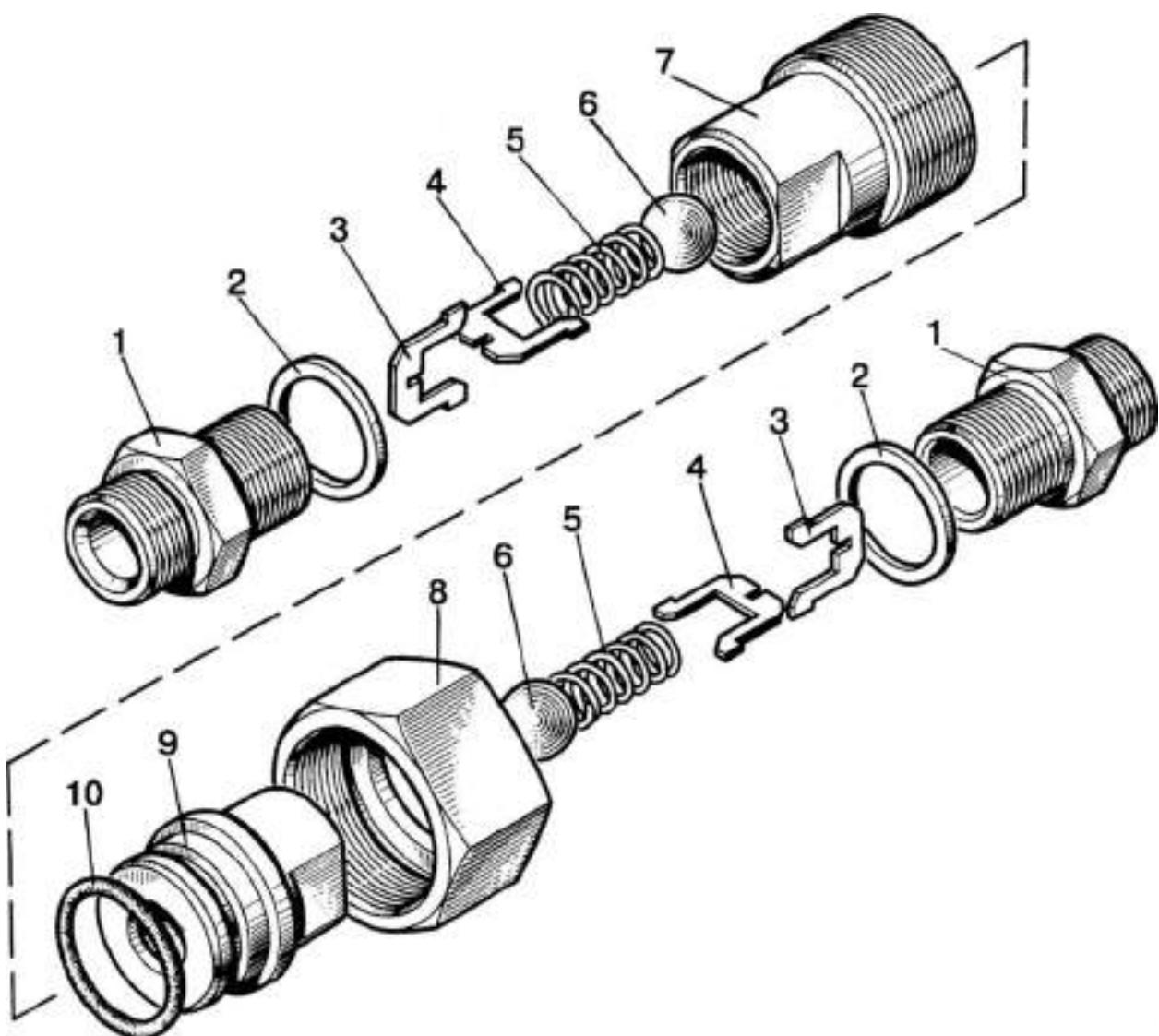
Рис. 46.25. Запорное устройство
