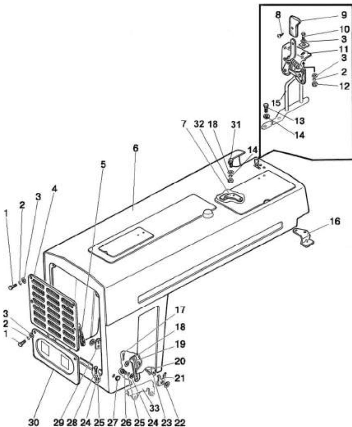
Рис. 84.1. Облицовка радиатора. Капот (кроме трактора «БЕЛАРУС-82Р»)
