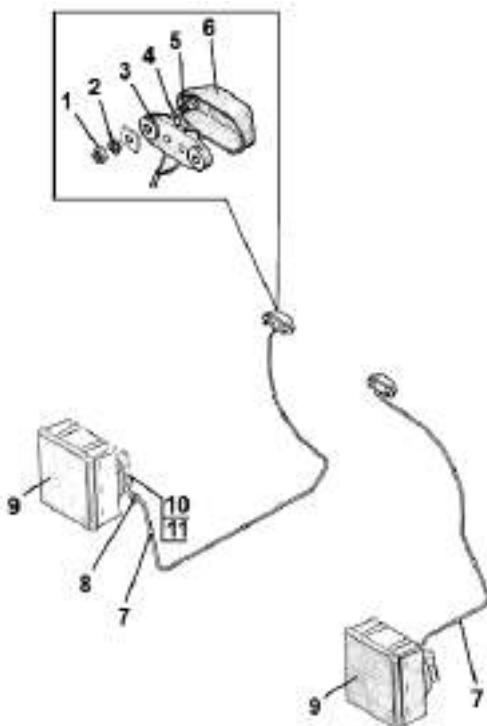
Рис. 37.11. Установка фар дорожных (кроме трактора «БЕЛАРУС-82П»)
