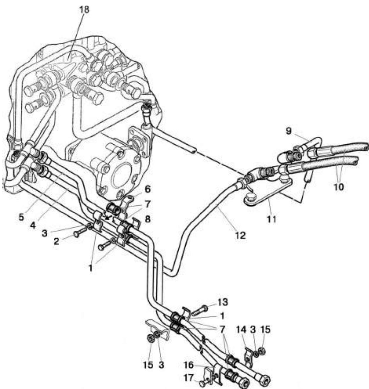
Рис. 46.10. Гидроагрегаты и арматура. Вариант без силового регулятора
