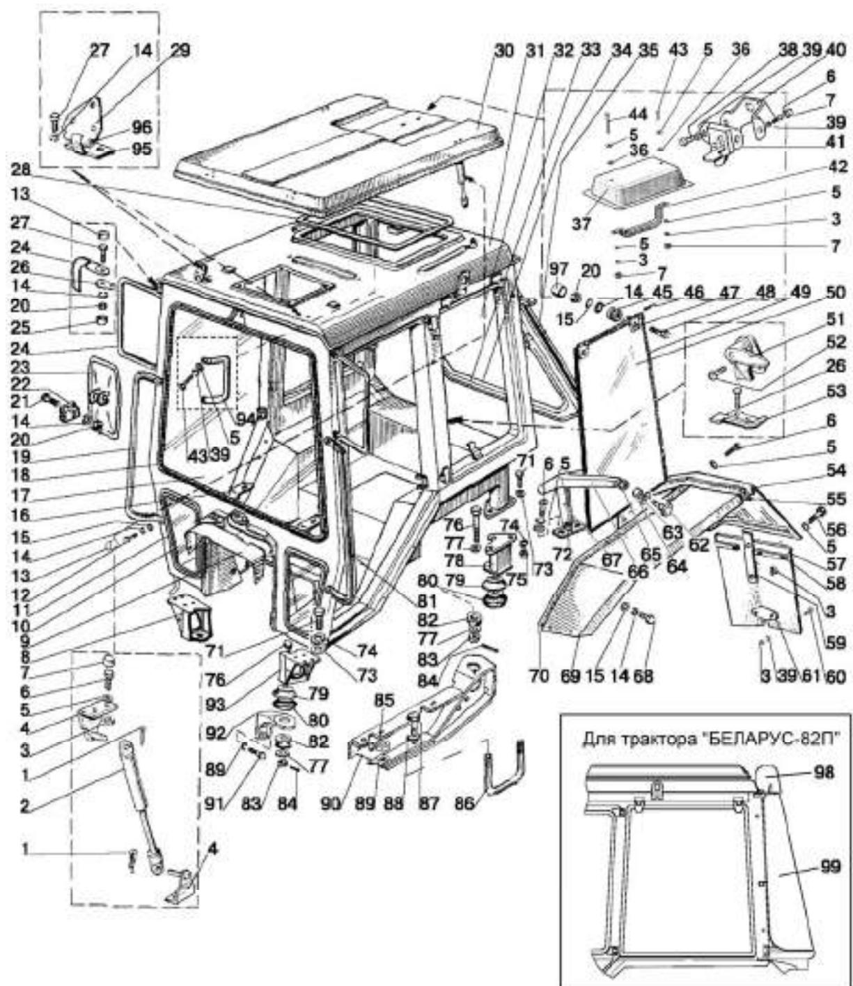
Рис. 67.1. Кабина трактора. Крылья задние
