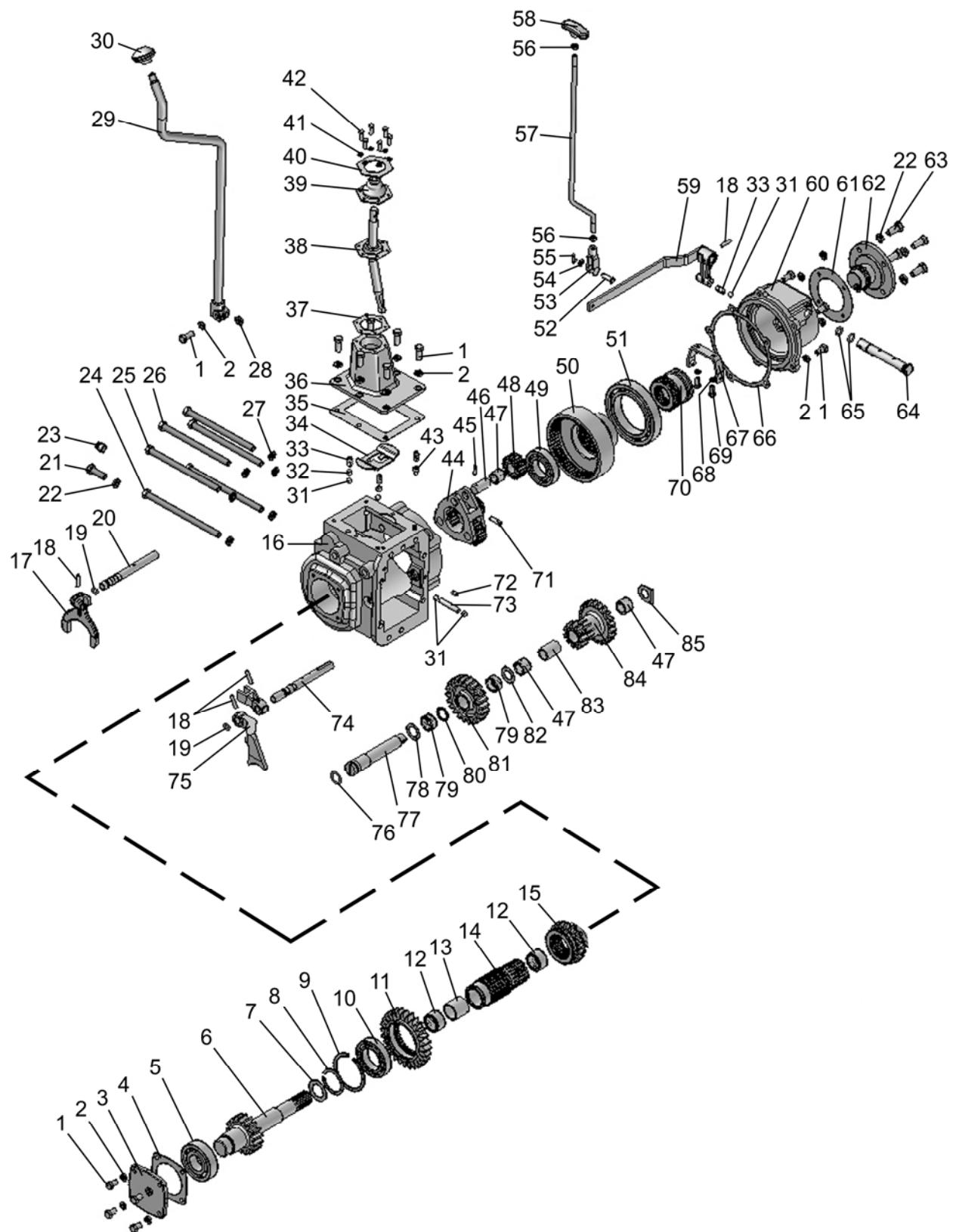
Рис. 17.10. Ходоуменьшитель механический
