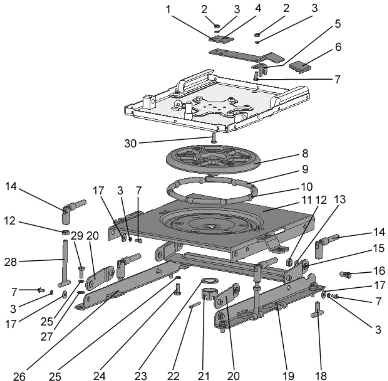
Рис. 68.3. Механизм реверса (для трактора «БЕЛАРУС-82П»)
