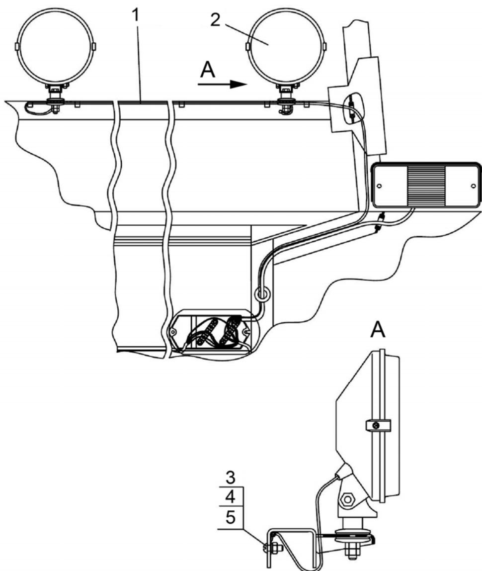
Рис. 37.13. Установка фар рабочих (для тракторов с тент-каркасом)
