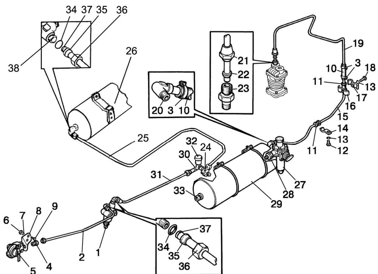
Рис. 35.3. Трубопроводы и арматура однопроводного пневмопривода тормозов прицепа
