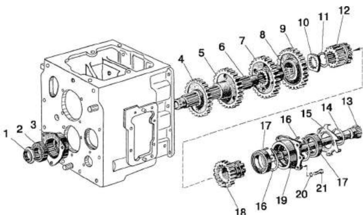
Рис. 17.3. Вал внутренний. Вал промежуточный
