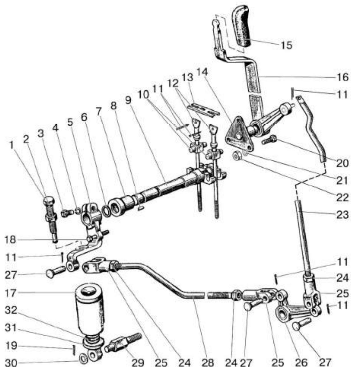
Рис. 42.4. Управление задним валом отбора мощности
