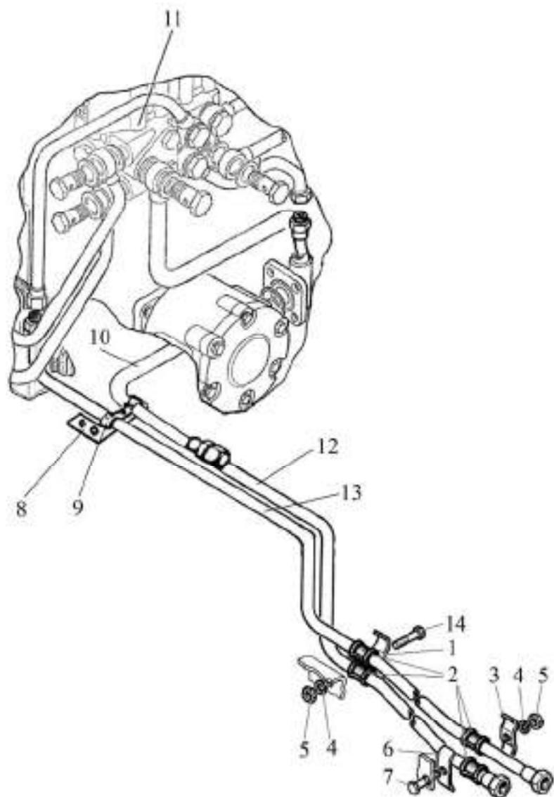
Рис. 46.11. Гидроагрегаты и арматура (для трактора «БЕЛАРУС-82П» без навески)
