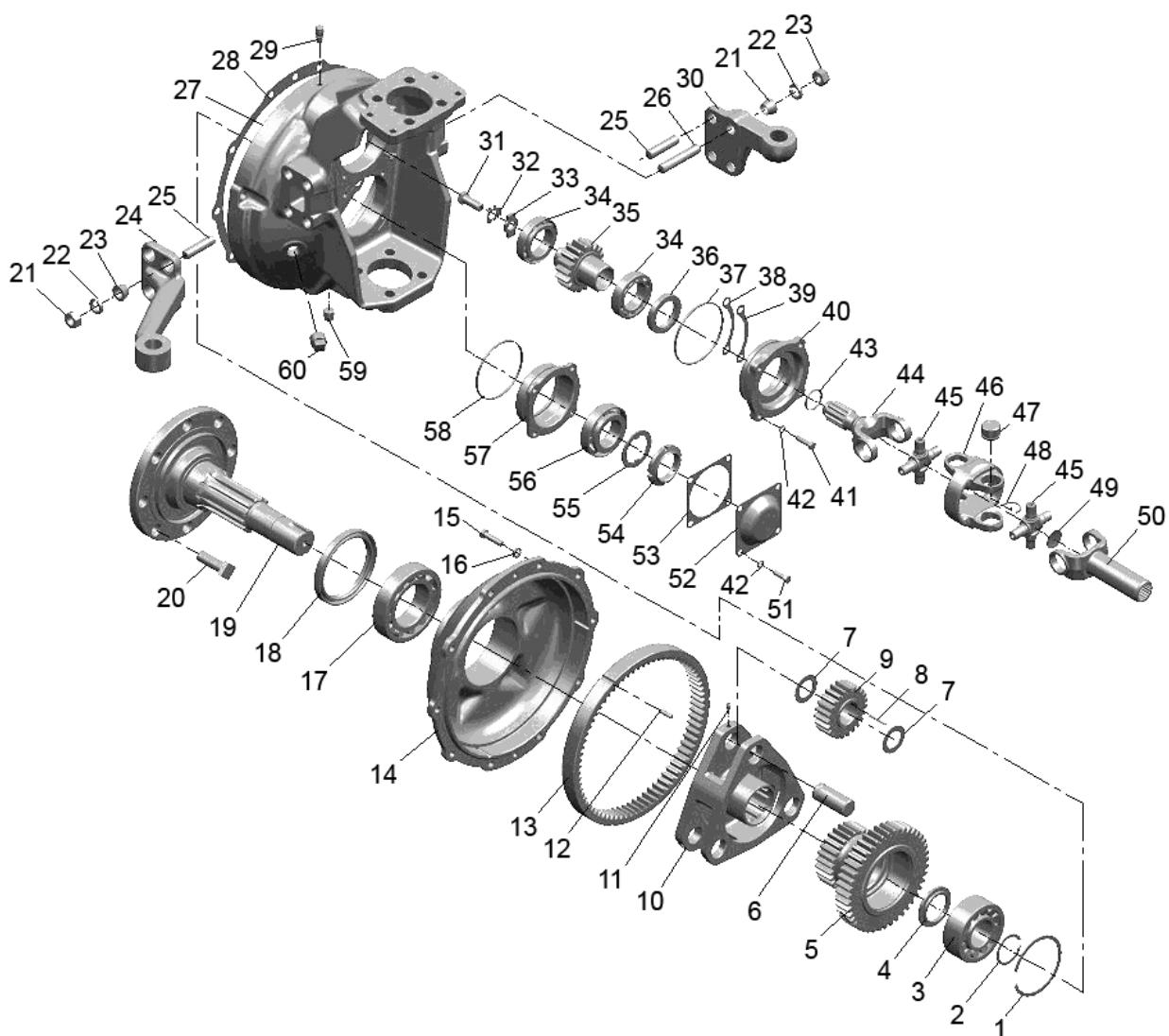
Рис. 23.6. Редуктор конечной передачи ПВМ (для ПВМ 822-2300020-02 или 822-2300020-04 («БЕЛАРУС-820/82.3/82П»))
