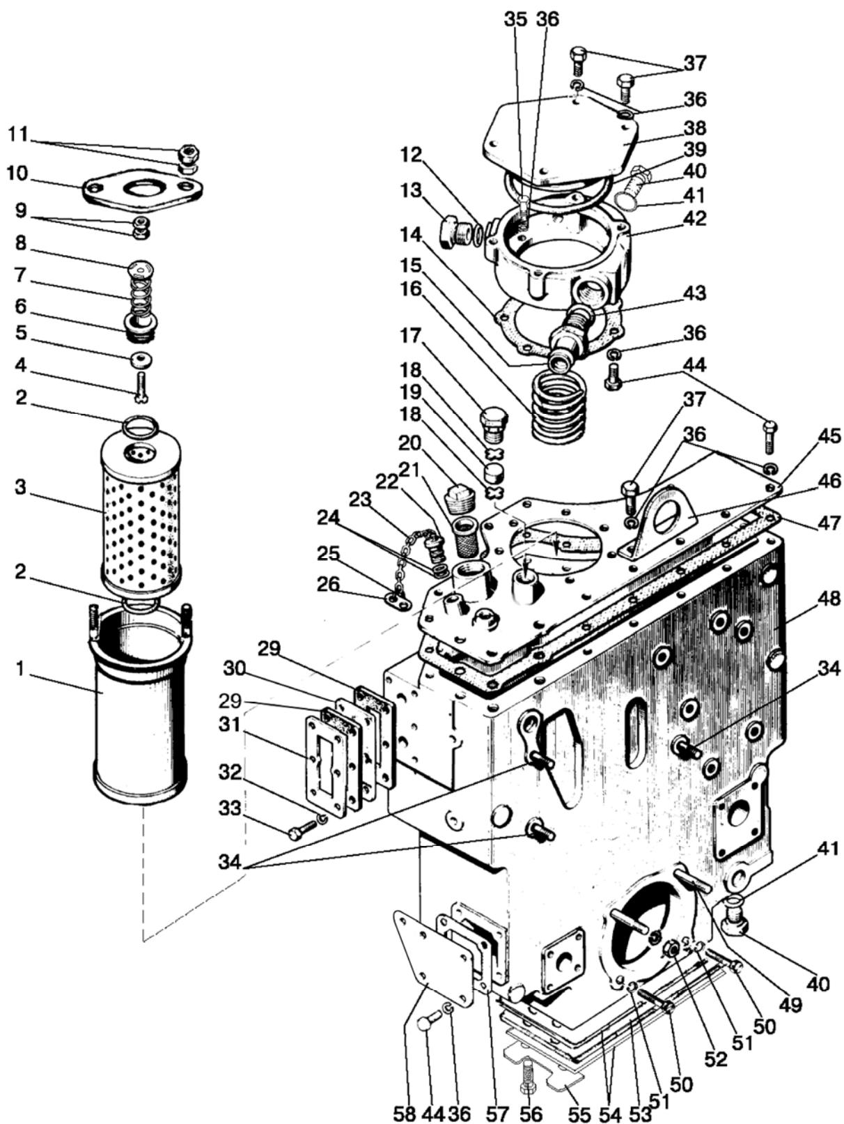
Рис. 46.12. Корпус гидроагрегатов и фильтр
