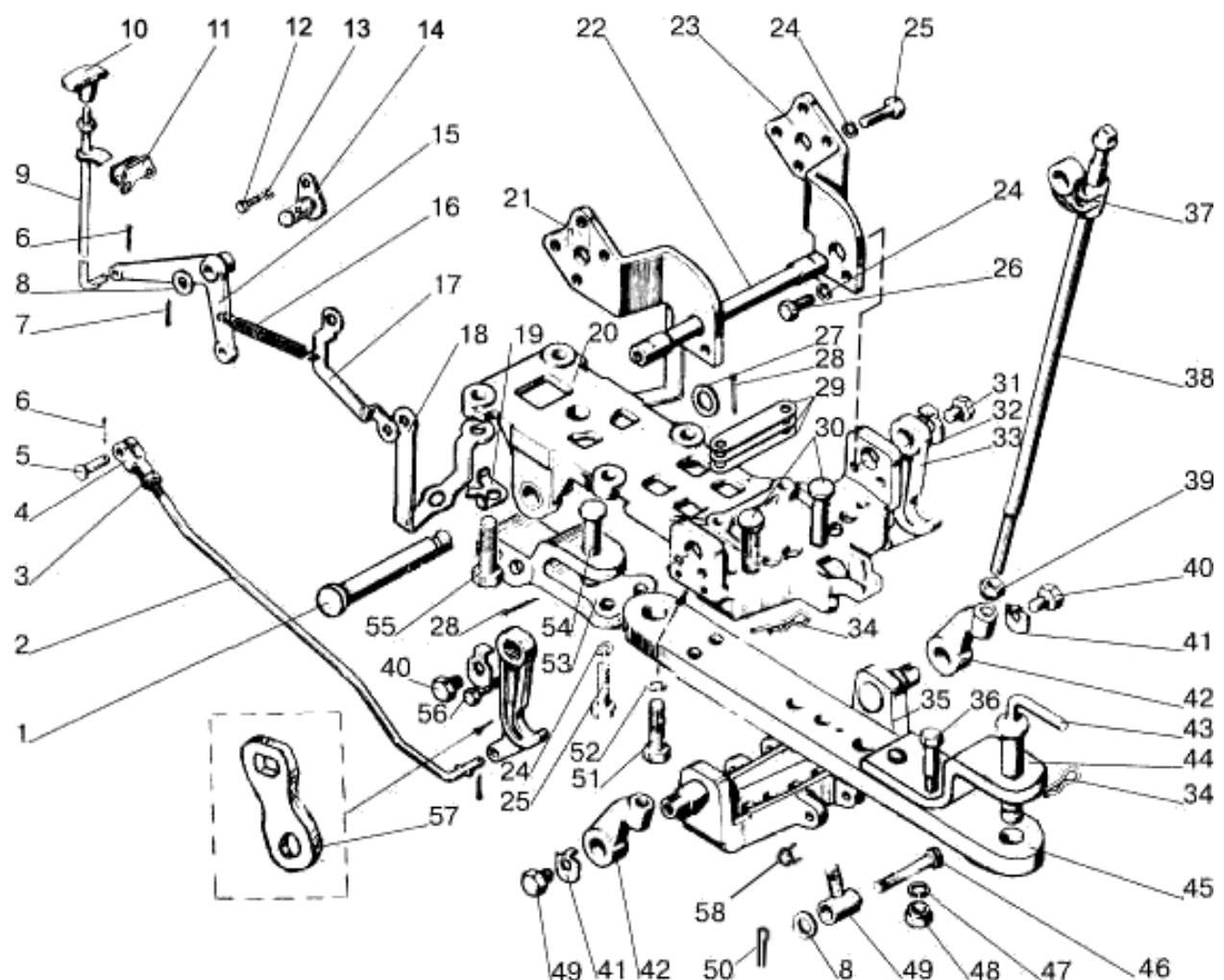
Рис. 27.2. Устройство прицепное. Вариант «маятник» или «прицеп» (по заказу).
