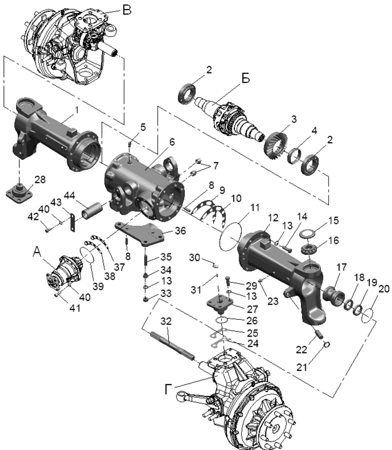
Рис. 23.2. Передний ведущий мост в сборе (для тракторов «БЕЛАРУС-820/82.3/82П»)
