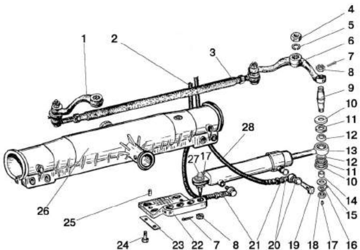
Рис. 34.3. Гидроцилиндр и арматура ГОРУ (вариант с передней осью)
