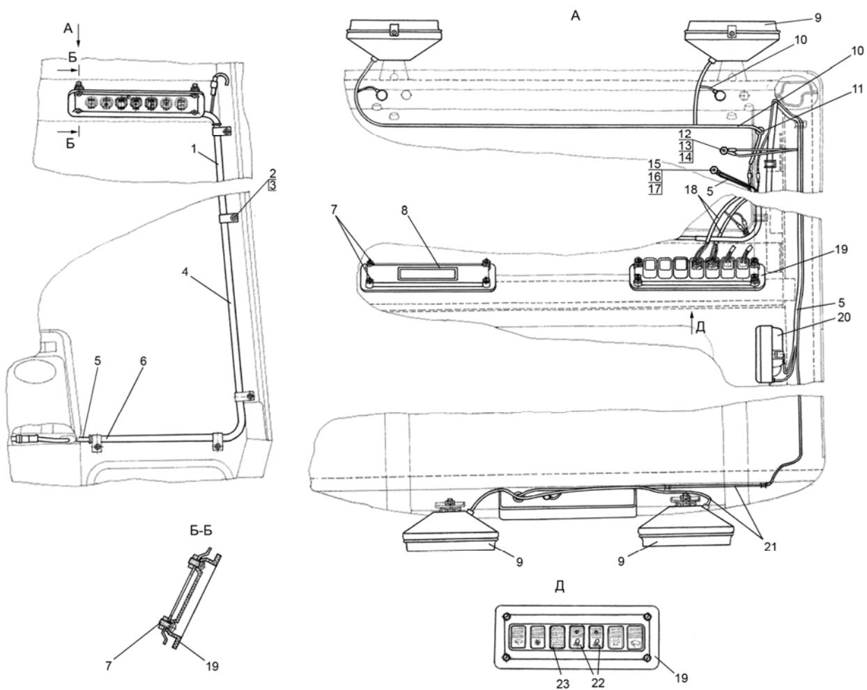
Рис. 37.14. Установка фар рабочих (для трактора «БЕЛАРУС-82П»)
