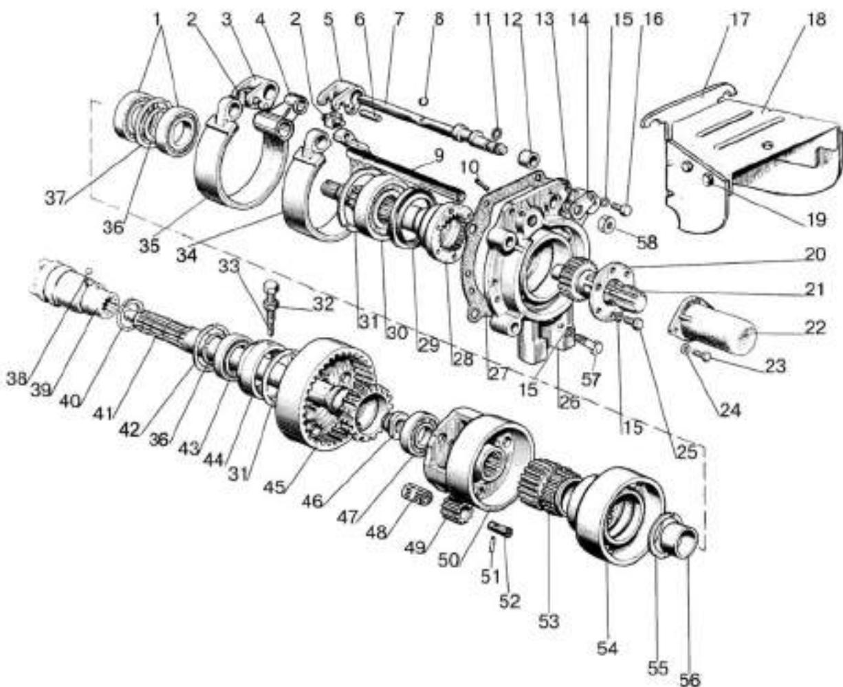
Рис. 42.1. Вал отбора мощности задний
