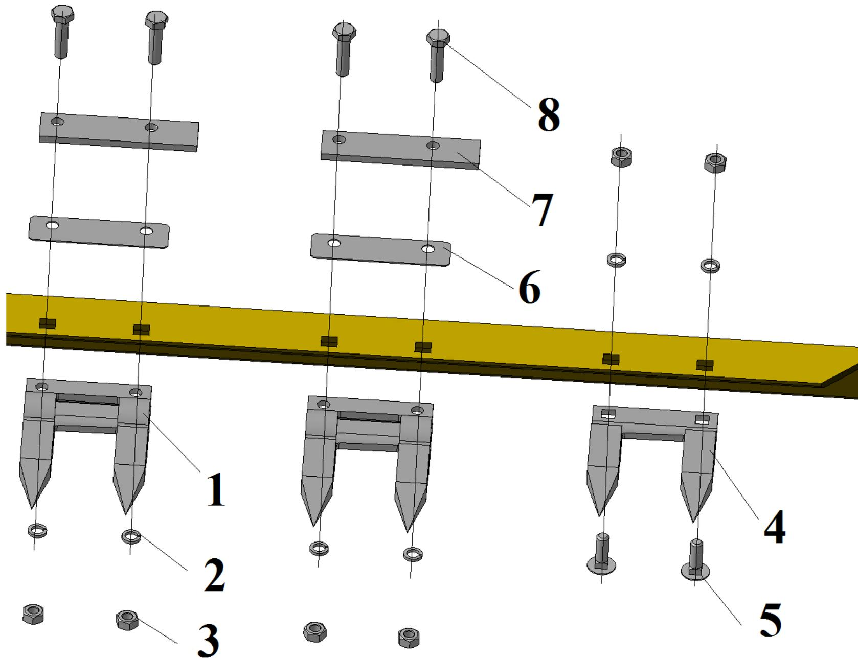
Рис. 14 Установка пальцев с приводом режущего аппарата Шумахер на брусе жатки
