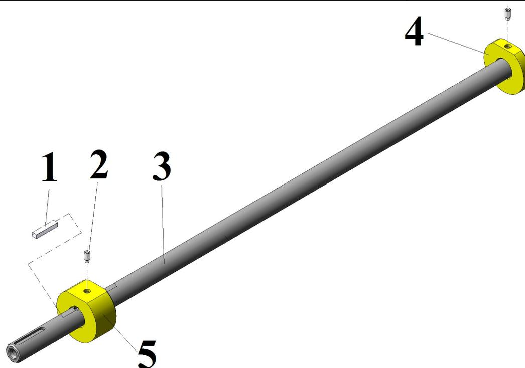
Рис. 20 Цапфа приводная ЖНС-6.04.200
