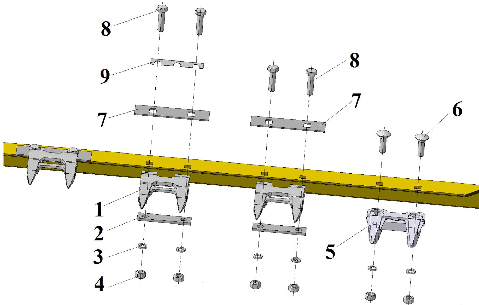
Рис.11 Установка штампованных пальцев с приводом режущего аппарата МПН 85.20ПБ
