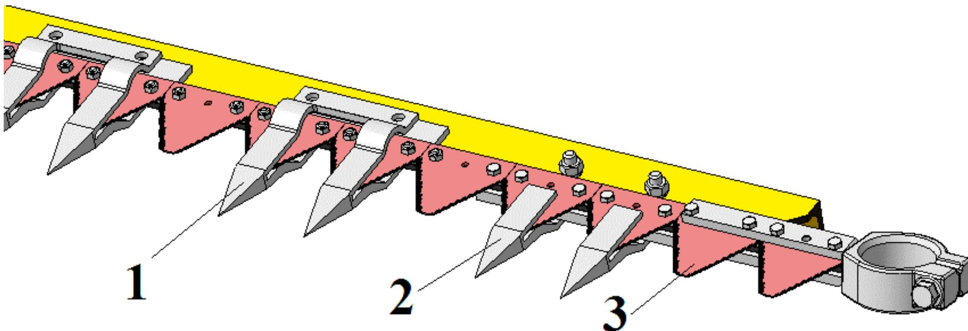
Рис.12 Расположение пальцев с приводом режущего аппарата Шумахер на брусе жатки
