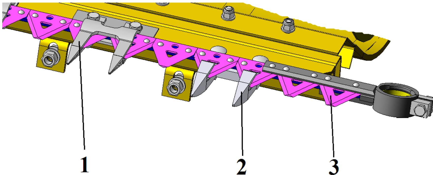
Рис. 9 Расположение штамповарных пальцев с приводом режущего аппарата МПН 85.20ПБ на бруске жатки.
