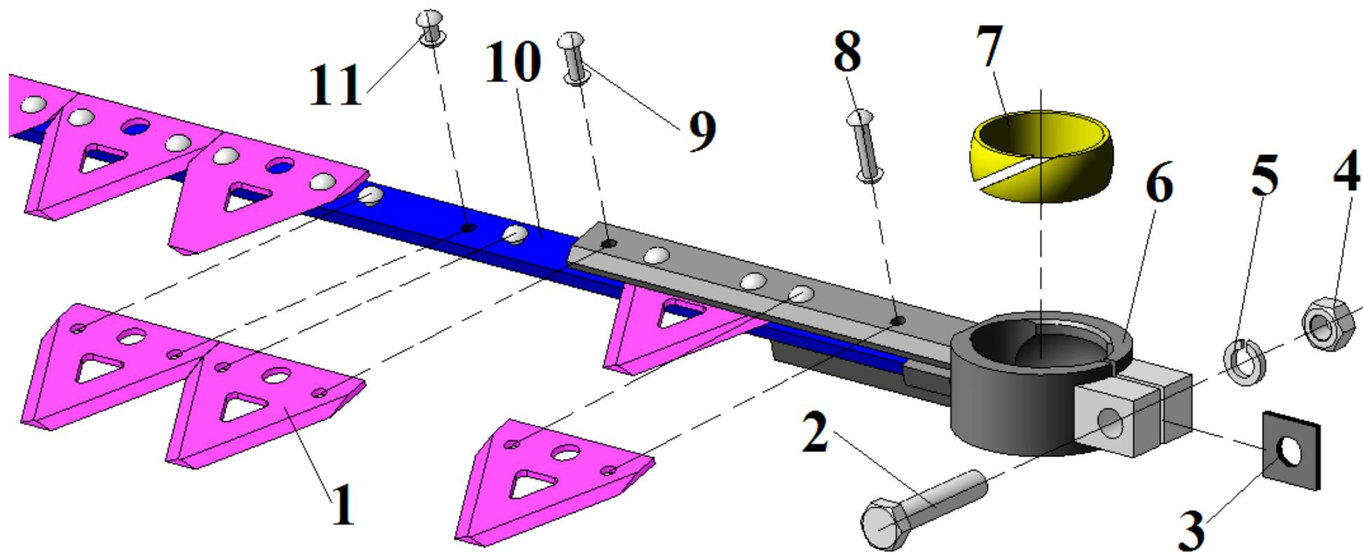
Рис. 10 Нож ЖНС-6.01.080Б / ЖНС-7,4.01.080Б-02 / ЖНС-9,1.01.080А
