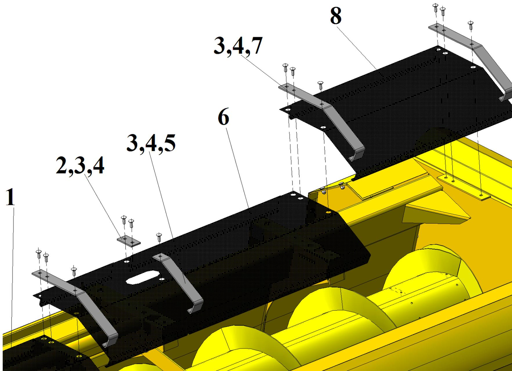
Рис. 24 Установка козырьков на жатке. Левая сторона.
