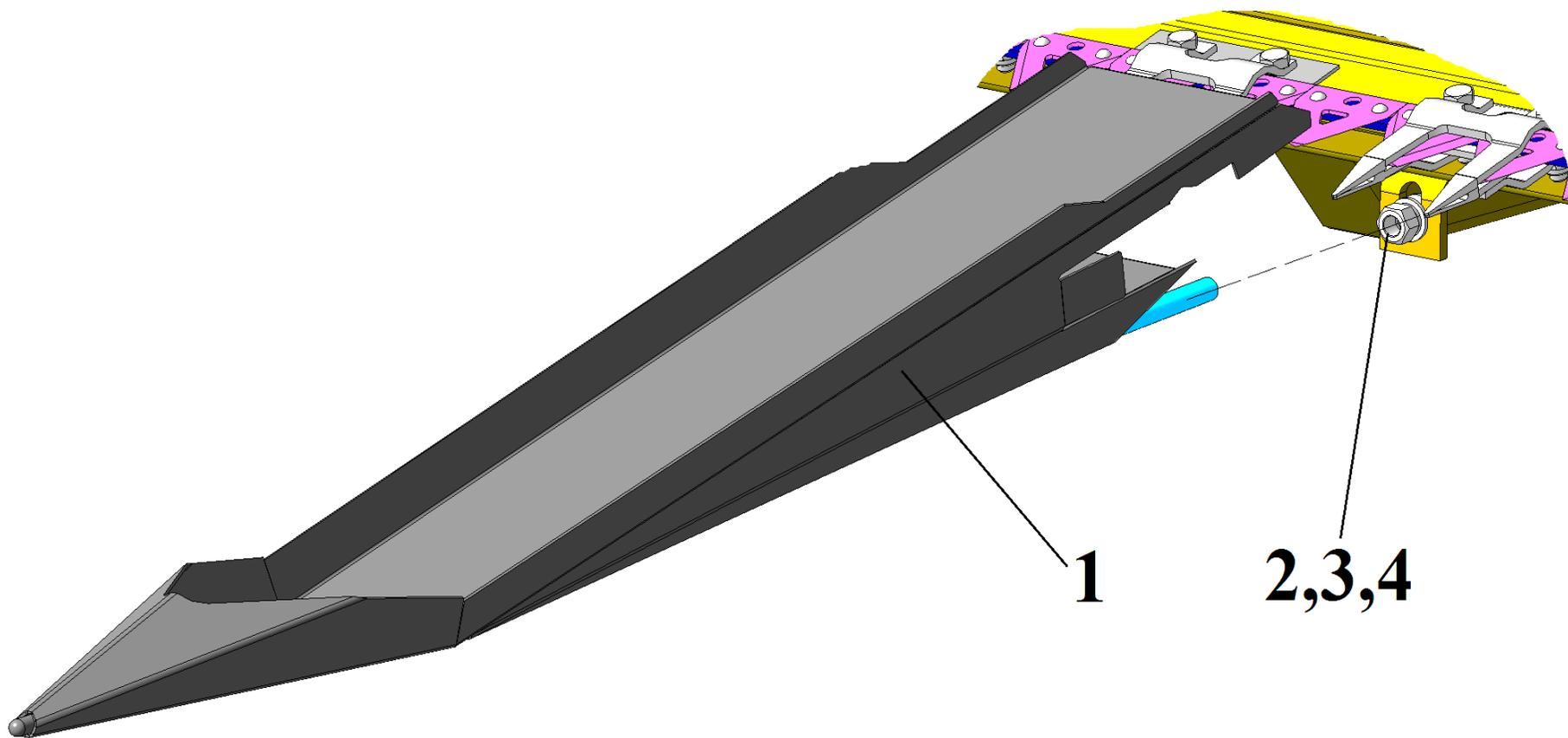
Рис.15 Установка лифтеров
