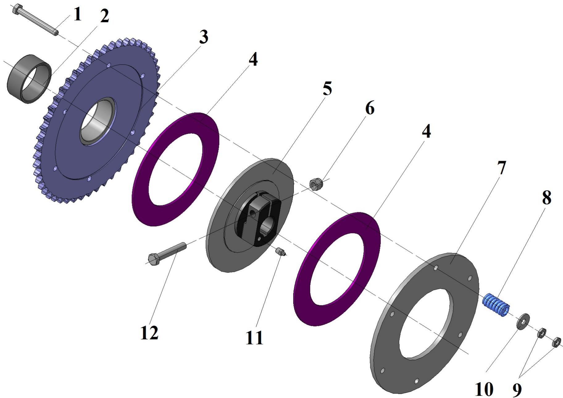
Рис.6 Устройство предохранительное ЖЗЛ 02.550
